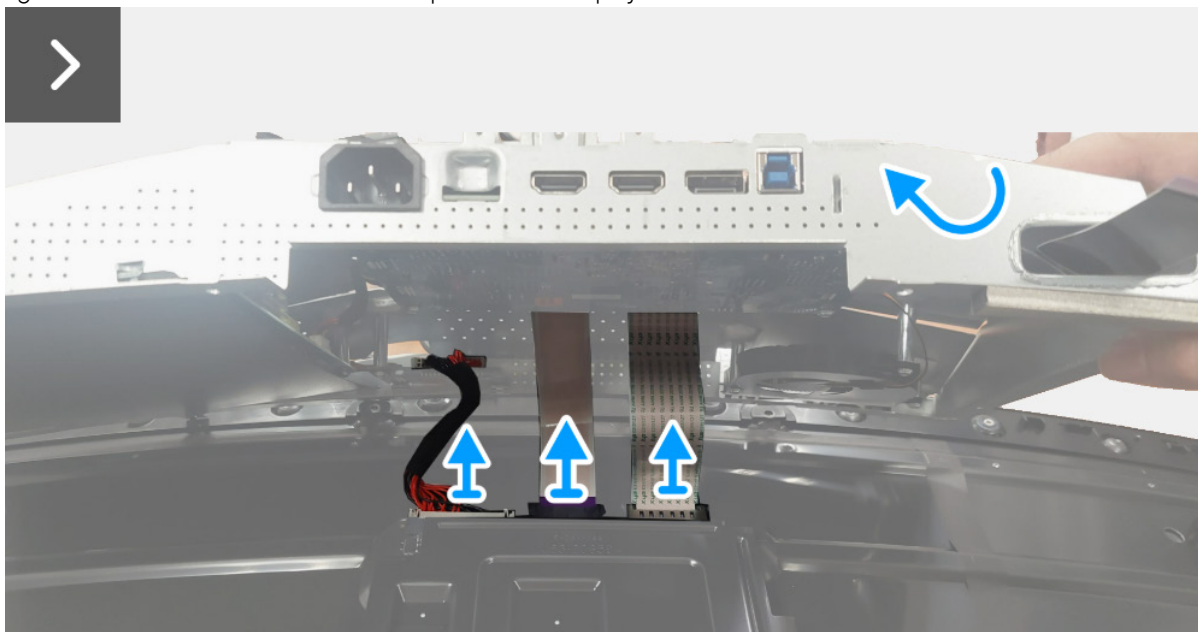
Immagine 21. Rimozione della protezione in metallo
