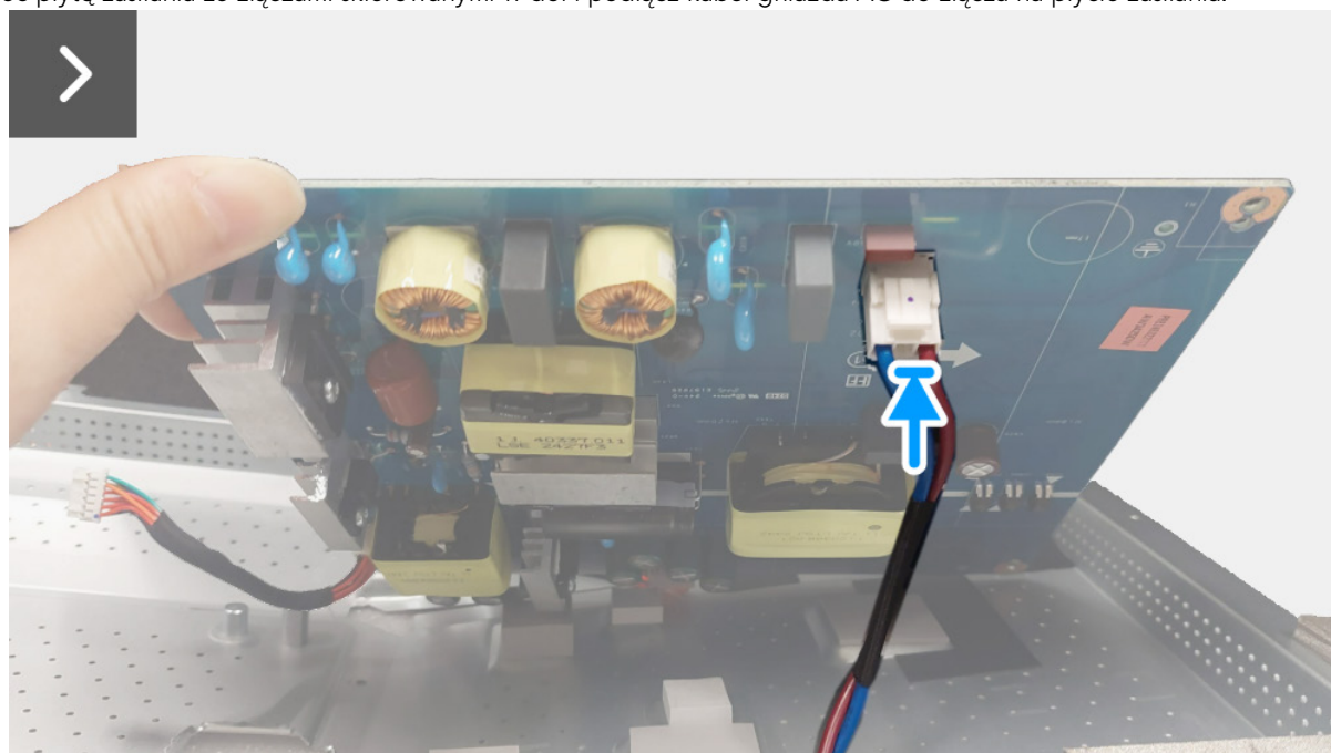
Rysunek 33. Montaż płyty zasilania
