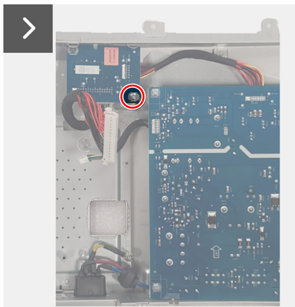
Rysunek 25. Demontaż płyty DC-DC
