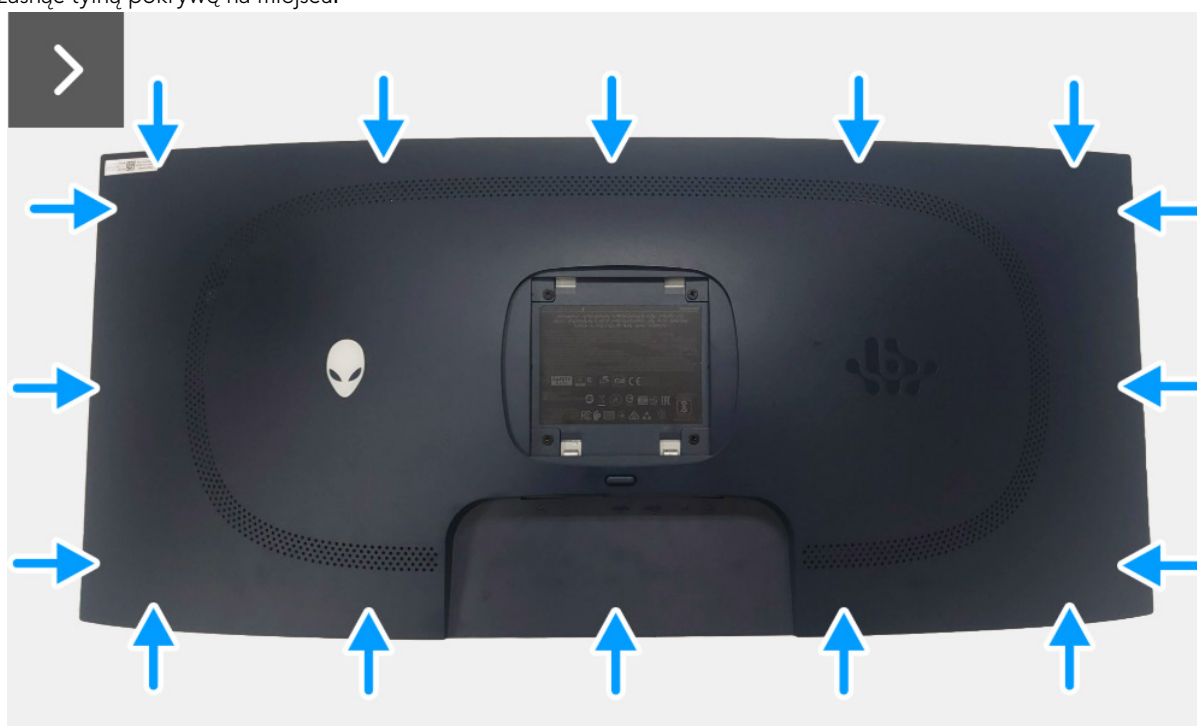
Rysunek 8. Montaż tylnej pokrywki
