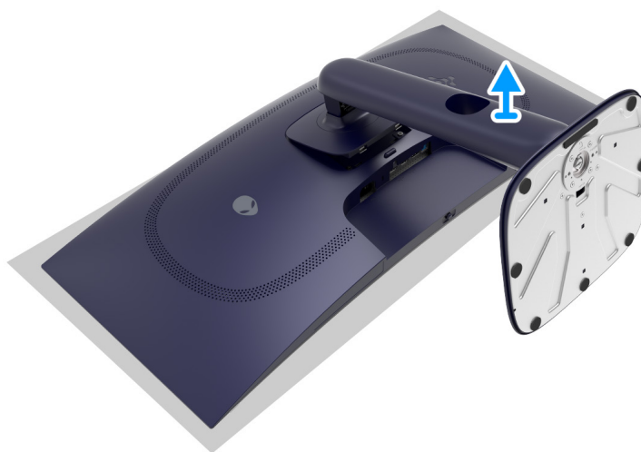
Rysunek 2. Demontaż stojaka
