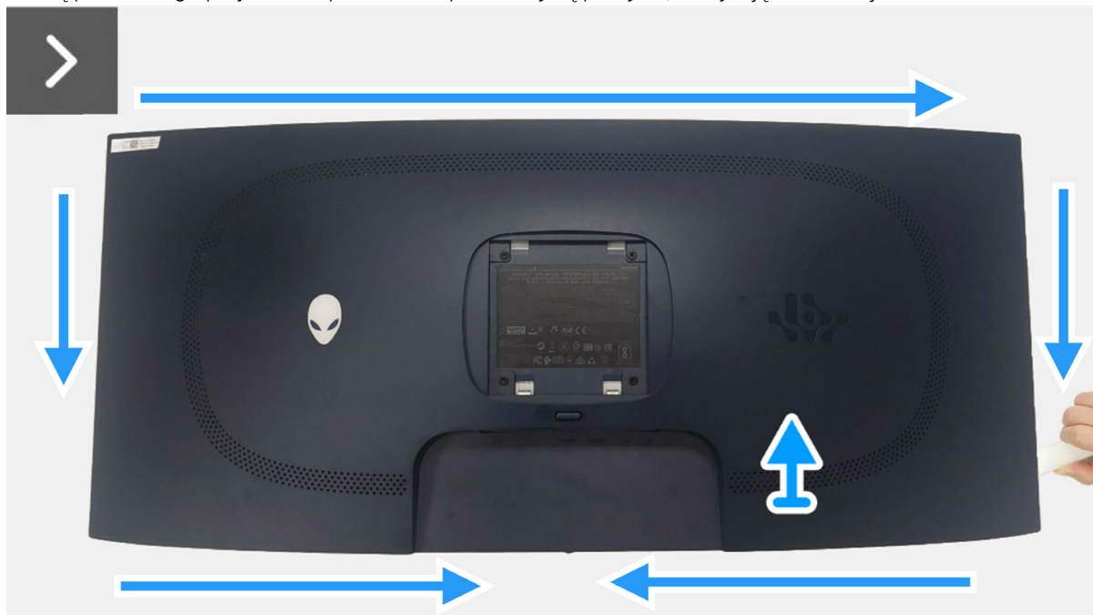
Rysunek 5. Demontaż tylnej pokrywy
