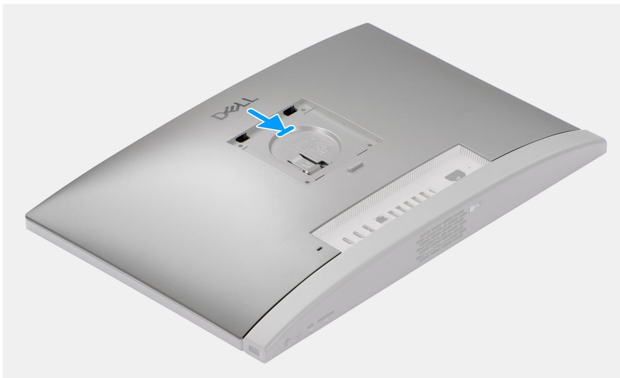
**Figure 20. Installation du capot arrière**
