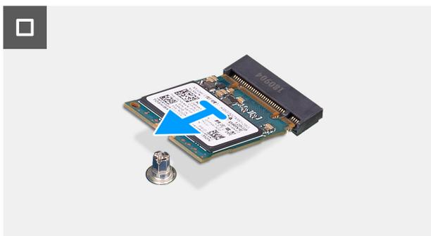
Figure 36. Retrait du disque SSD M.2 2230 du logement M.2 1
