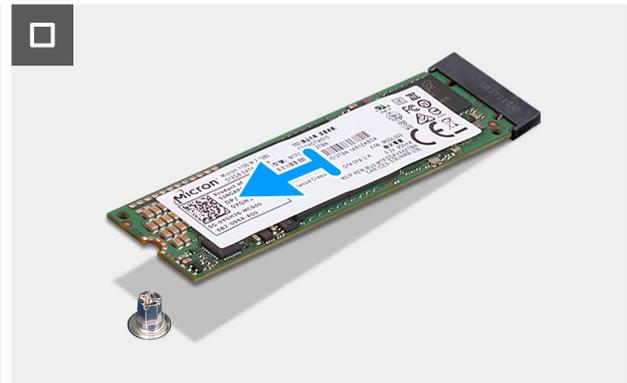
Figure 38. Retrait du disque SSD M.2 2280 du logement M.2 1
