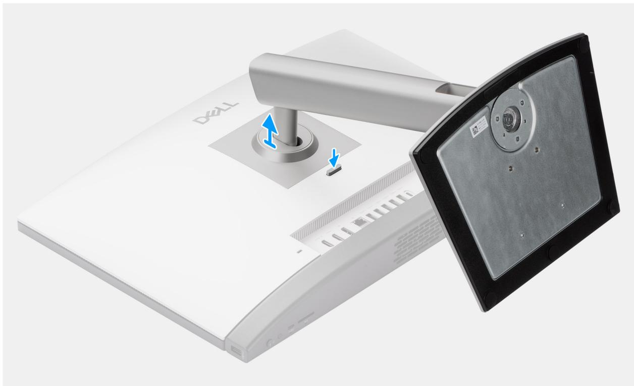
Figure 15. Retrait du socle ajustable en hauteur (HAS)
