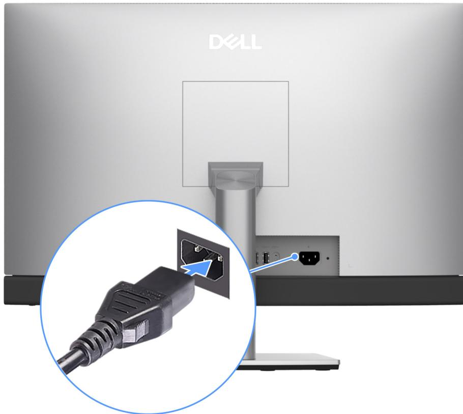
**Figure 12. Branchement du câble d'alimentation**
