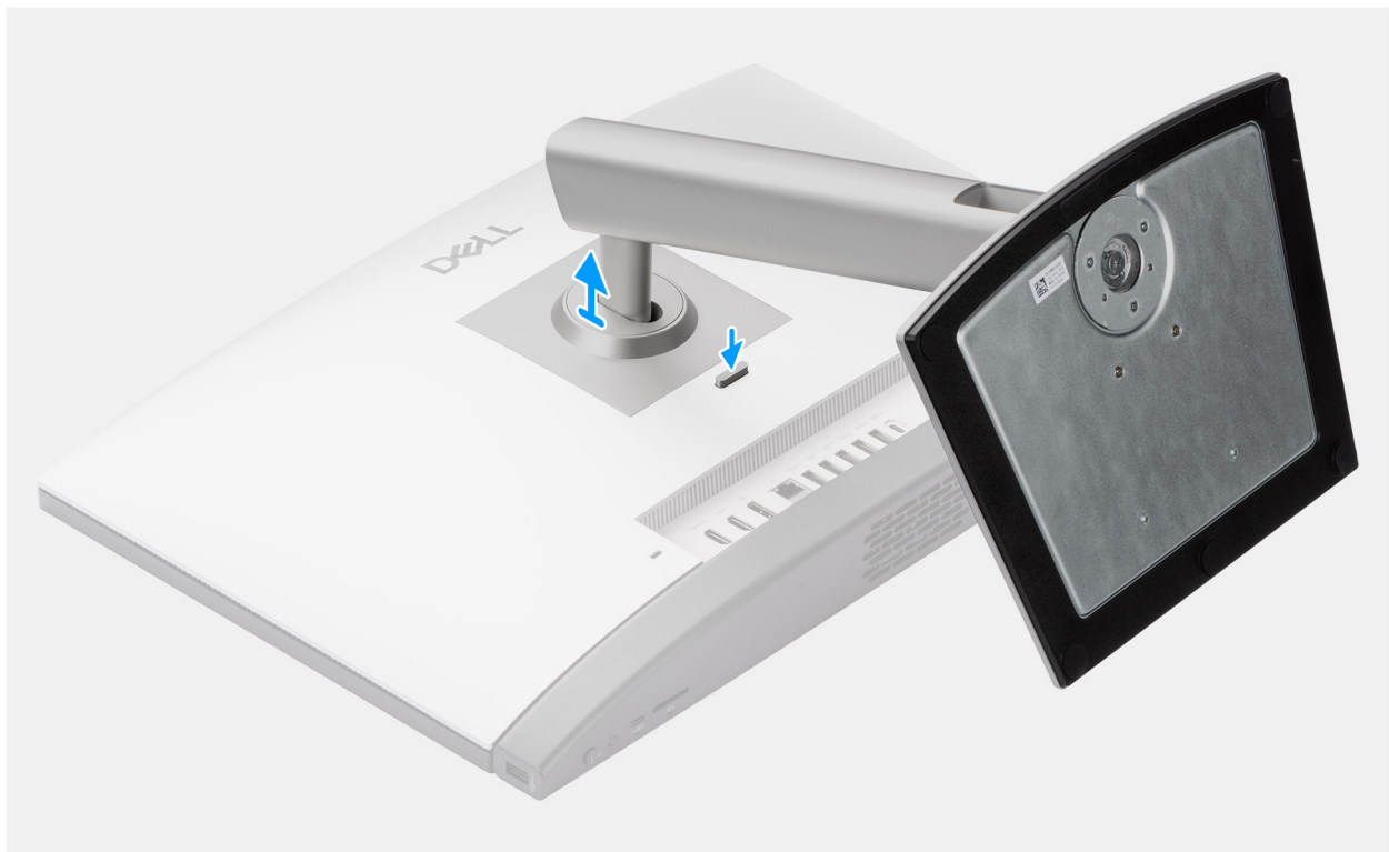
Figure 15. Retrait du socle ajustable en hauteur (HAS)
