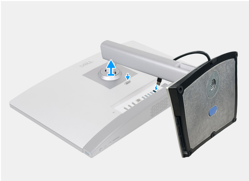
Figure 16. Retrait du socle réglable en hauteur (HAS) avec un lecteur optique
