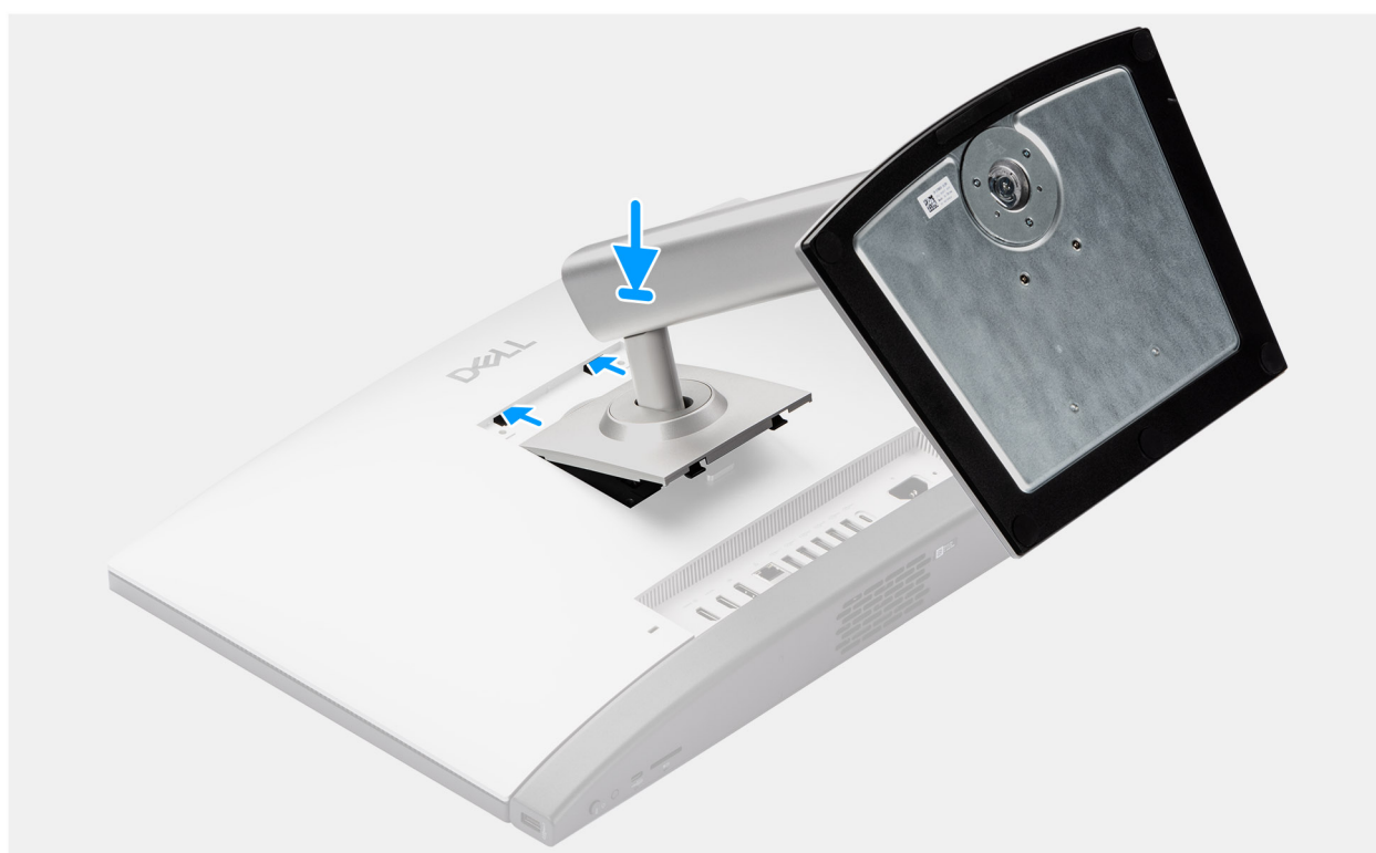
Figure 18. Installation du socle ajustable en hauteur (HAS)
