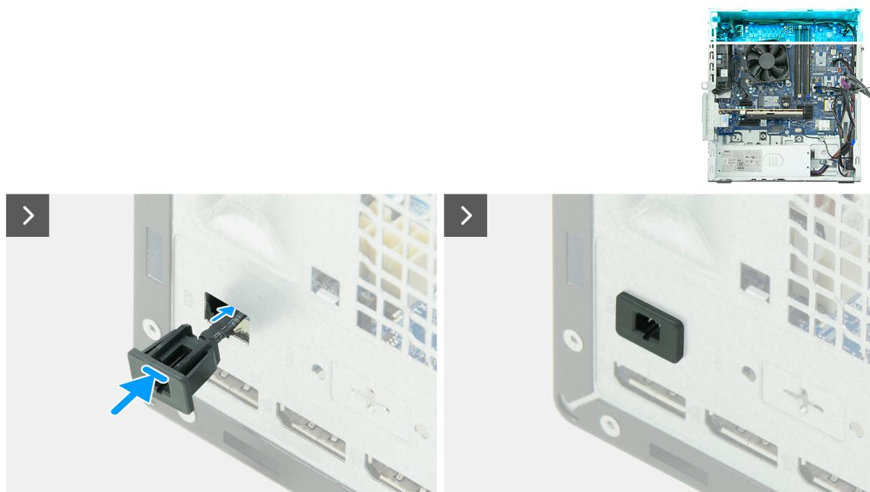
Figure 69. Installation du câble du commutateur d'alimentation à distance
