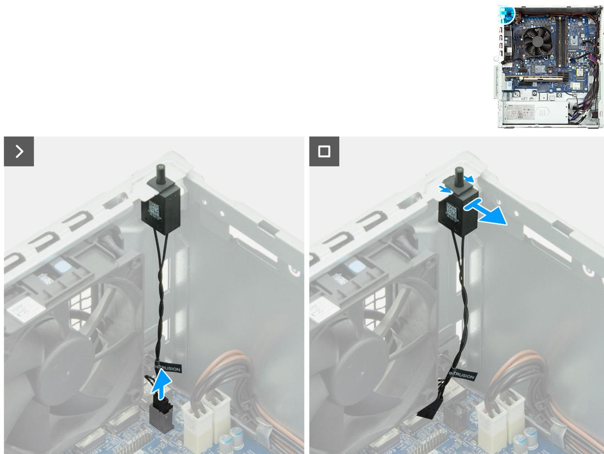
Figure 63. Retrait du commutateur d'intrusion
