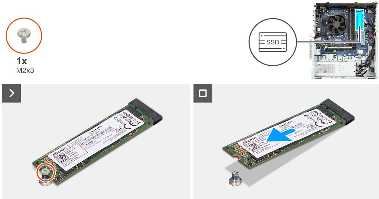
Figure 37. Retrait du disque SSD M.2 2280 du logement 2
