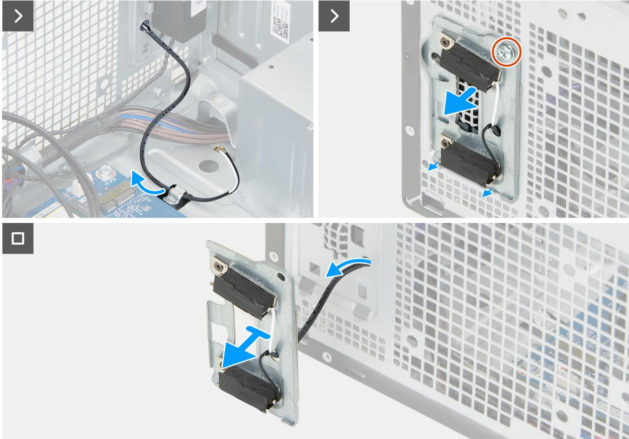
Figure 84. Retrait des modules d'antenne
