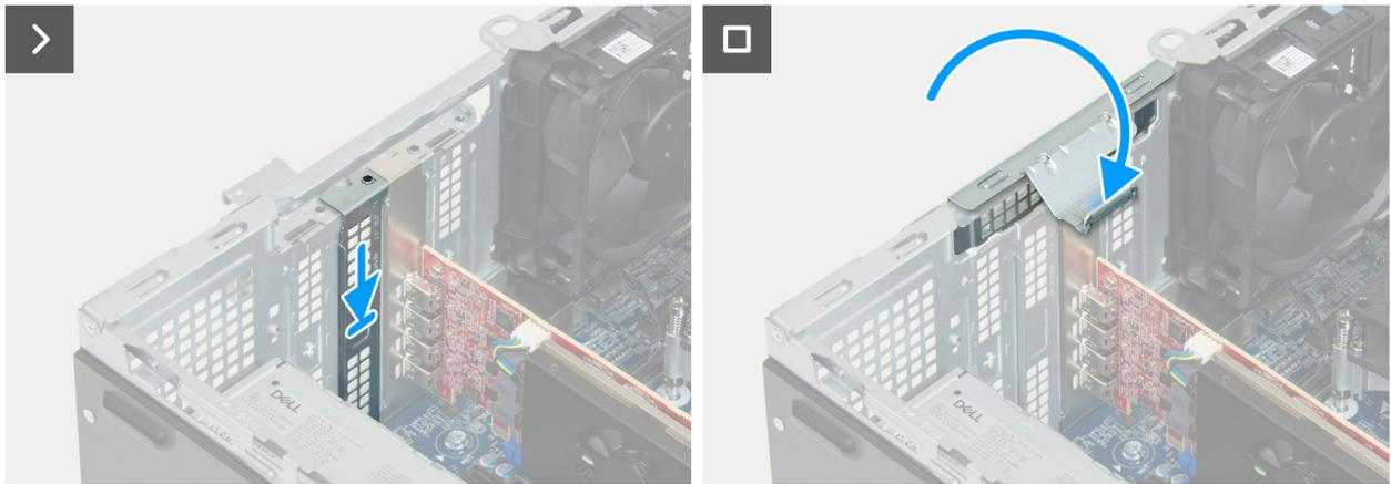
**Figure 46. Retrait de la carte d'extension de disque SSD**
