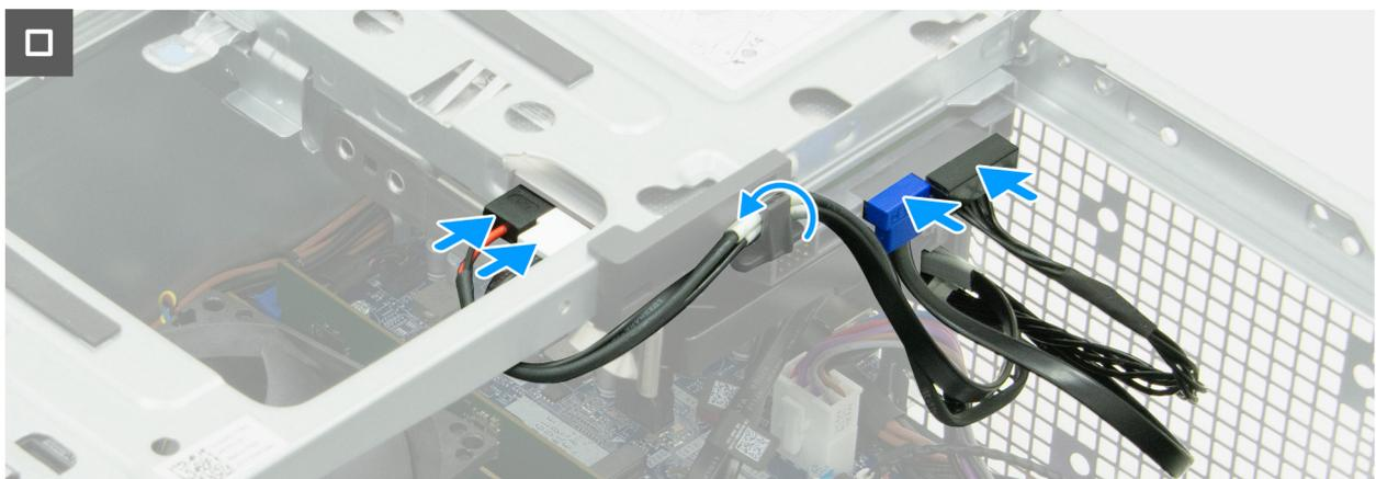
Figure 60. Installation de la baie de disques
