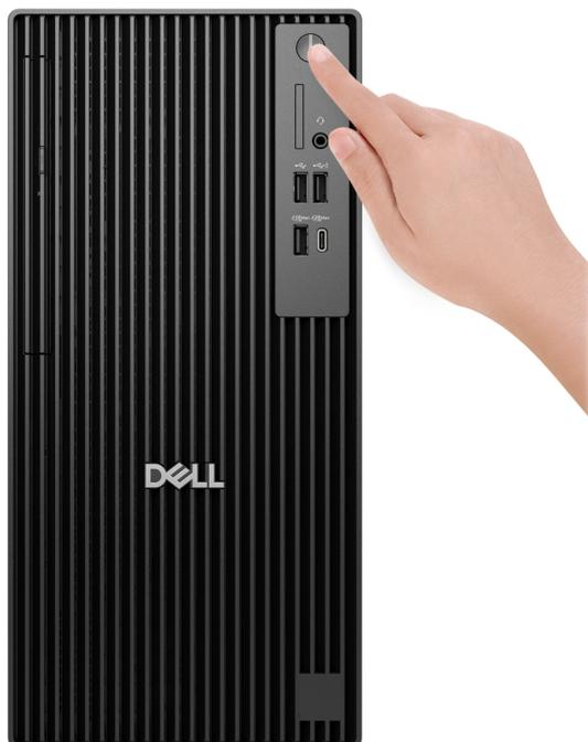
Figure 8. Appui sur le bouton d'alimentation
