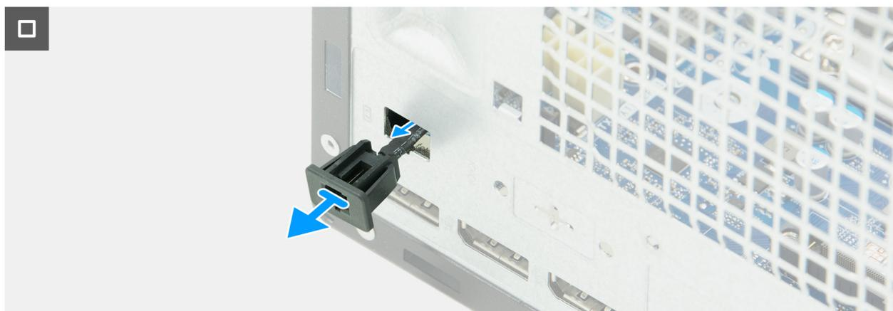
Figure 68. Retrait du câble du commutateur d'alimentation à distance
