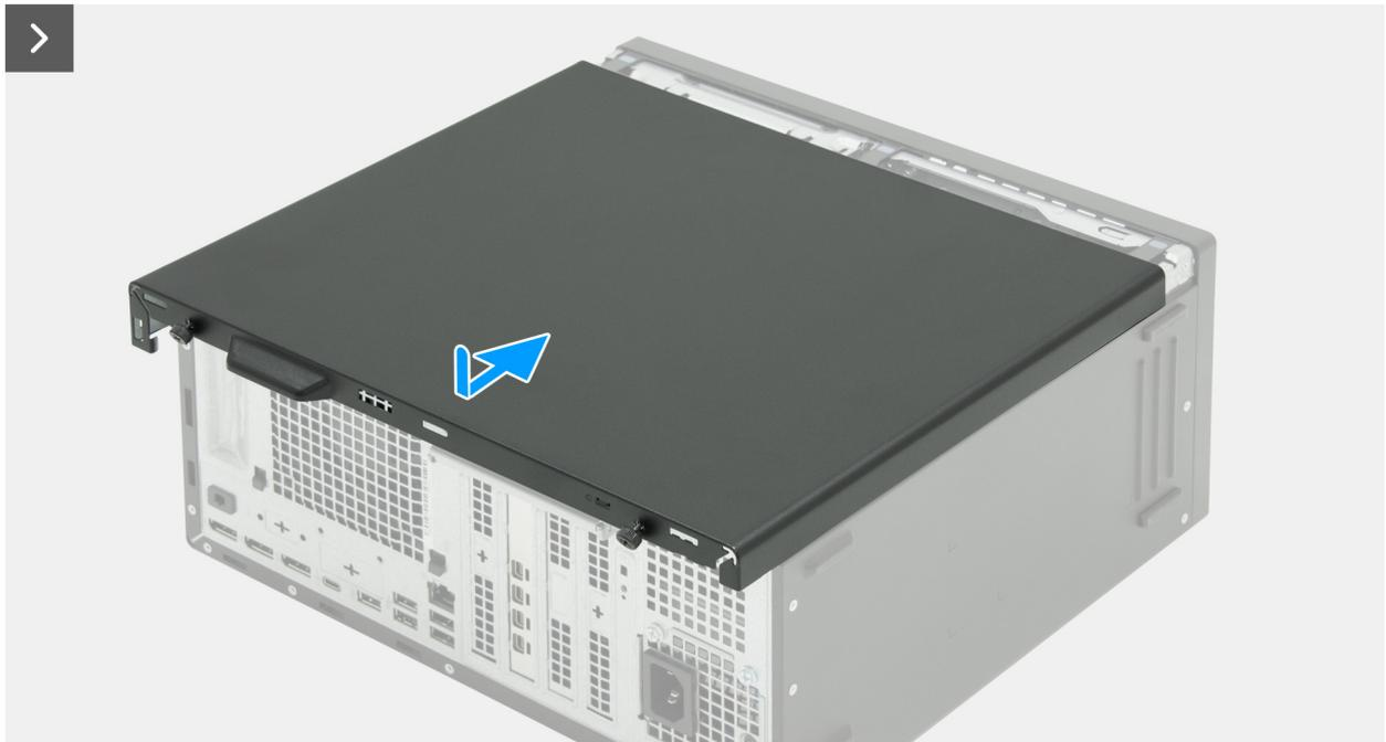
Figure 14. Installation du panneau latéral gauche
