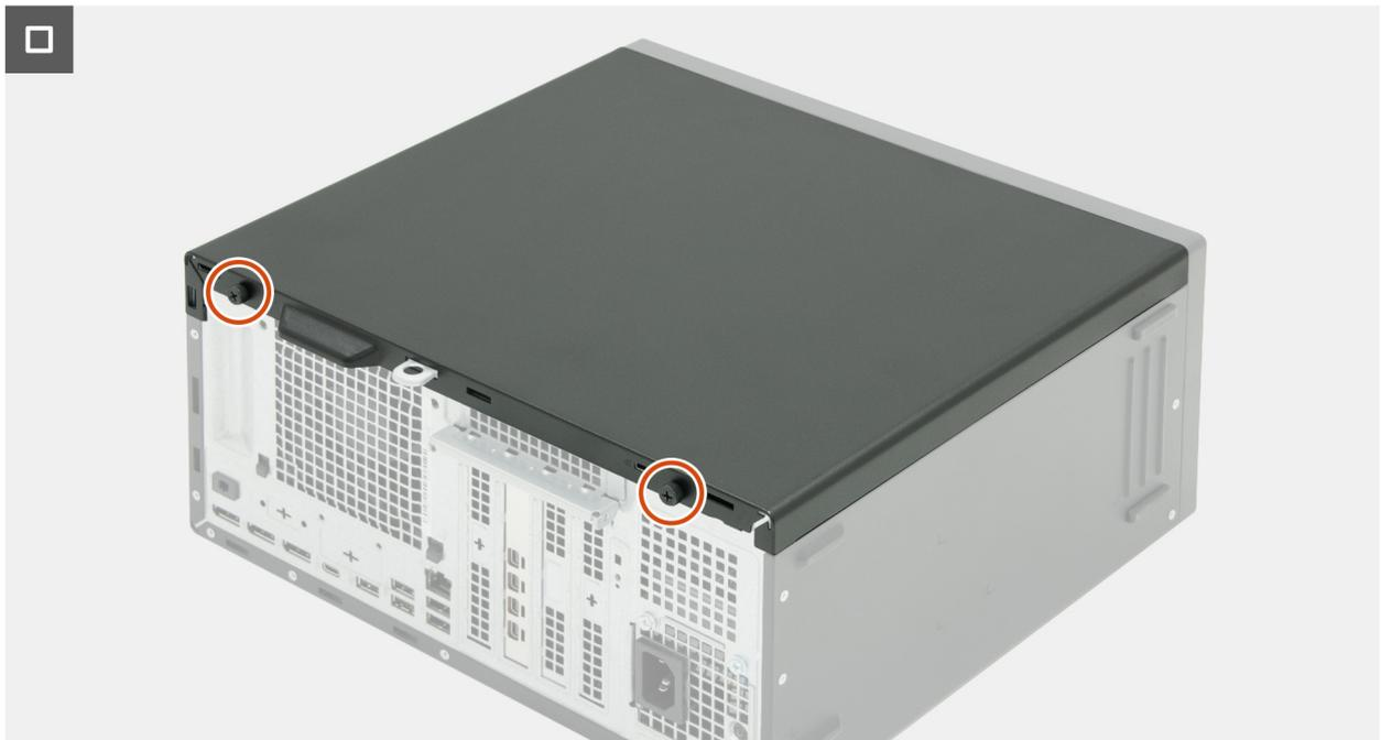
Figure 15. Installation du panneau latéral gauche
