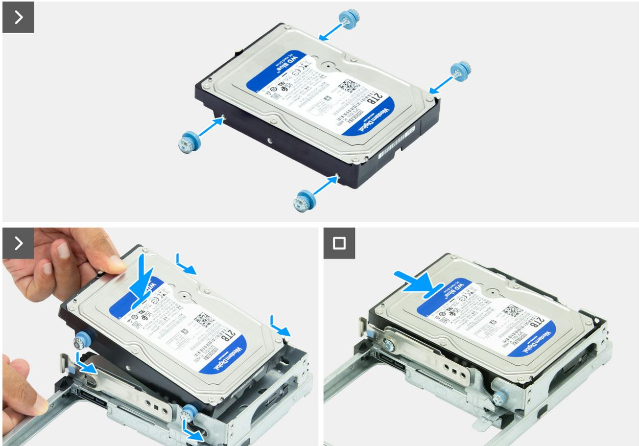
Figure 62. Installation du disque dur
