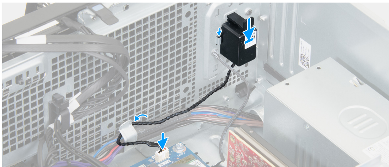
Abbildung 25. Einbauen des internen Lautsprechers
