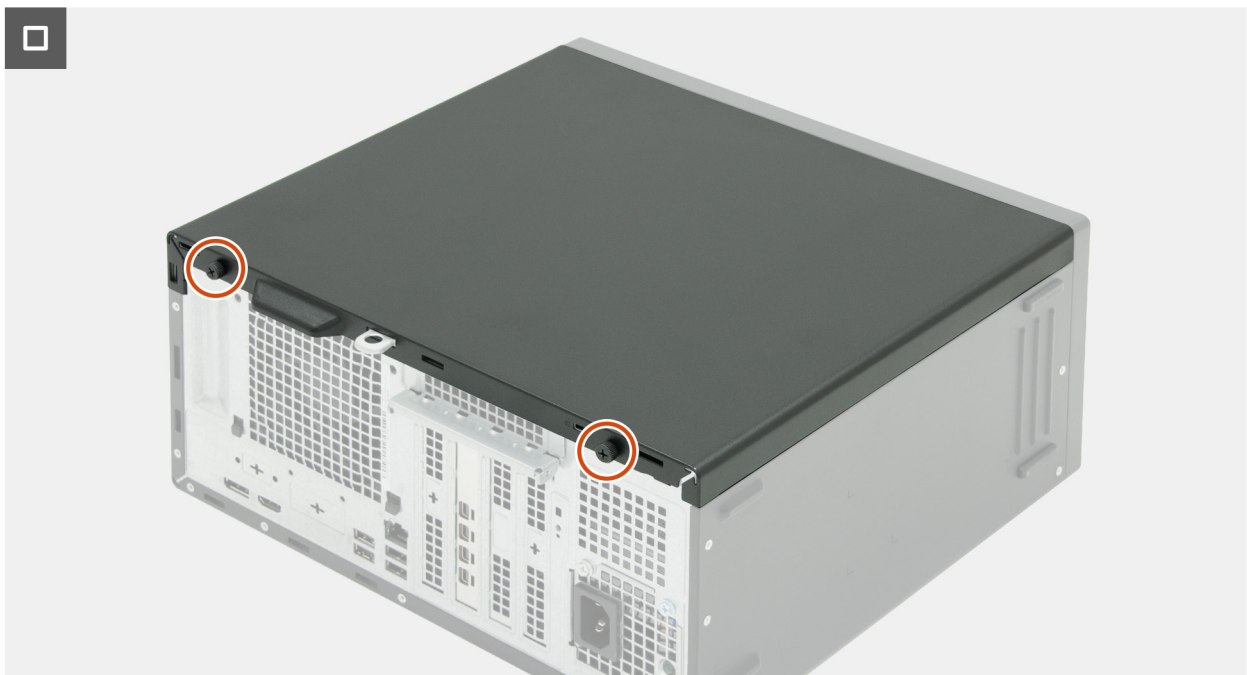
Abbildung 15. Installieren der linken Abdeckung
