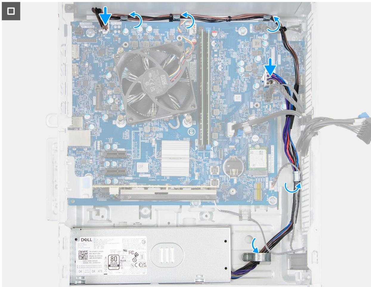
**Figure 64. Installation du bloc d'alimentation**
