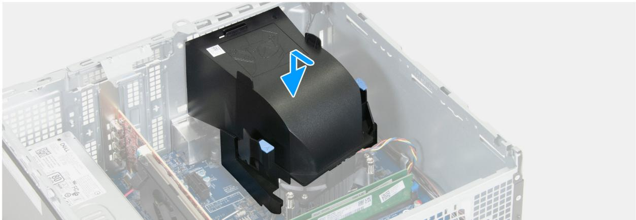
Figure 52. Image : installation du carénage du ventilateur
