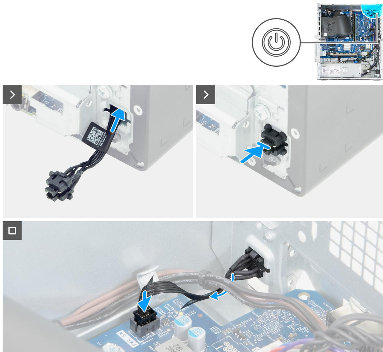
**Figure 50. Installation du bouton d'alimentation**
