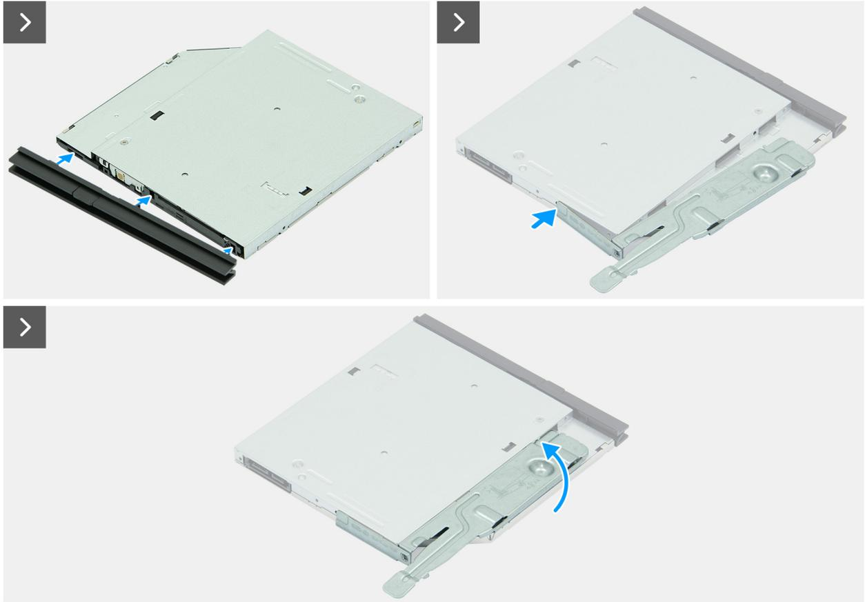
**Ilustración 39. Instalación de la unidad óptica**
