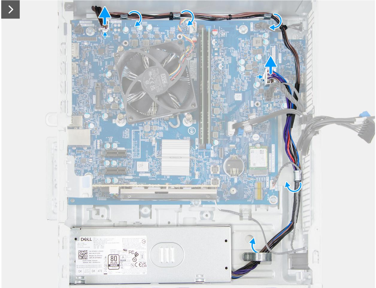
**Ilustración 61. Extracción de la fuente de alimentación**
