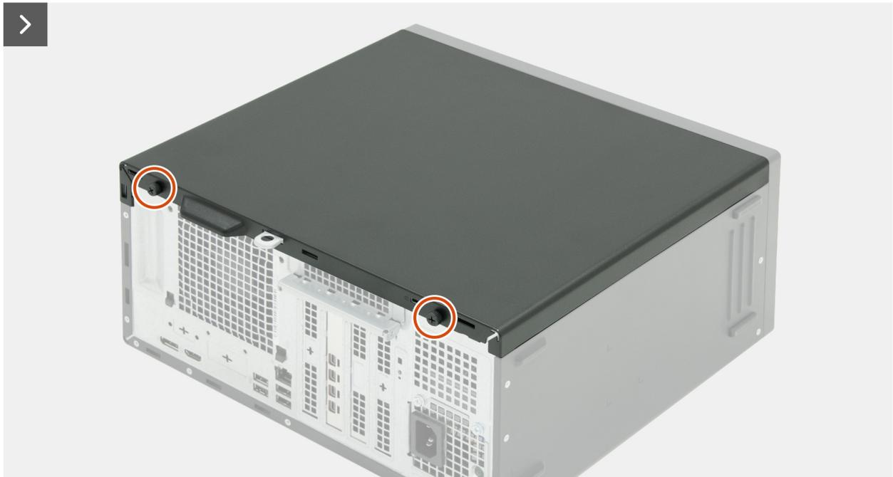
Ilustración 12. Extracción de la cubierta lateral izquierda
