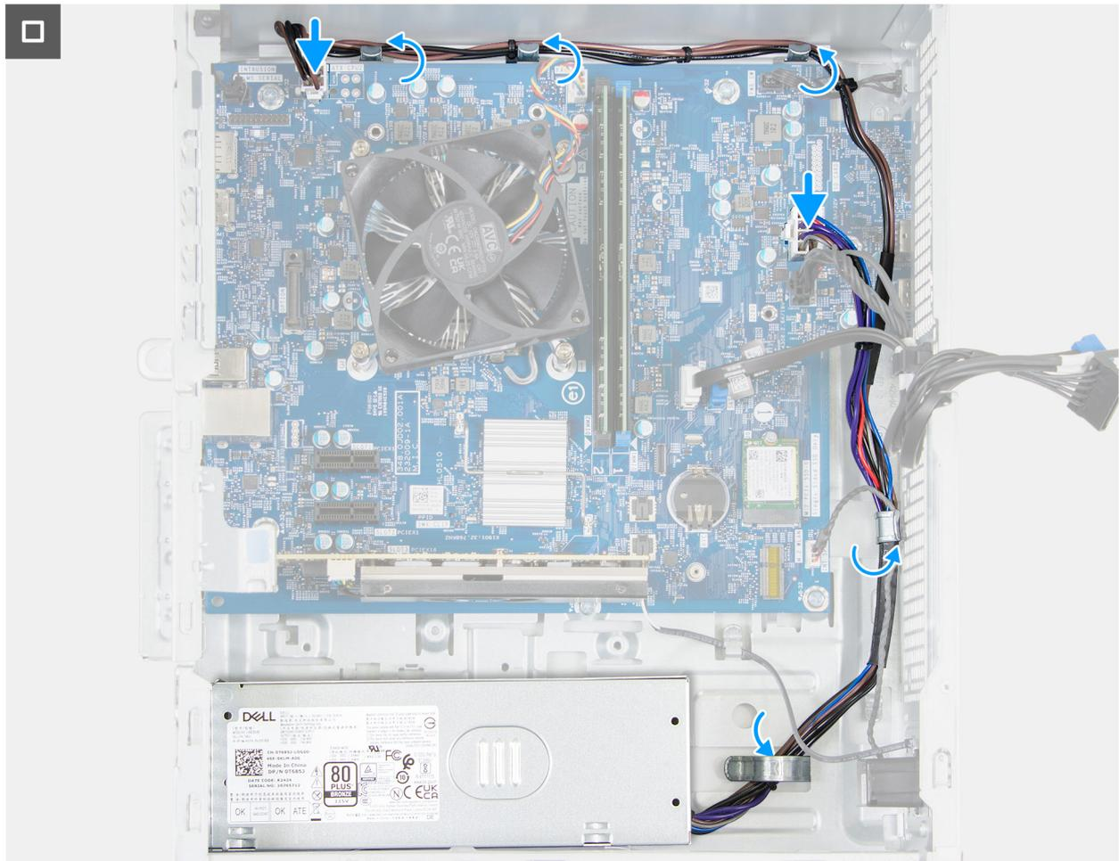
**Ilustración 64. Instalación de la fuente de alimentación**
