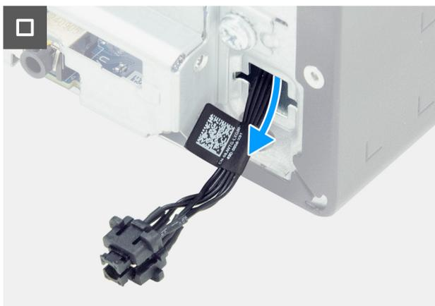
**Ilustración 49. Extracción del botón de encendido**
