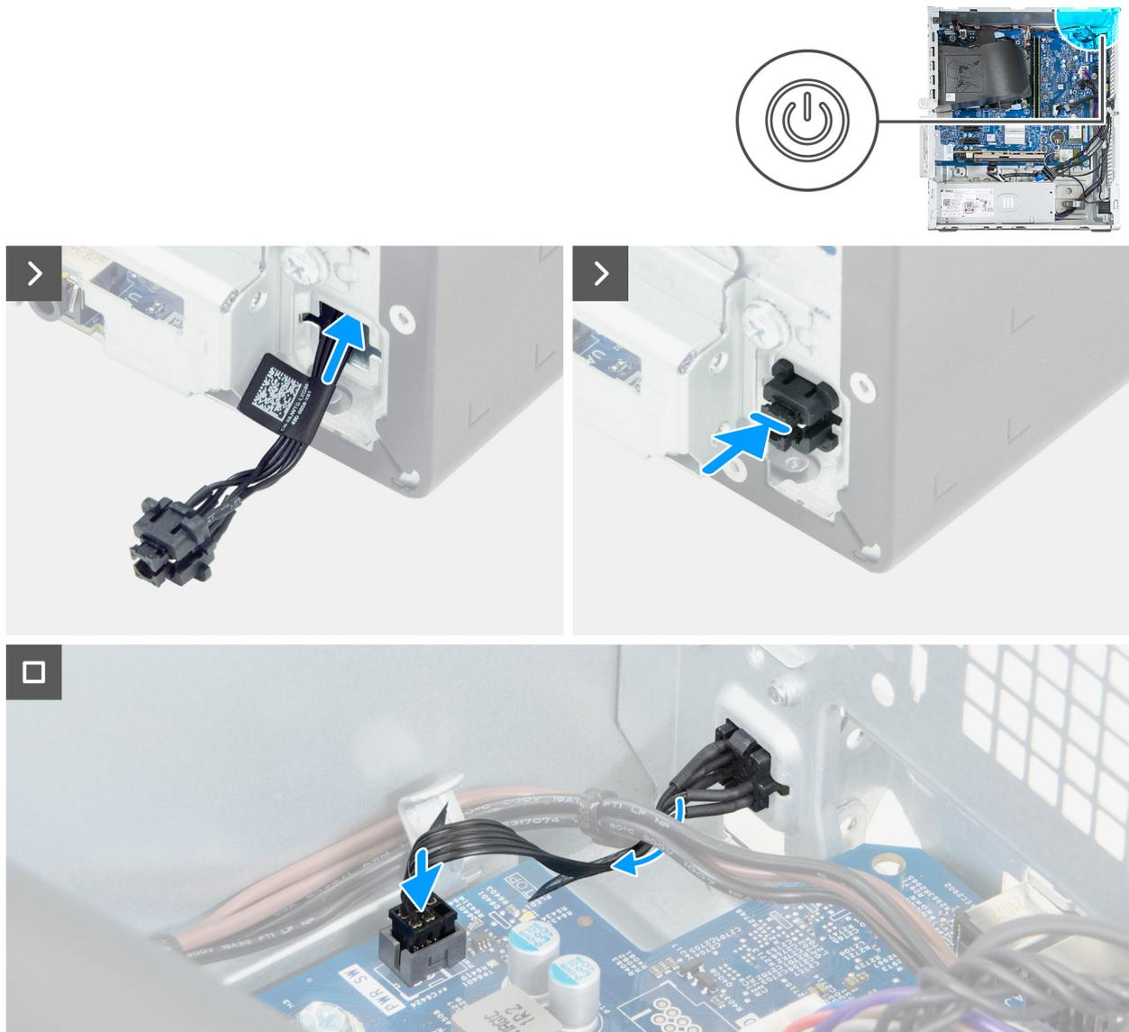
**Ilustración 50. Instalación del botón de encendido**
