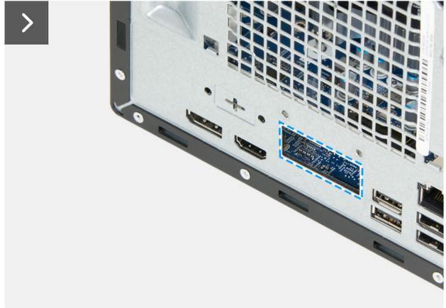
Ilustración 54. Instalación del módulo de puerto opcional
