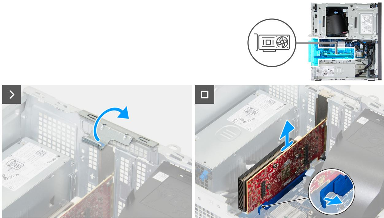
**Ilustración 33. Extracción de la tarjeta gráfica**
