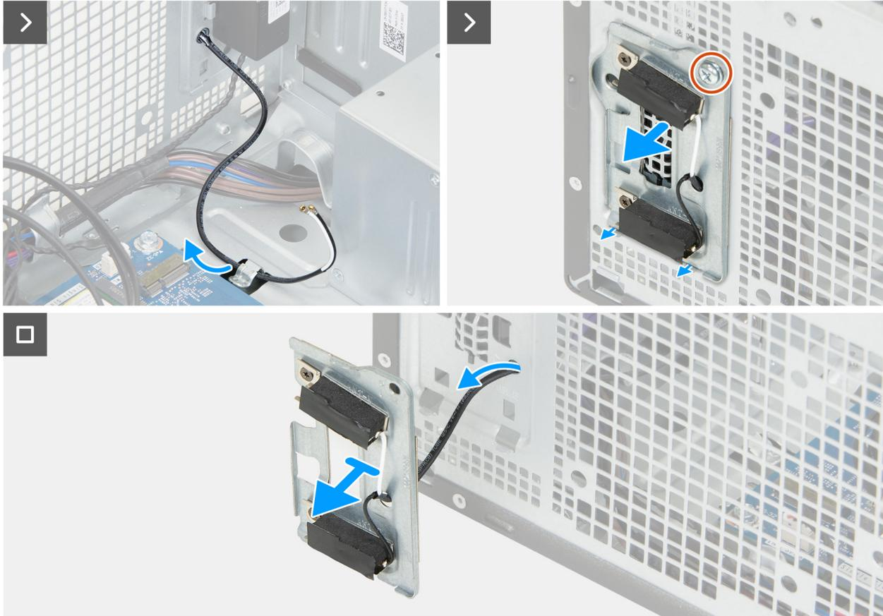
**Ilustración 59. Extracción de los módulos de la antena**
