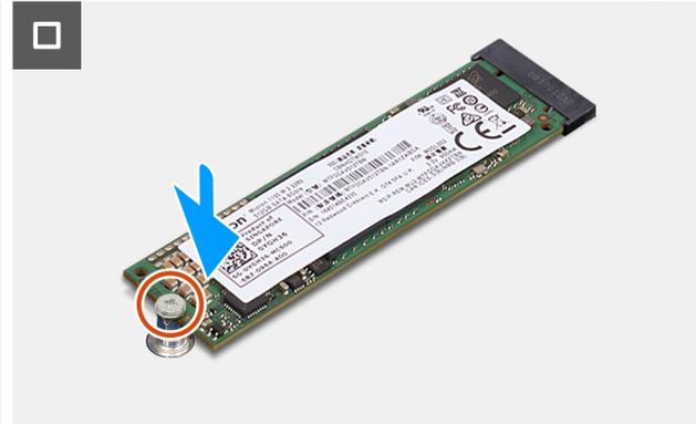
**Ilustración 31. Instalación de la unidad de estado sólido M.2 2280**
