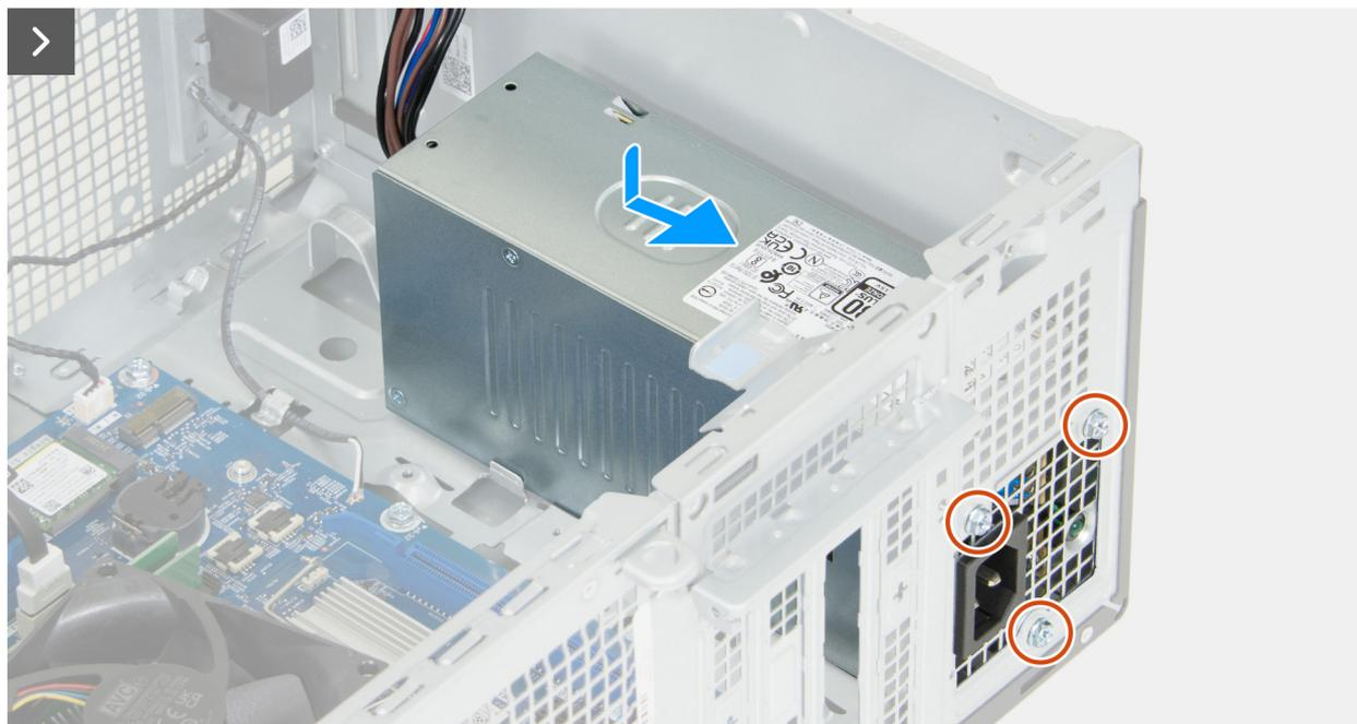
**Figura63. Instalar a unidade de fonte de alimentação**
