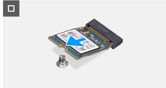
Figura28. Retirar o disco de estado sólido M.2 2230
