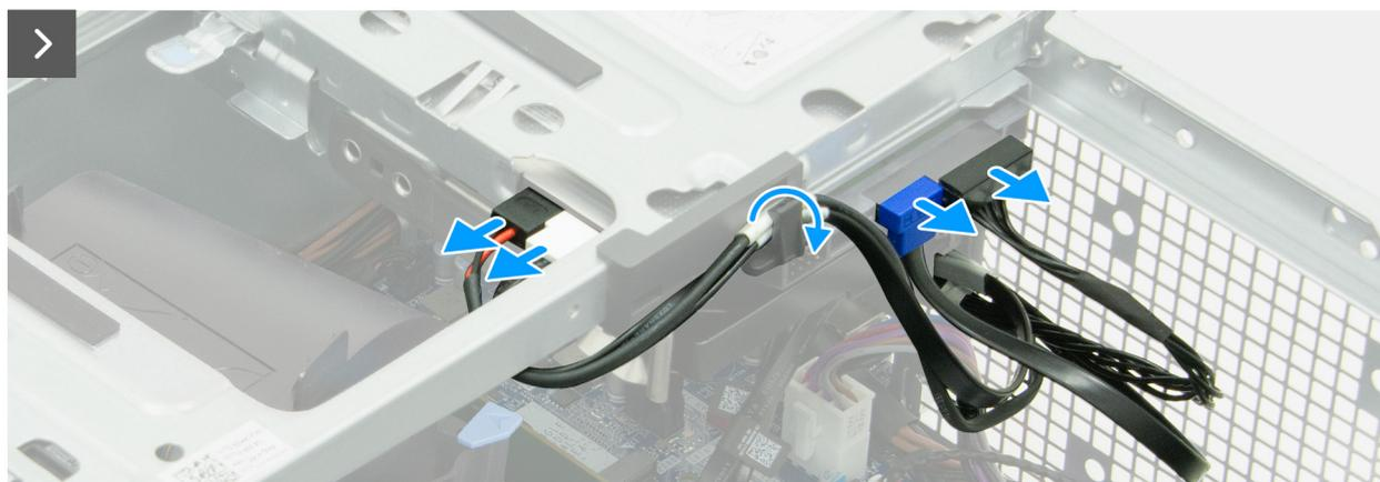
Figura41. Remover o compartimento da unidade
