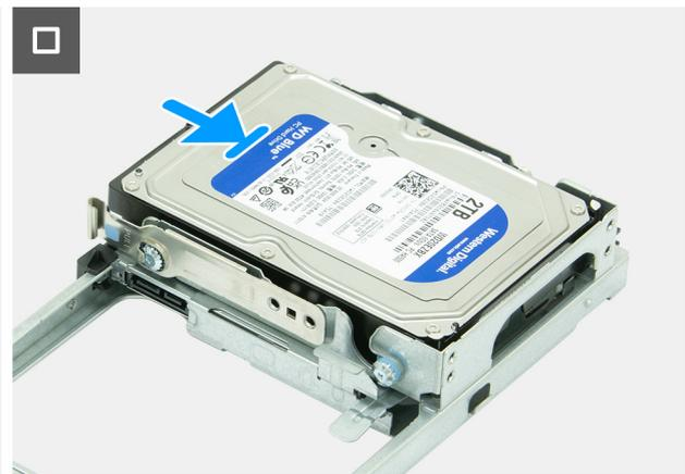
**Figura46. Instalar o disco rígido**
