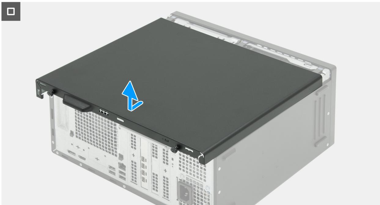
**Figura13. Retirar a tampa do lado esquerdo**
