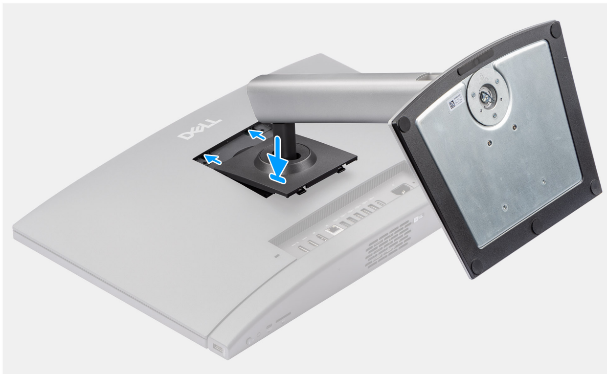
Figura 15. Installazione del supporto ad altezza regolabile (HAS)
