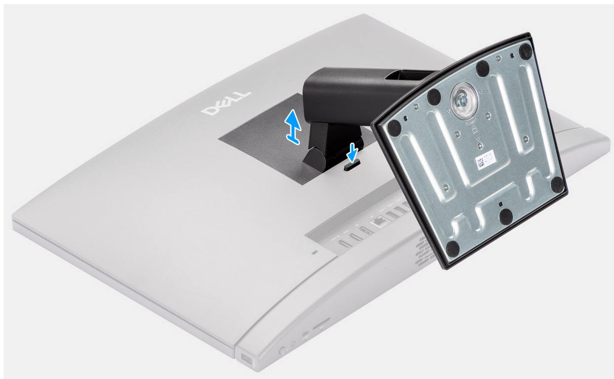
Figura 14. Rimozione del supporto fisso
