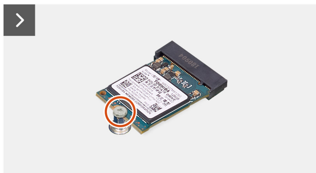
Figura 28. Rimozione dell'unità SSD M.2 2230 dallo slot M.2 1
