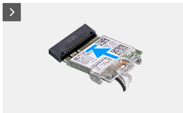
Figura 24. Installazione della scheda wireless
