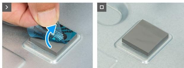
Figura 27. Rimozione della pellicola in plastica sul nuovo cuscinetto termico
