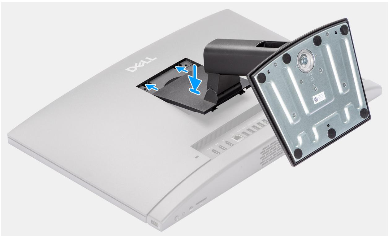
Figura 34. Installazione del supporto fisso
