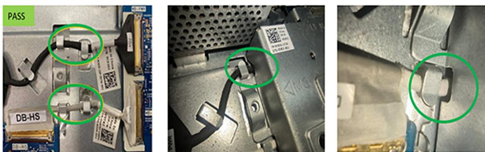
Figura 17. Instradamento corretto del cavo di alimentazione (MB-PWR) e del cavo ad alta velocità (MB-HS)
