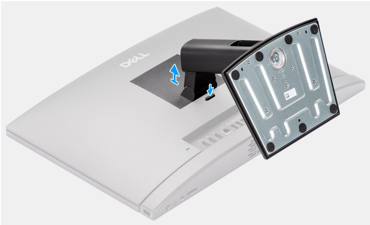
**Figura 32. Rimozione del supporto fisso**
