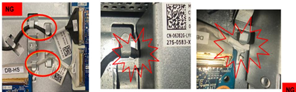
Figura 18. Instradamento non corretto del cavo di alimentazione (MB-PWR) e del cavo ad alta velocità (MB-HS)
