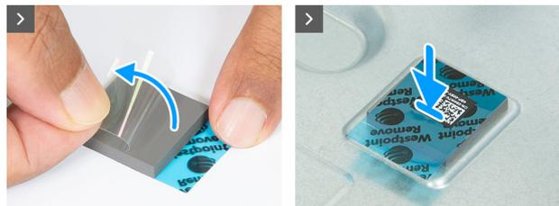
Figura 26. Installazione del nuovo cuscinetto termico
