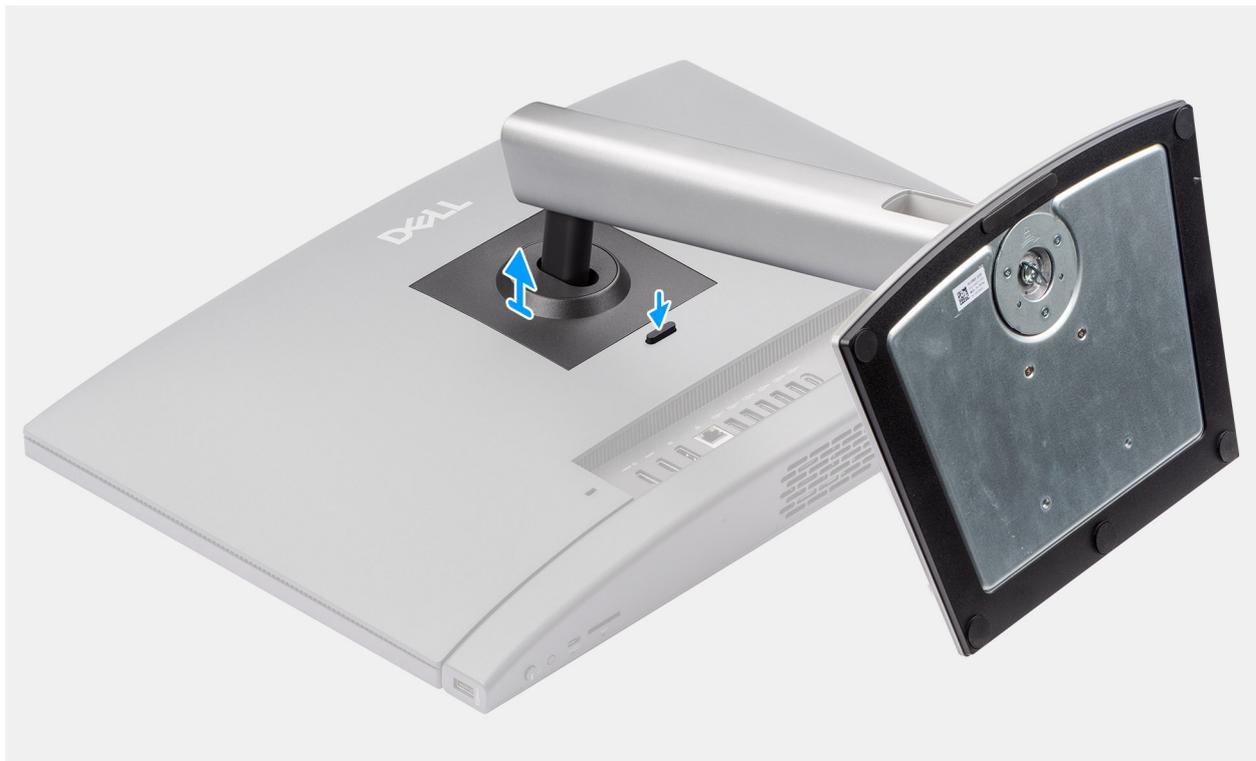
Figura 31. Rimozione del supporto ad altezza regolabile (HAS)
