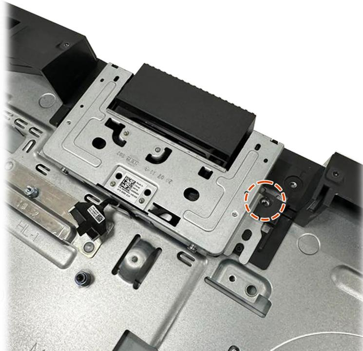
**Figura 28. Gruppo fotocamera in una configurazione non touch-screen**
