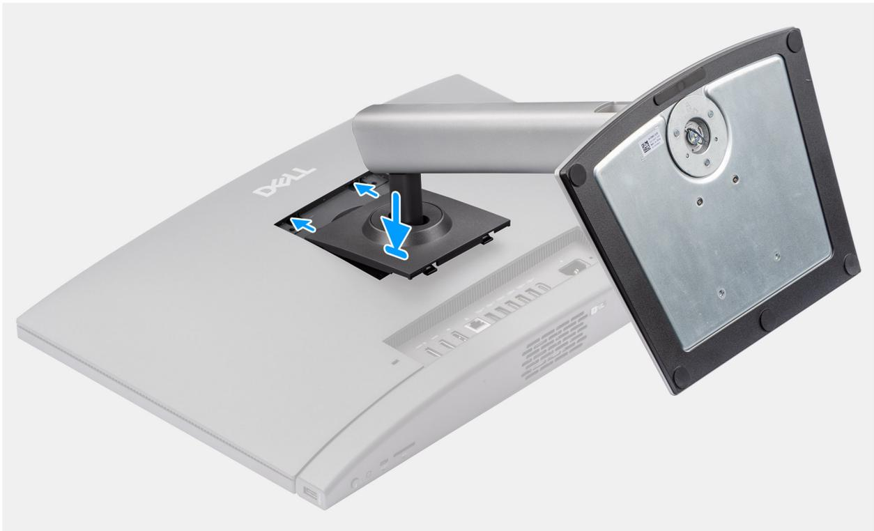
Figura 33. Installazione del supporto ad altezza regolabile (HAS)
