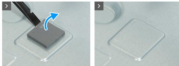
Figura 25. Rimozione del cuscinetto termico precedente
