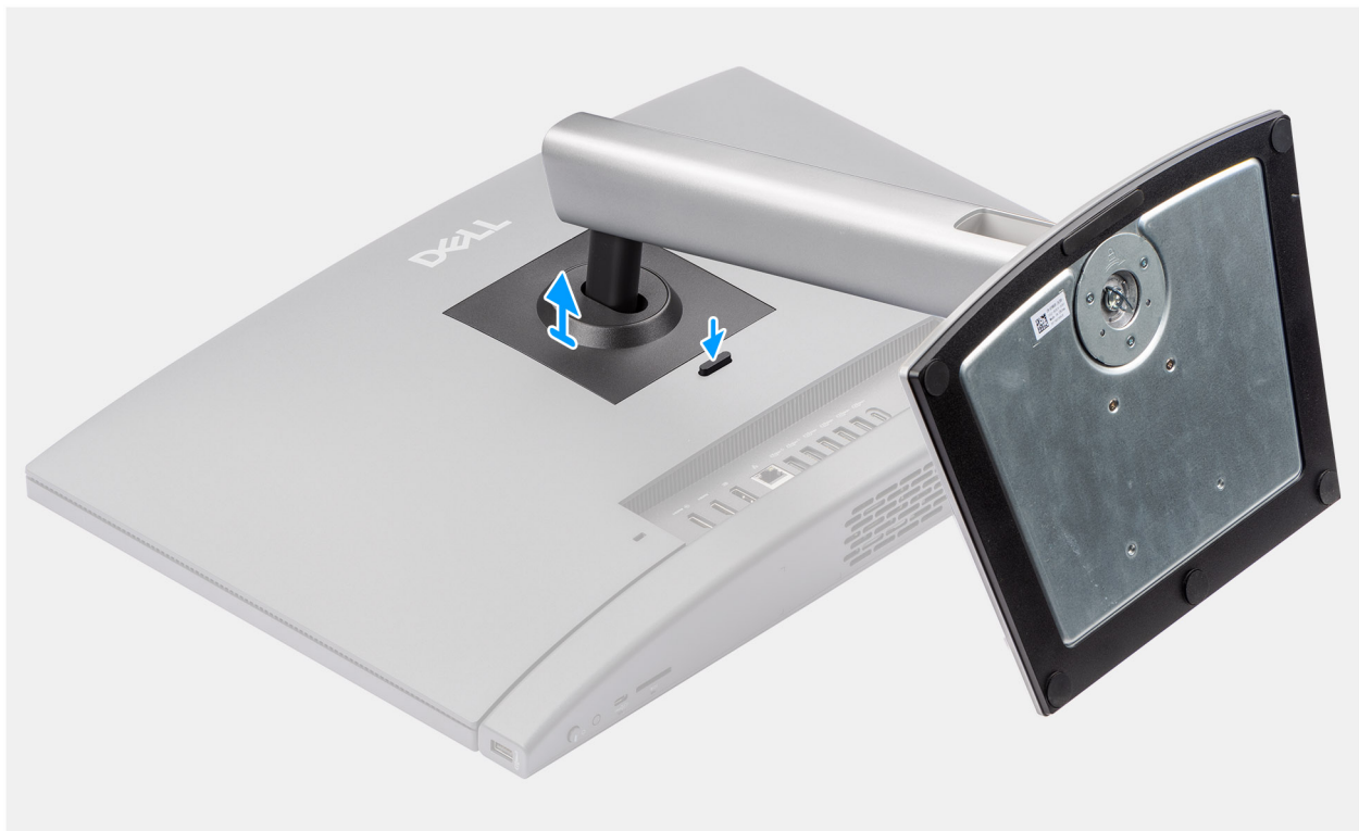
Abbildung 13. Entfernen des höhenverstellbaren Ständers (HAS)
