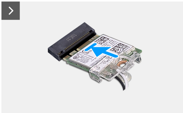
Abbildung 24. Installieren der Wireless-Karte
