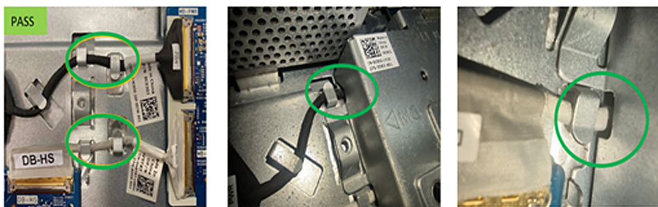
Abbildung 17. Korrekte Führung des Netzkabels (MB-PWR) und des Hochgeschwindigkeitskabels (MB-HS)
