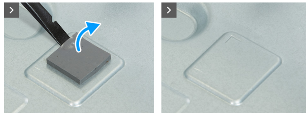
Abbildung 25. Entfernen des alten Wärmeleitpads
