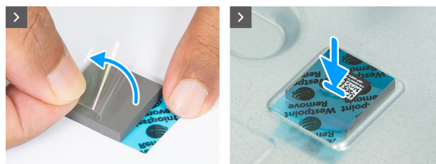
Abbildung 26. Anbringen des neuen Wärmeleitpads
