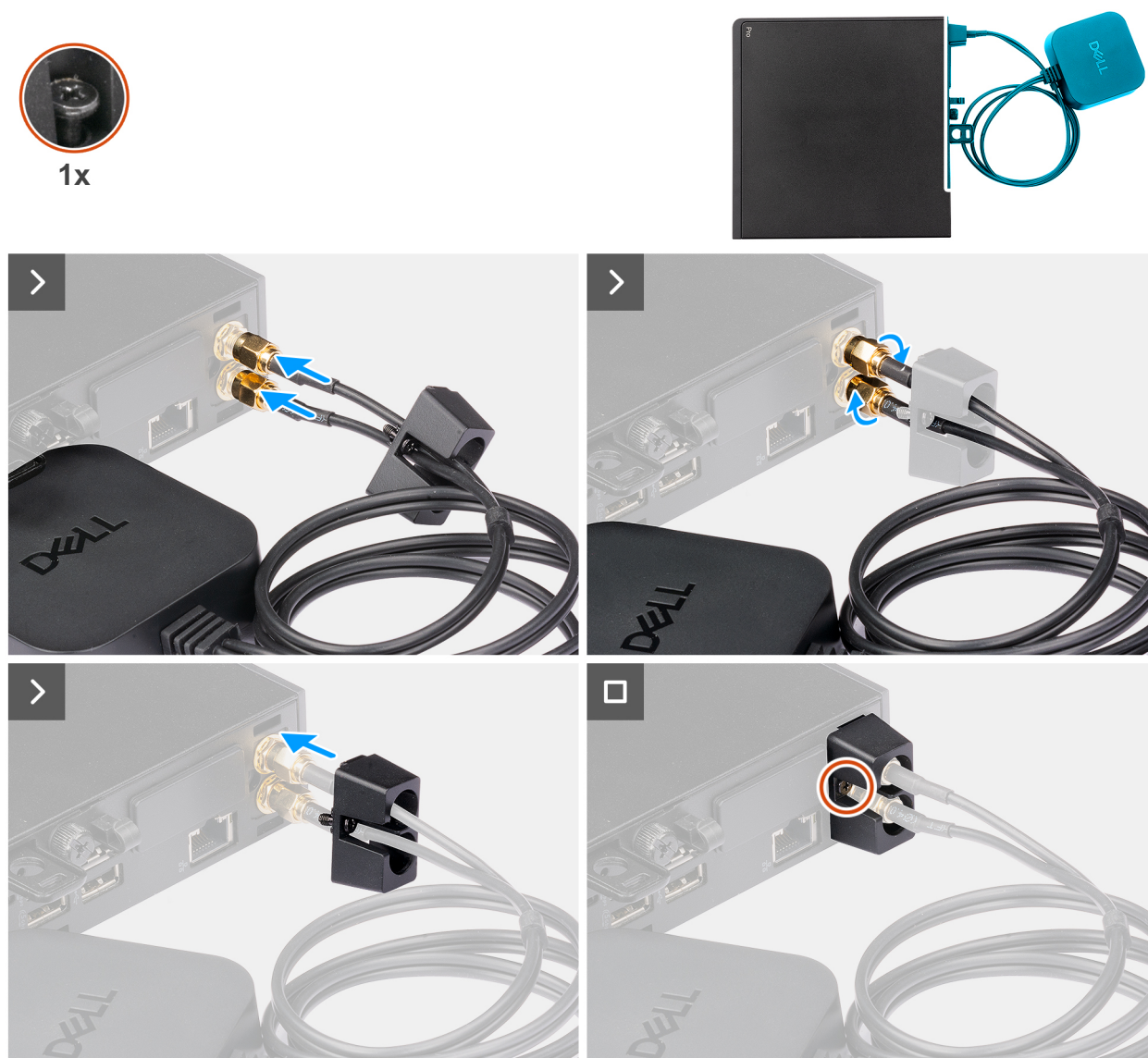
Figure 35. Installation de l'antenne Puck externe
