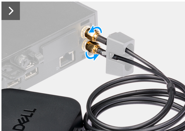
Afbeelding 34. De externe puckantenne verwijderen
