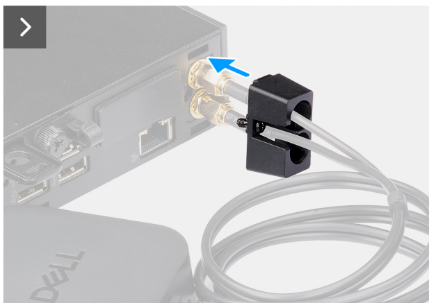
Afbeelding 35. De externe puckantenne installeren
