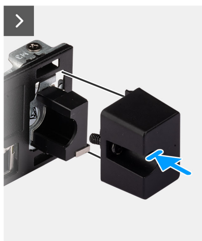
Afbeelding 68. De antennemodule (witte kabel) plaatsen
