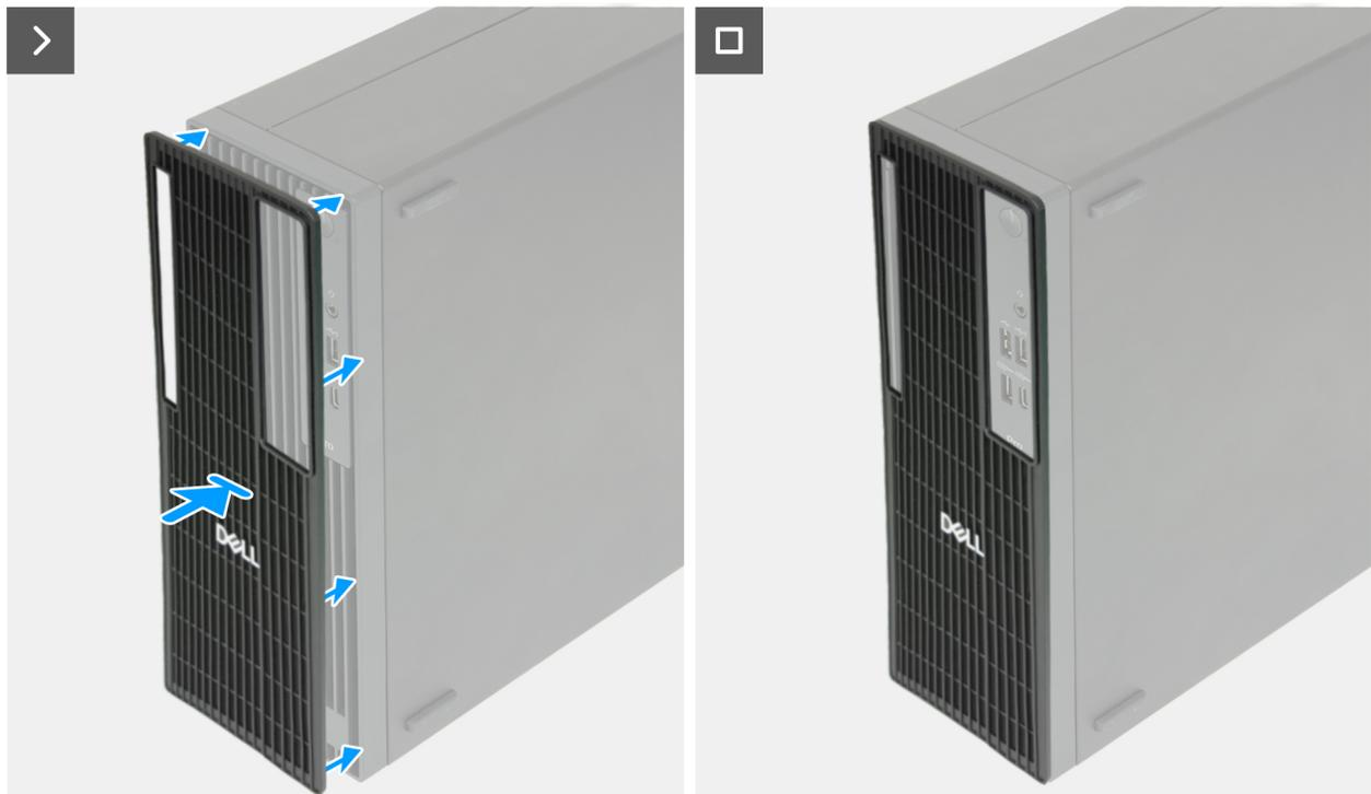
Figure 15. Installation du filtre anti-poussières
