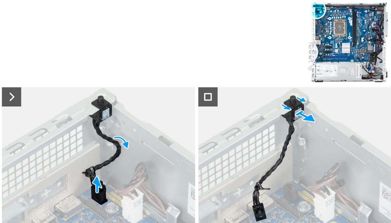
Figure 41. Retrait du commutateur d'intrusion
