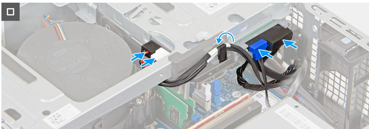
Figure 38. Installation de la baie de disques
