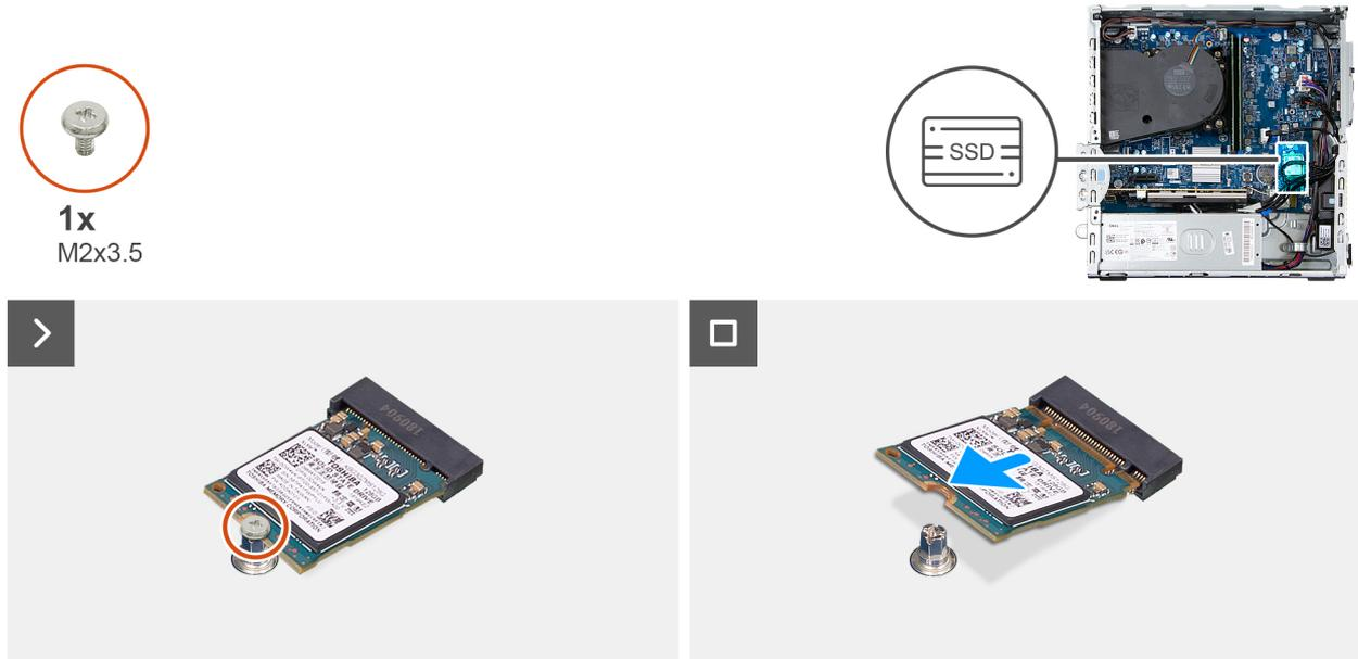
Figure 22. Retrait du disque SSD M.2 2230
