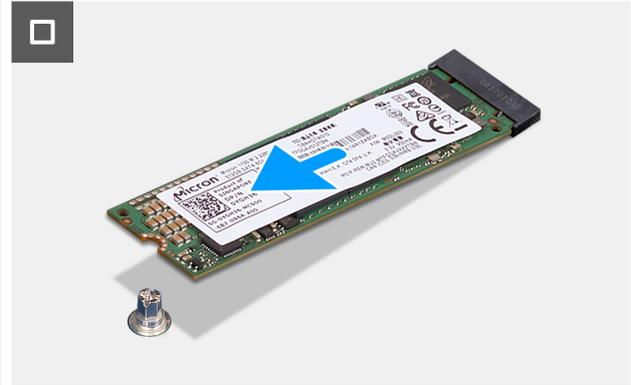
Figure 24. Retrait du disque SSD M.2 2280
