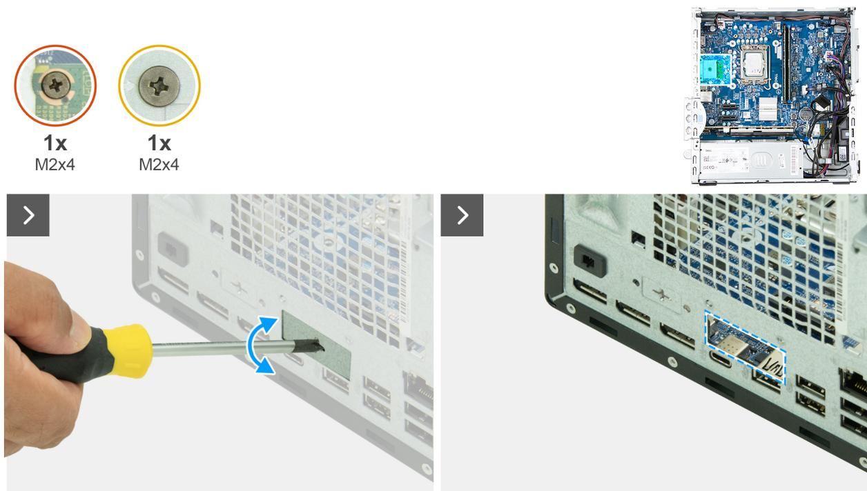
Figure 54. Installation du module de port en option
