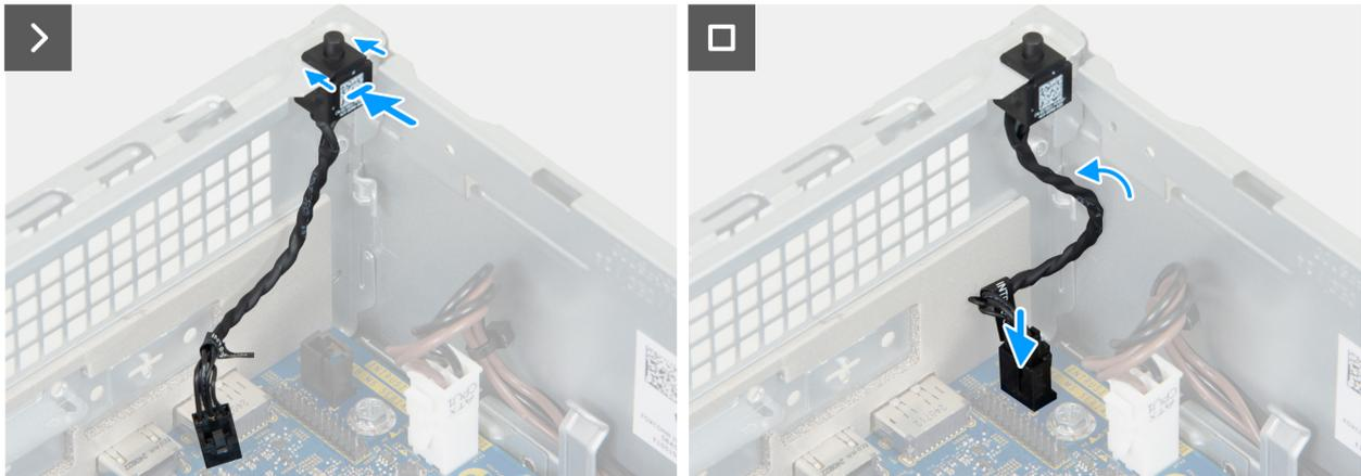
Figure 42. Installation du commutateur d'intrusion
