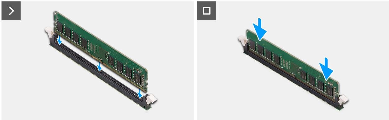
Figure 21. Installation du module de mémoire
