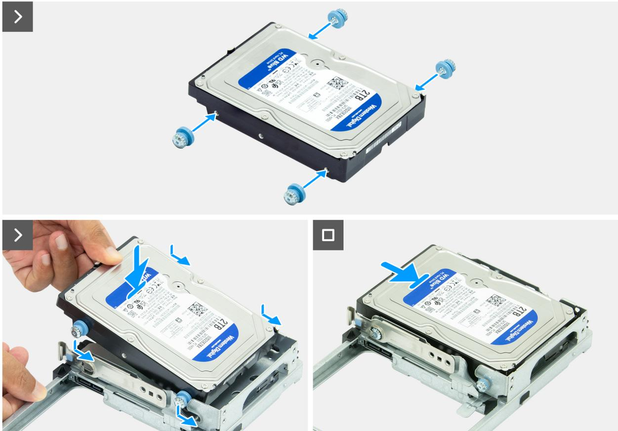
Figure 40. Installation du disque dur
