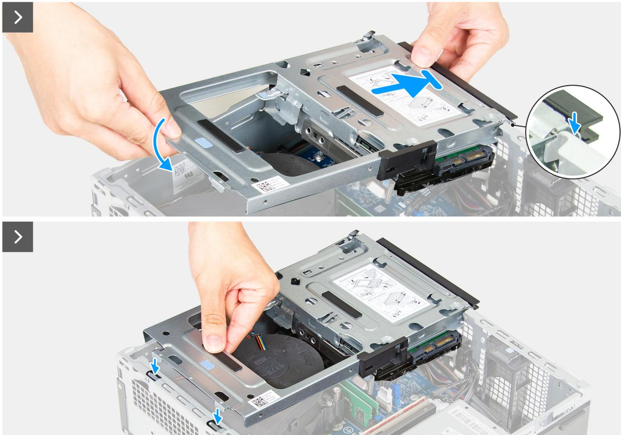
Figure 37. Installation de la baie de disques
