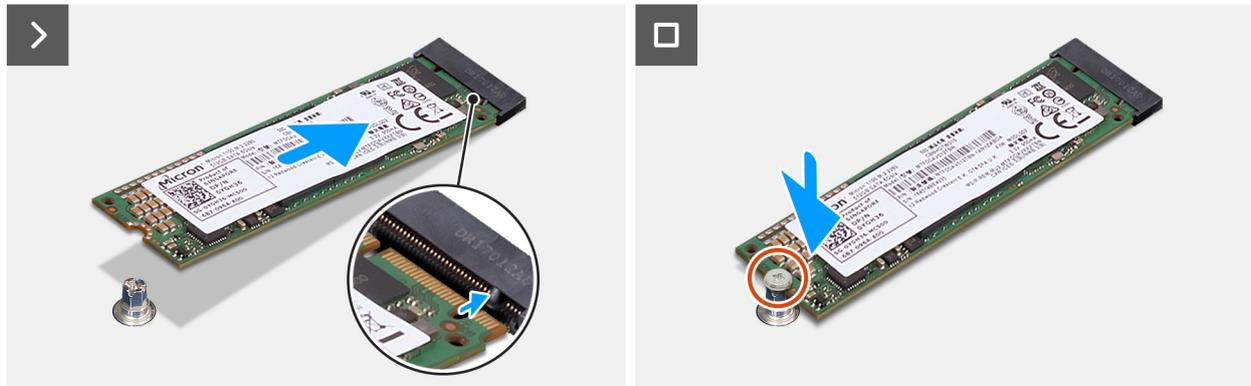
Figure 25. Installation du disque SSD M.2 2280
