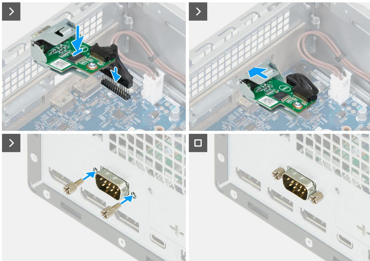
Figure 58. Installation du module de port série
