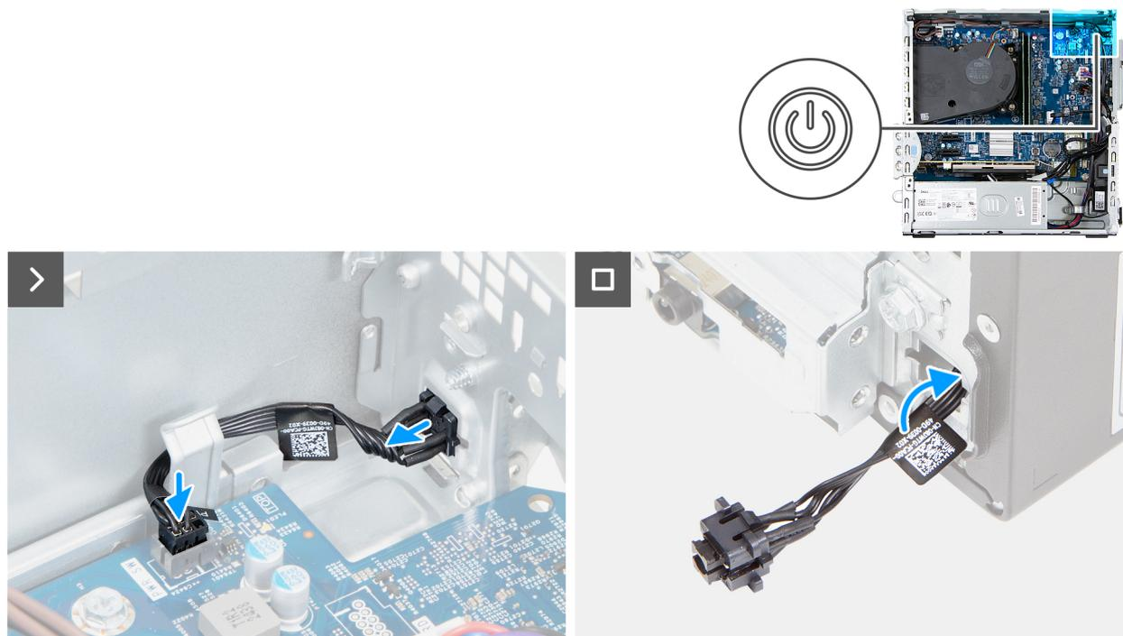
**Figure 44. Installation du bouton d'alimentation**
