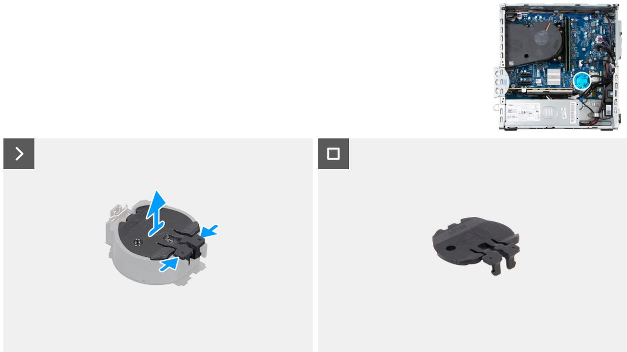
Figure 10. Retrait du capot de la pile bouton
