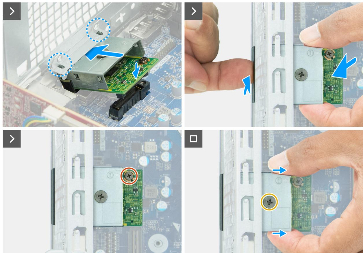
Figure 55. Installation du module de port en option
