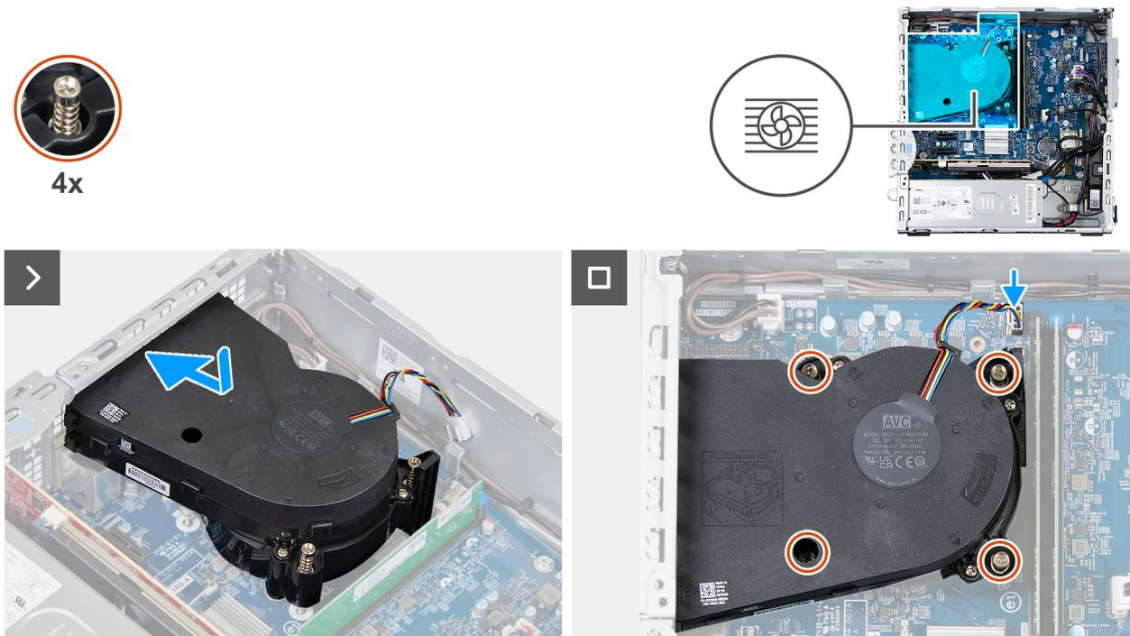
Figure 52. Installation de l'assemblage du ventilateur et du dissipateur de chaleur du processeur
