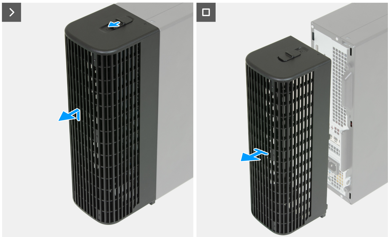
Figure 4. Retrait de la gaine de câble
