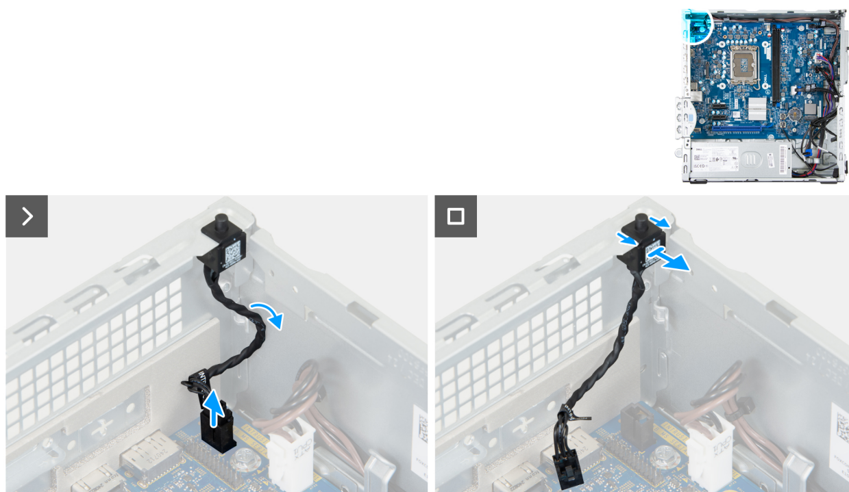
Figure 41. Retrait du commutateur d'intrusion
