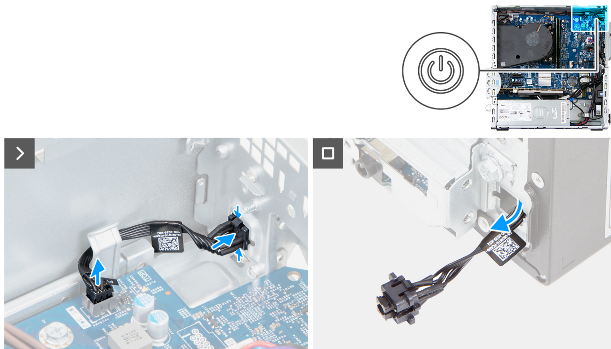
Figure 43. Retrait du bouton d'alimentation
