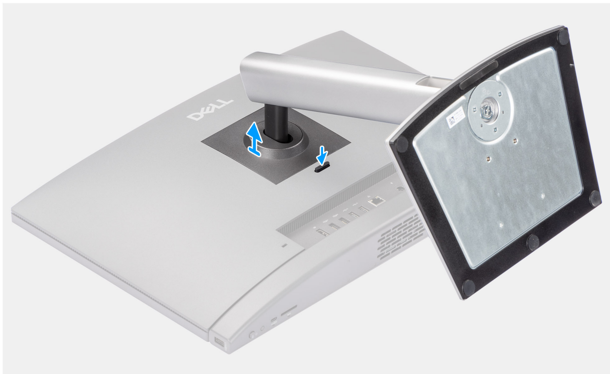
Figure 13. Retrait du socle ajustable en hauteur (HAS)
