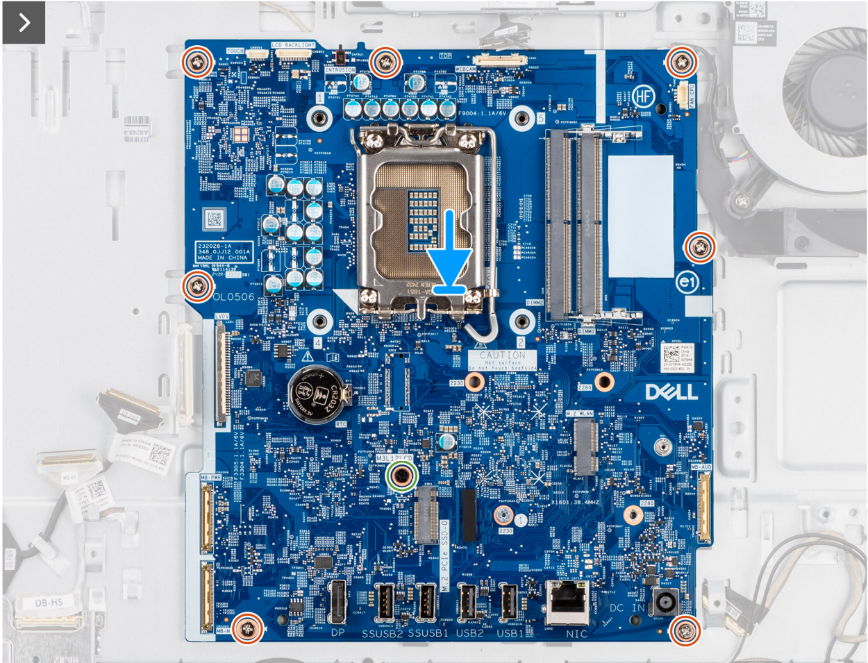
Figure 50. Installation de la carte système
