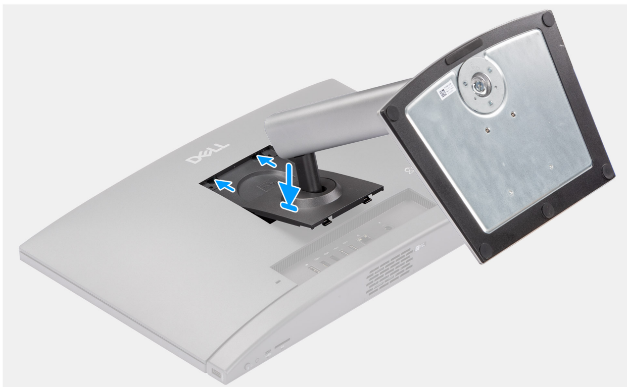
Figure 15. Installation du socle ajustable en hauteur (HAS)
