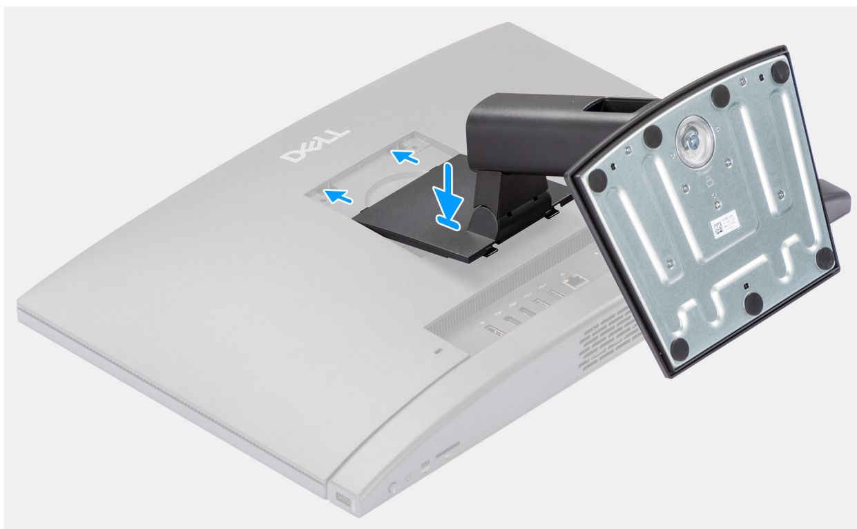
Figure 16. Installation du socle fixe
