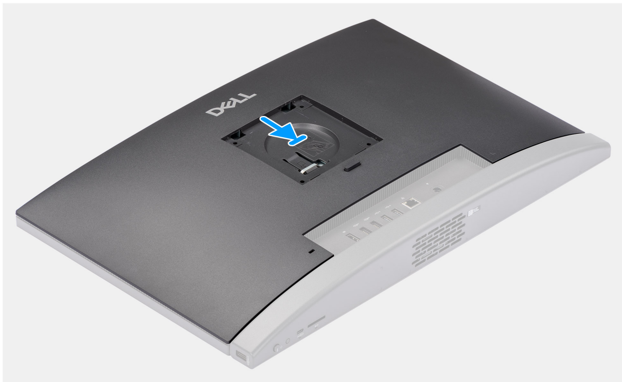
Figure 18. Installation du capot arrière
