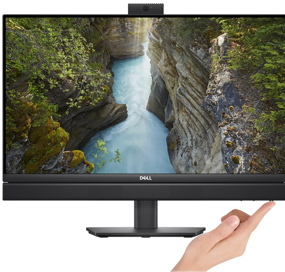
**Figura11. Pressionar o botão de alimentação no computador**
