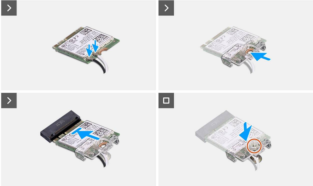
Figura24. Instalar a placa de comunicação sem fios
