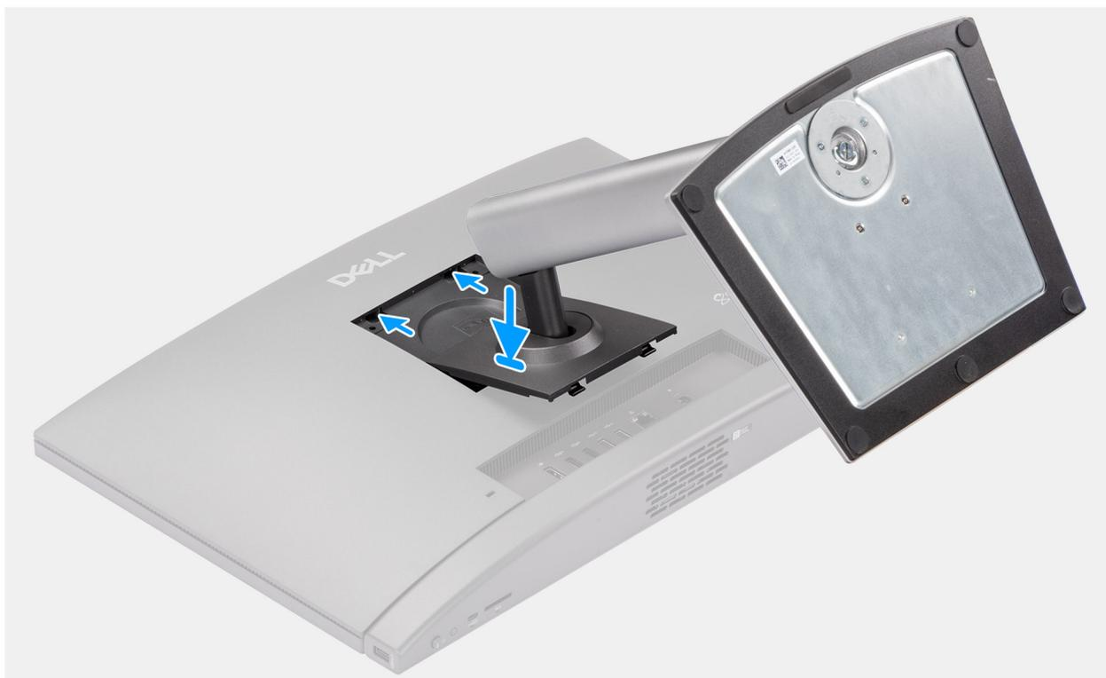
Figura15. Instalar o Suporte Ajustável em Altura (HAS)
