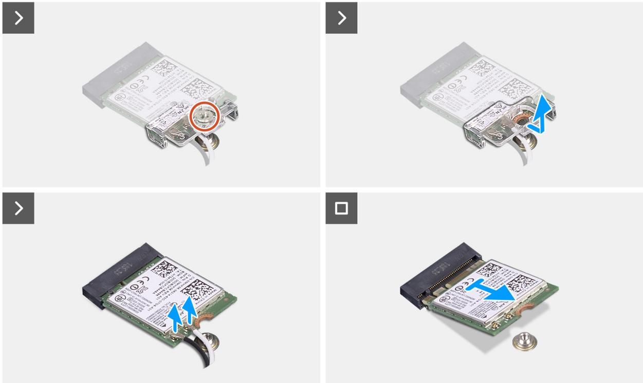
Figura23. Retirar a placa de comunicação sem fios
