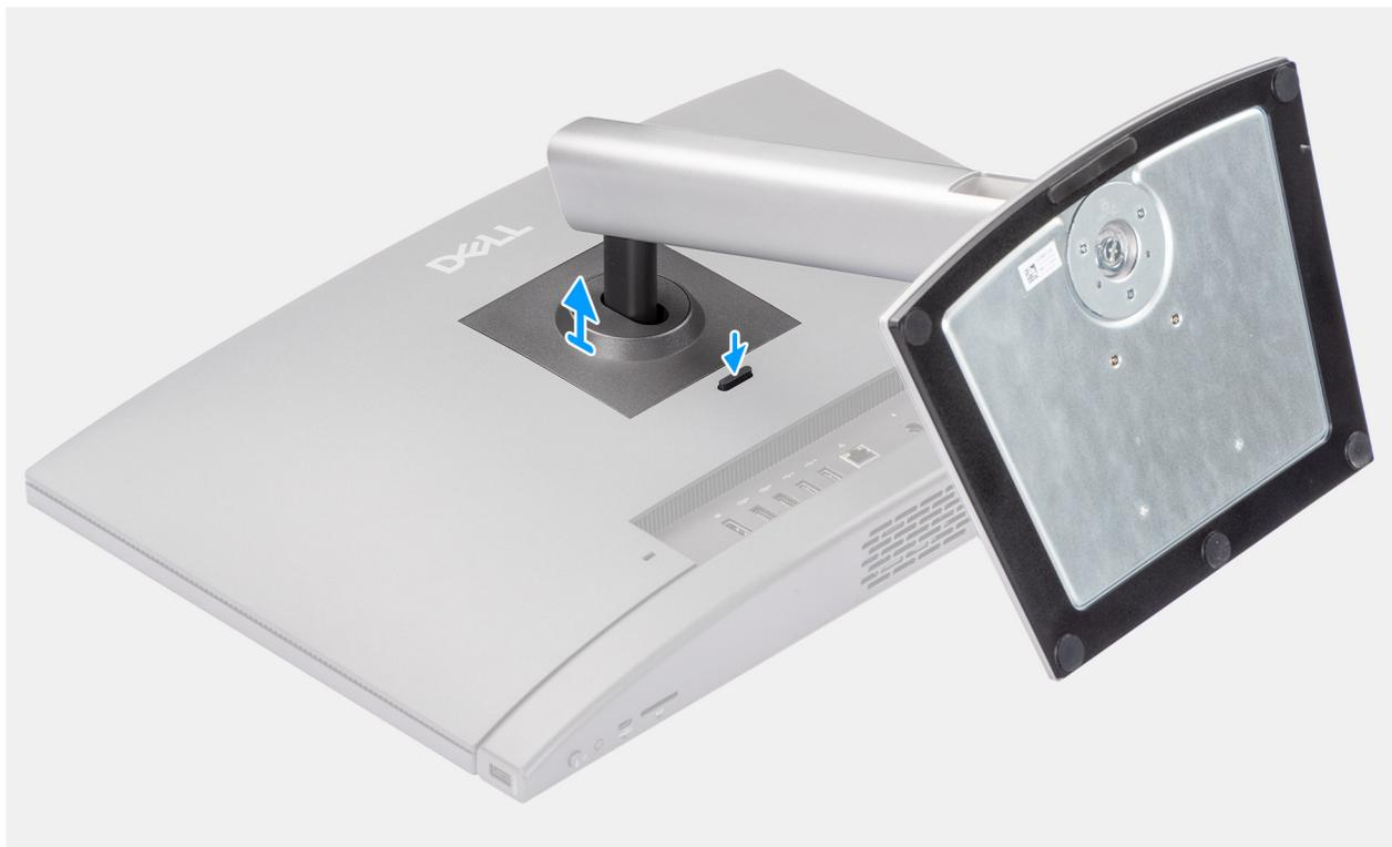
Figura13. Retirar o Suporte Ajustável em Altura (HAS)
