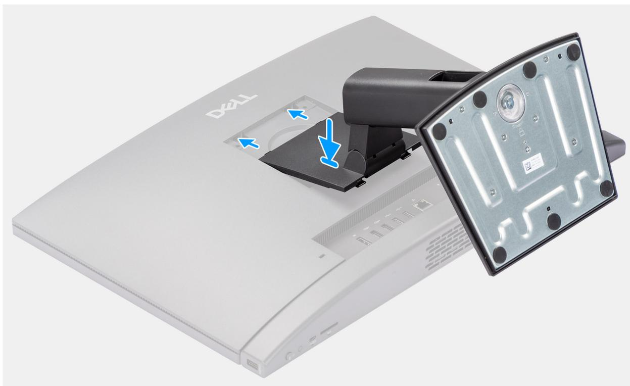
Figura16. Instalar o Suporte Fixo
