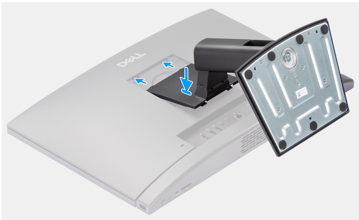
Ilustración 16. Instalación de la base fija
