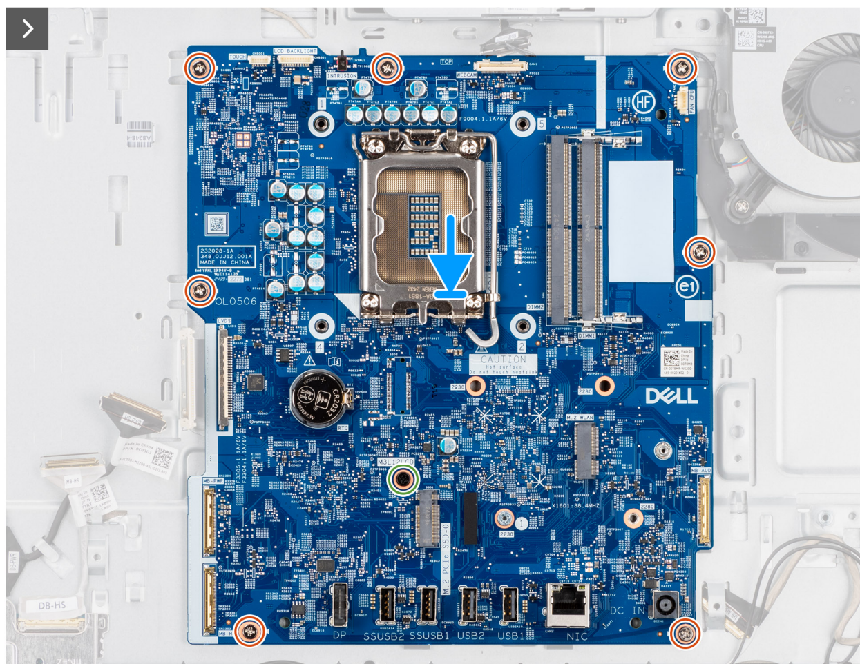
Ilustración 50. Instalación de la tarjeta madre
