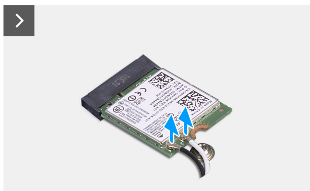
Ilustración 23. Extracción de la tarjeta inalámbrica
