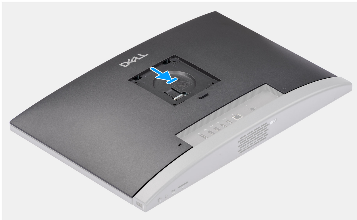
Ilustración 18. Instalación de la cubierta posterior
