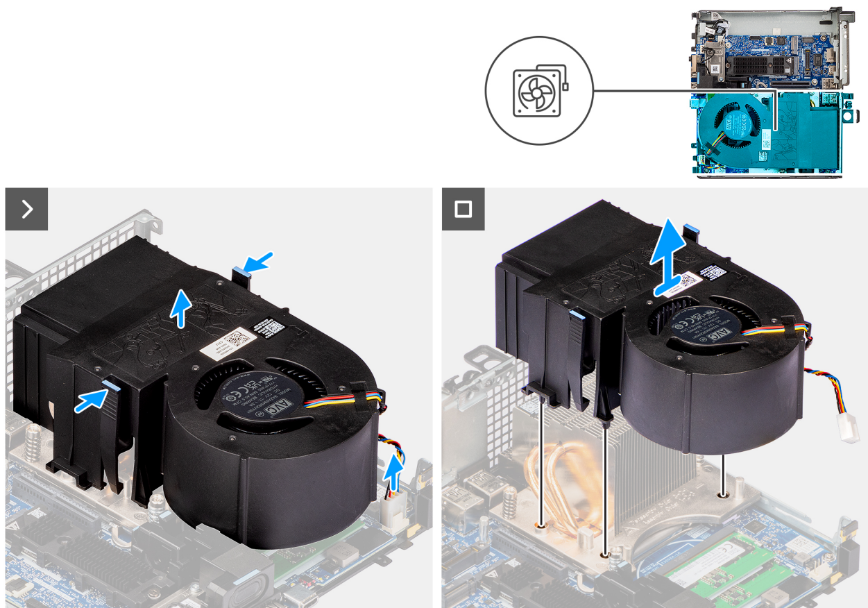
Ilustración 15. Extracción del ventilador del sistema
