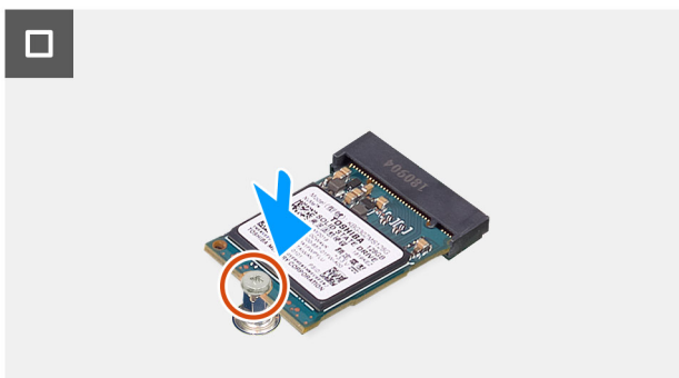
Ilustración 32. Instalación de la unidad de estado sólido M.2 2230 en la ranura 0
