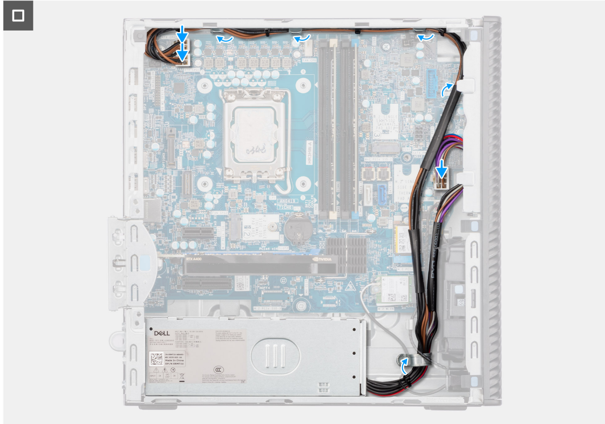
Ilustración 60. Instalación de la fuente de alimentación
