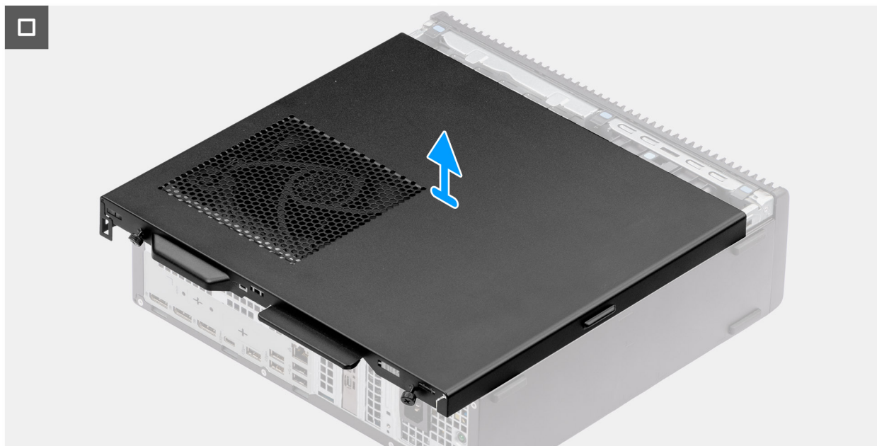
Ilustración 10. Extracción de la cubierta lateral
