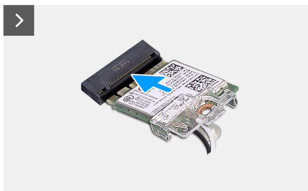
Ilustración 42. Instalación de la tarjeta inalámbrica
