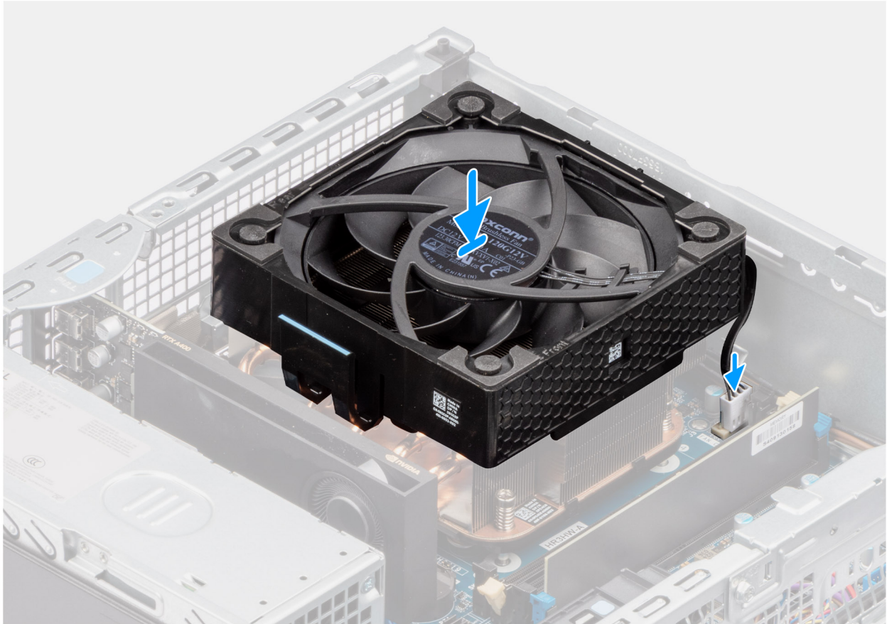
Ilustración 52. Instalación del ventilador del procesador
