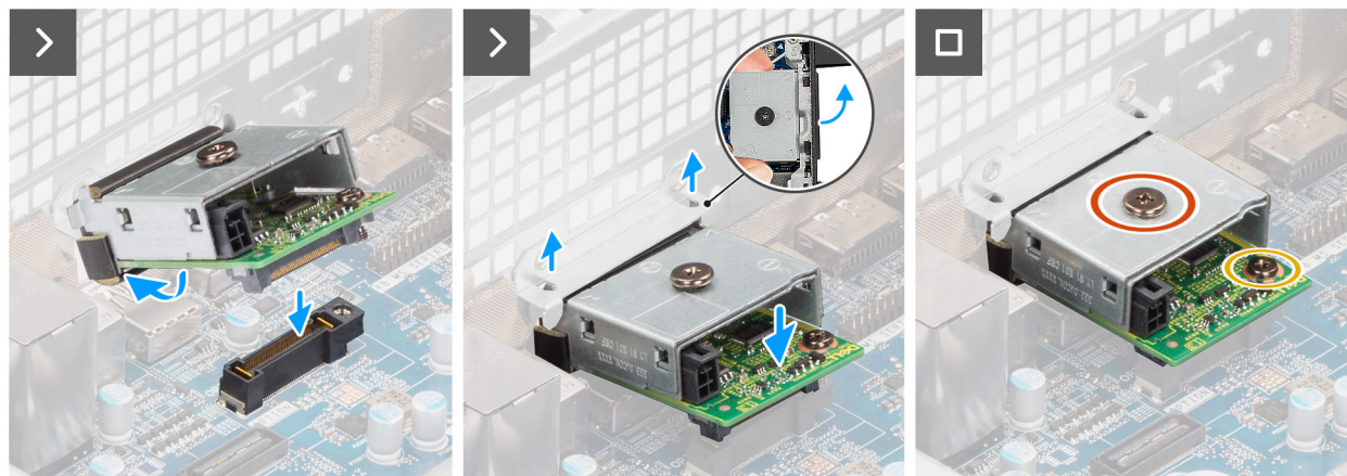
Ilustración 66. Instalación del módulo USB opcional
