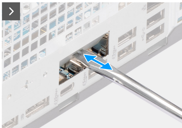
Ilustración 68. Instalación del módulo Thunderbolt opcional
