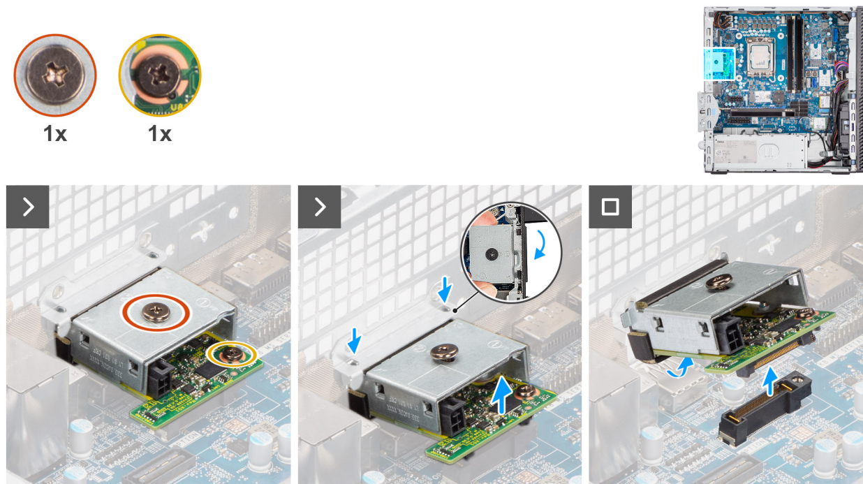
Ilustración 67. Extracción del módulo Thunderbolt opcional
