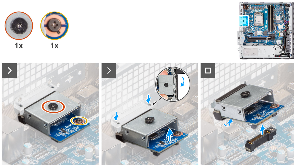
Ilustración 73. Extracción del módulo HDMI opcional
