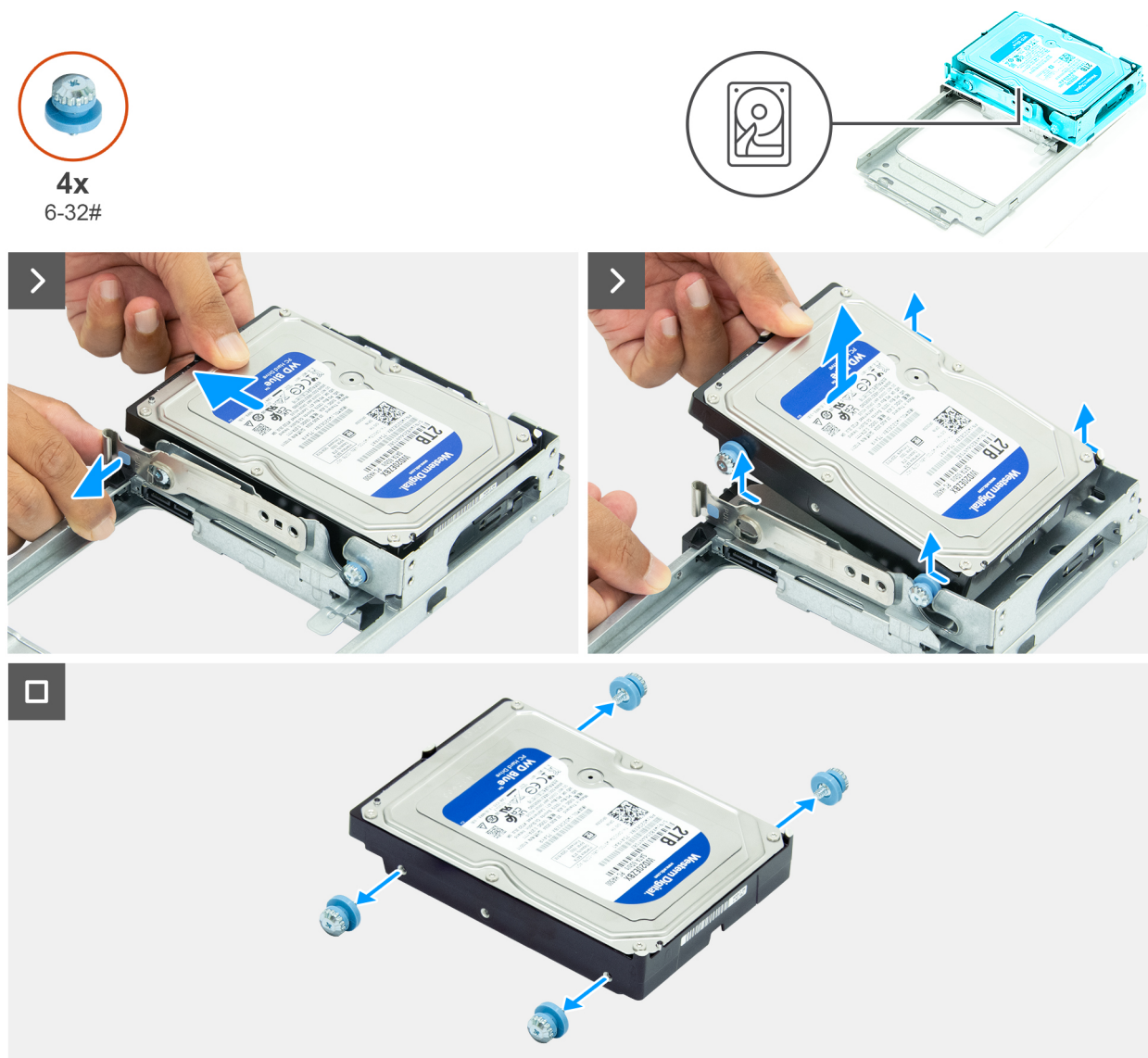
Ilustración 29. Extracción del disco duro
