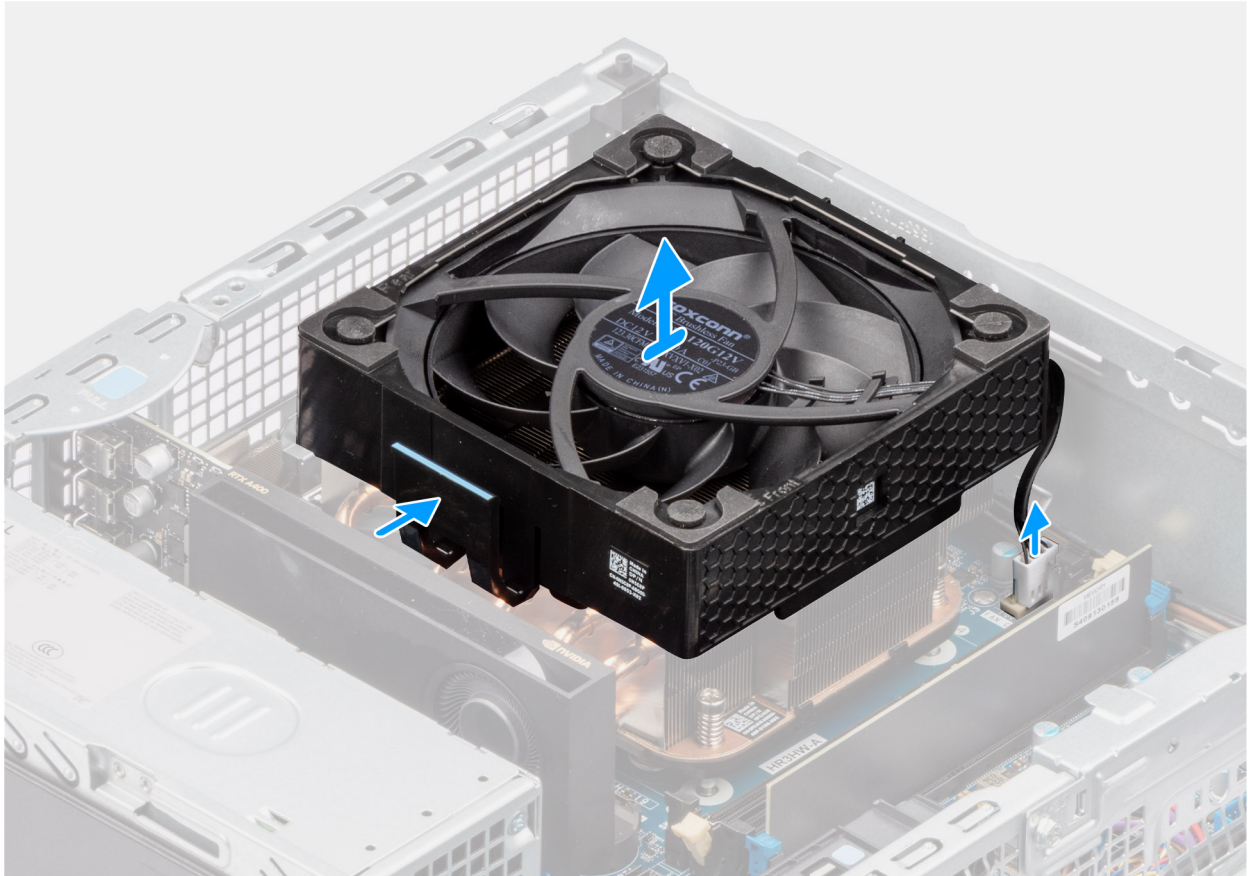
Ilustración 51. Extracción del ventilador del procesador
