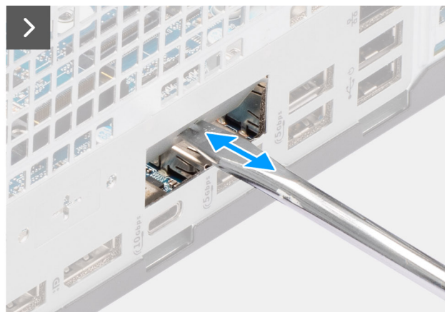
Ilustración 71. Instalación del módulo LAN opcional
