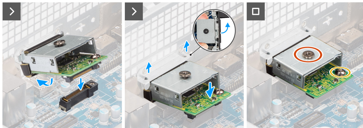
Ilustración 78. Instalación del módulo DisplayPort opcional
