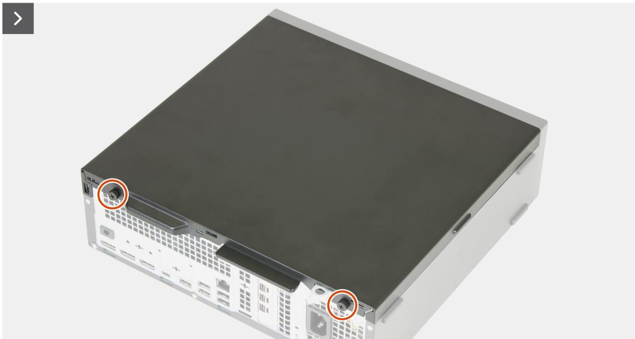
Figura 6. Rimozione del coperchio laterale
