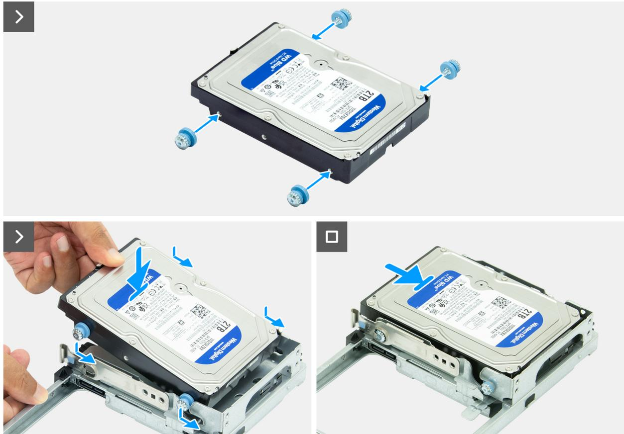
Figura 40. Installazione del disco rigido
