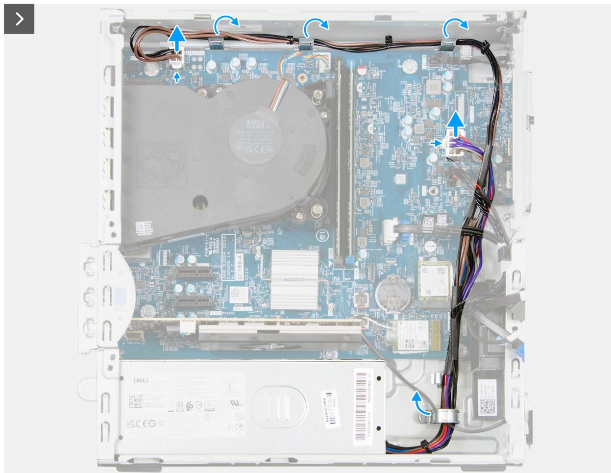
Figura 47. Rimozione dell'unità di alimentazione
