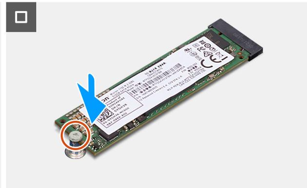
Figura 25. Installazione dell'unità SSD M.2 2280
