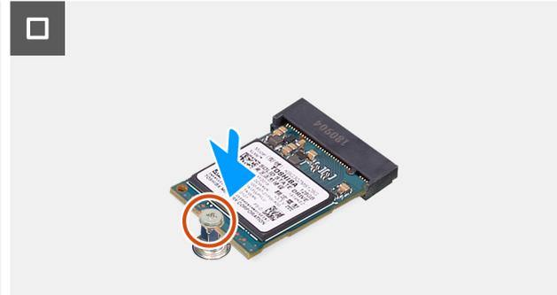
**Figura 23. Installazione dell'unità SSD M.2 2230**
