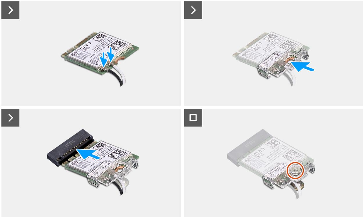
Figura 30. Installazione della scheda wireless
