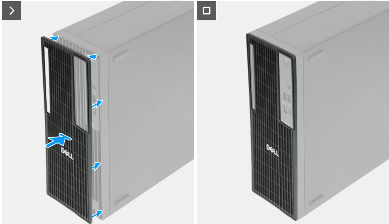
Figura 15. Installazione del filtro antipolvere
