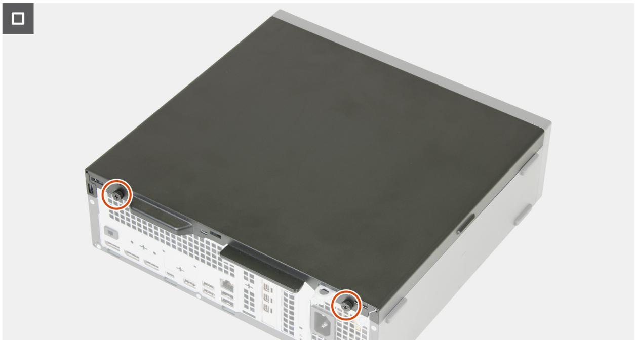
Figura 9. Installazione del coperchio laterale
