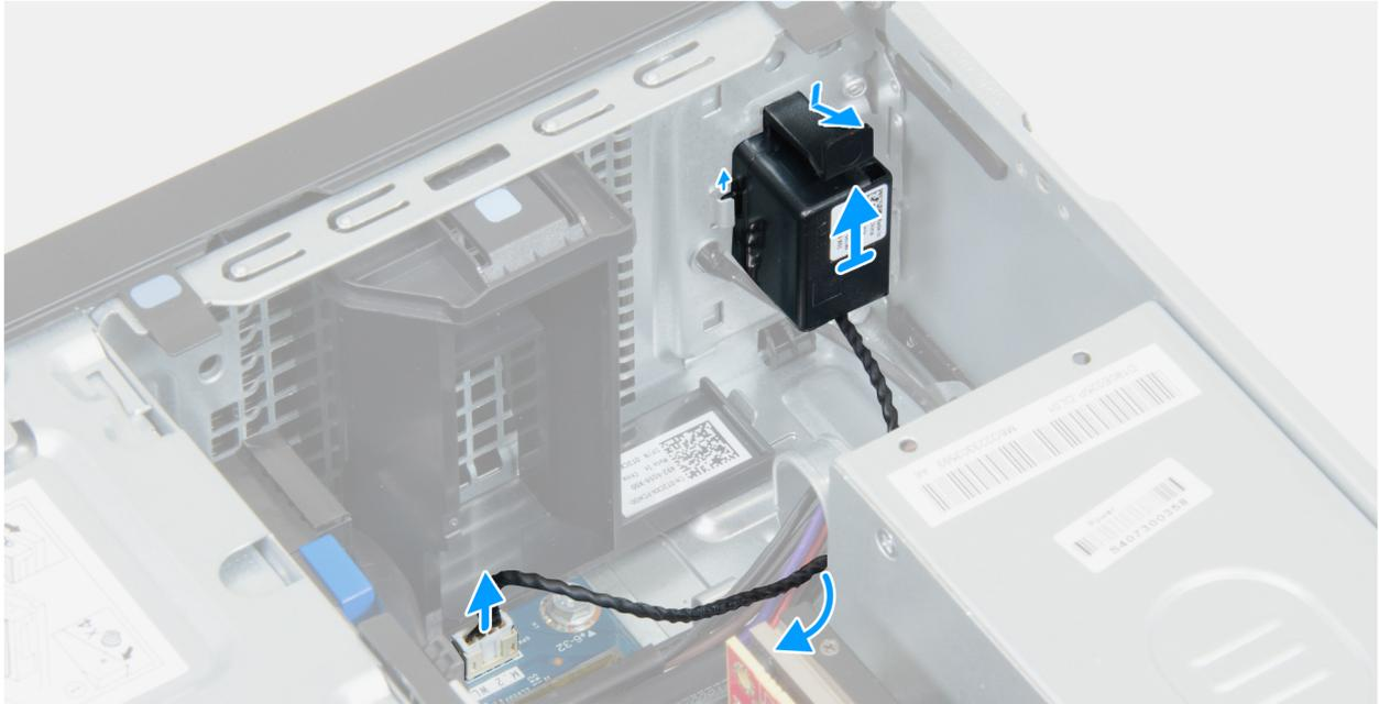
**Figura 18. Rimozione dell'altoparlante interno**
