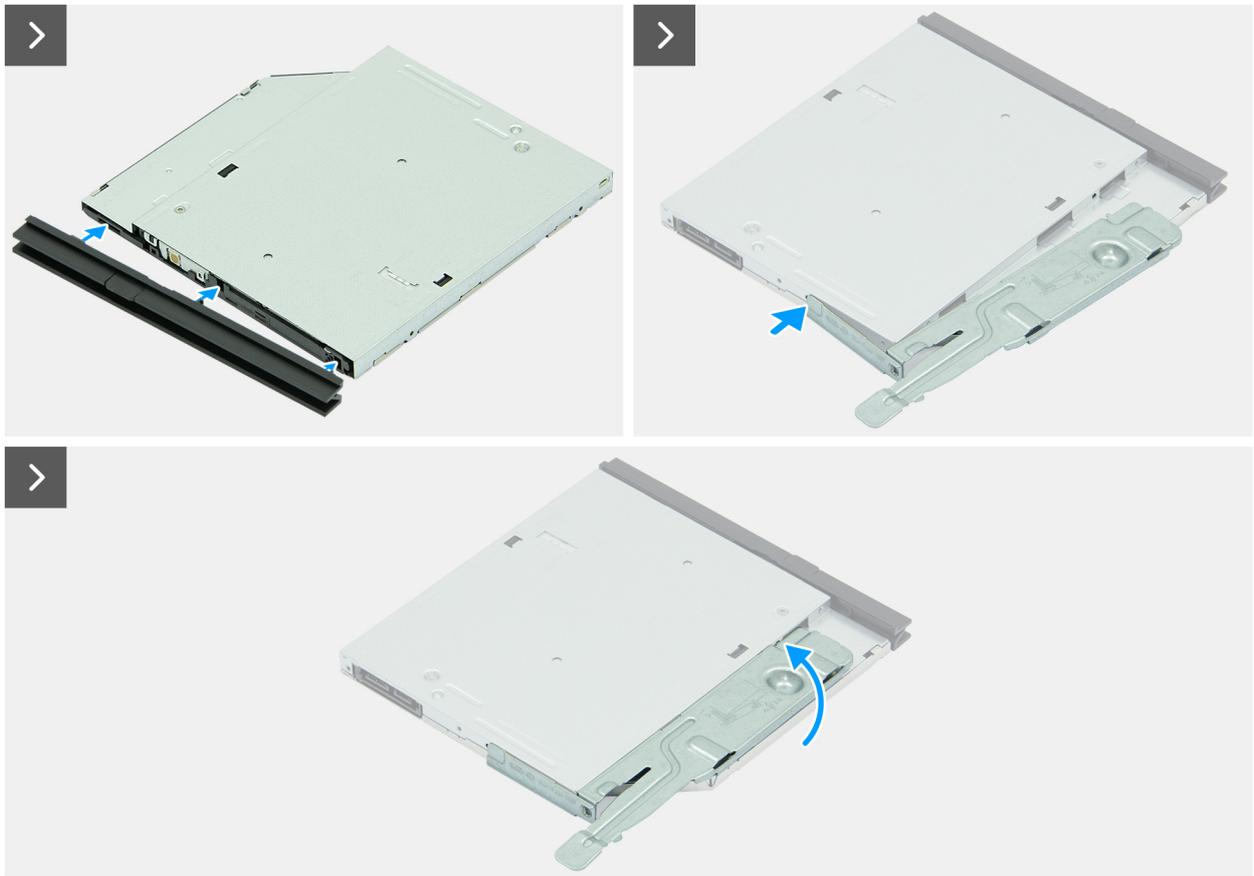
Figura 33. Installazione dell'unità ottica
