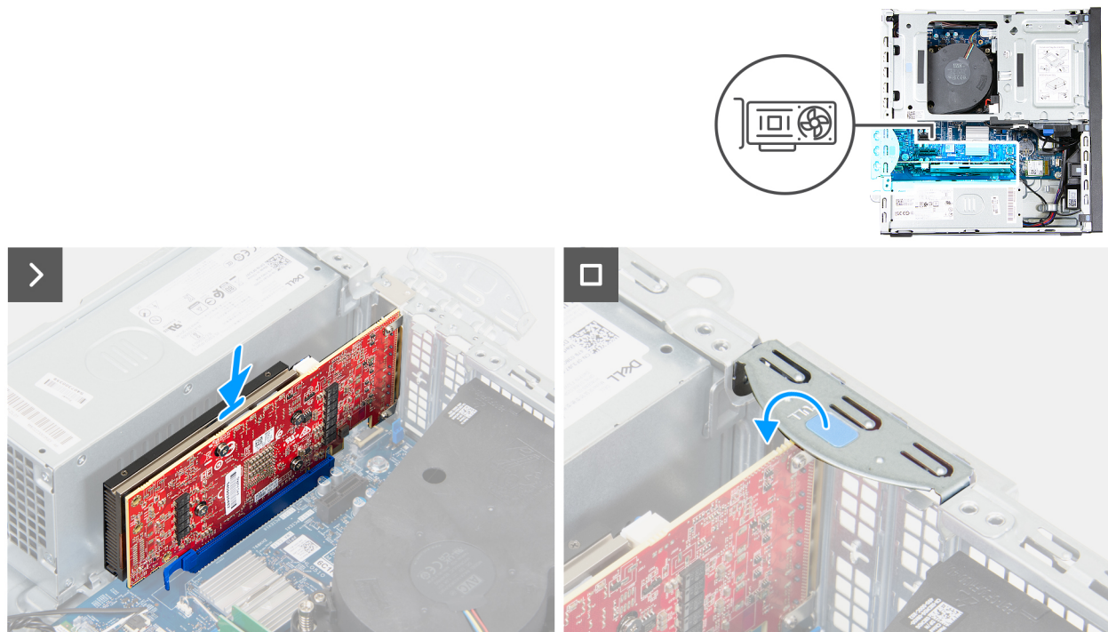
Abbildung 28. Installieren der Grafikkarte
