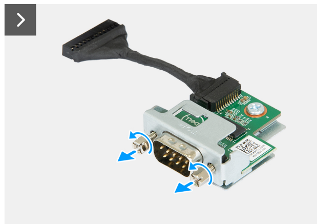
Abbildung 57. Installieren des seriellen Anschlussmoduls
