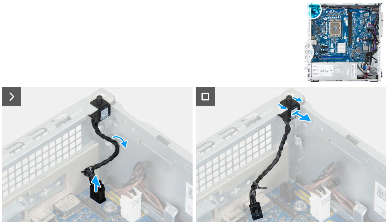
Abbildung 41. Entfernen des Eingriffsschalters
