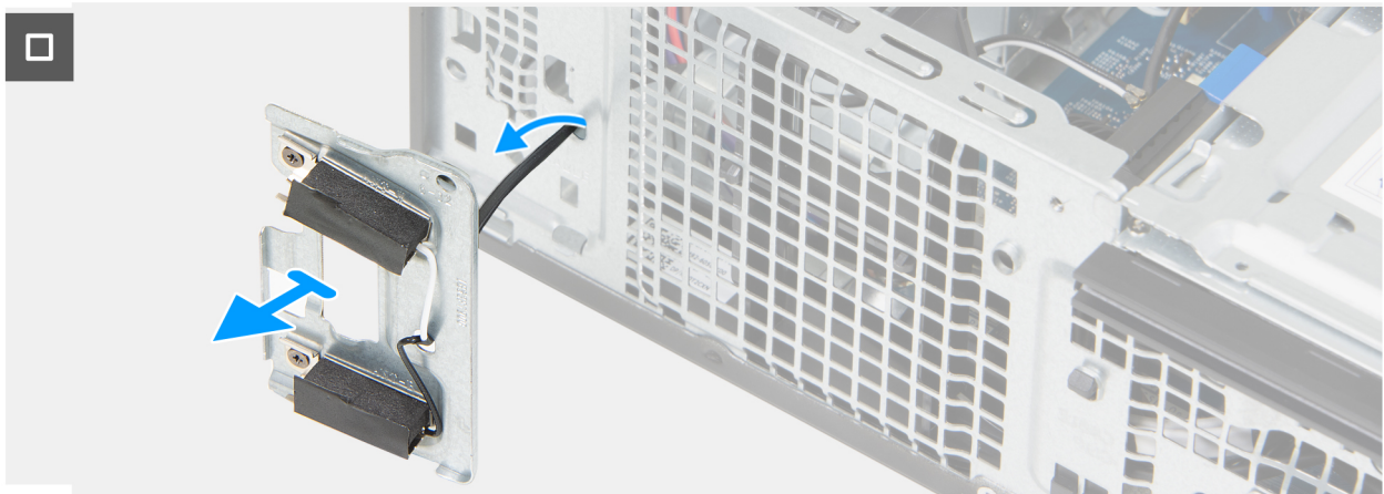
Abbildung 45. Entfernen der Antennenmodule
