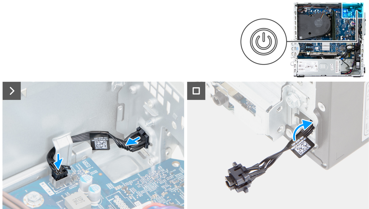
Abbildung 44. Installieren des Netzschalters
