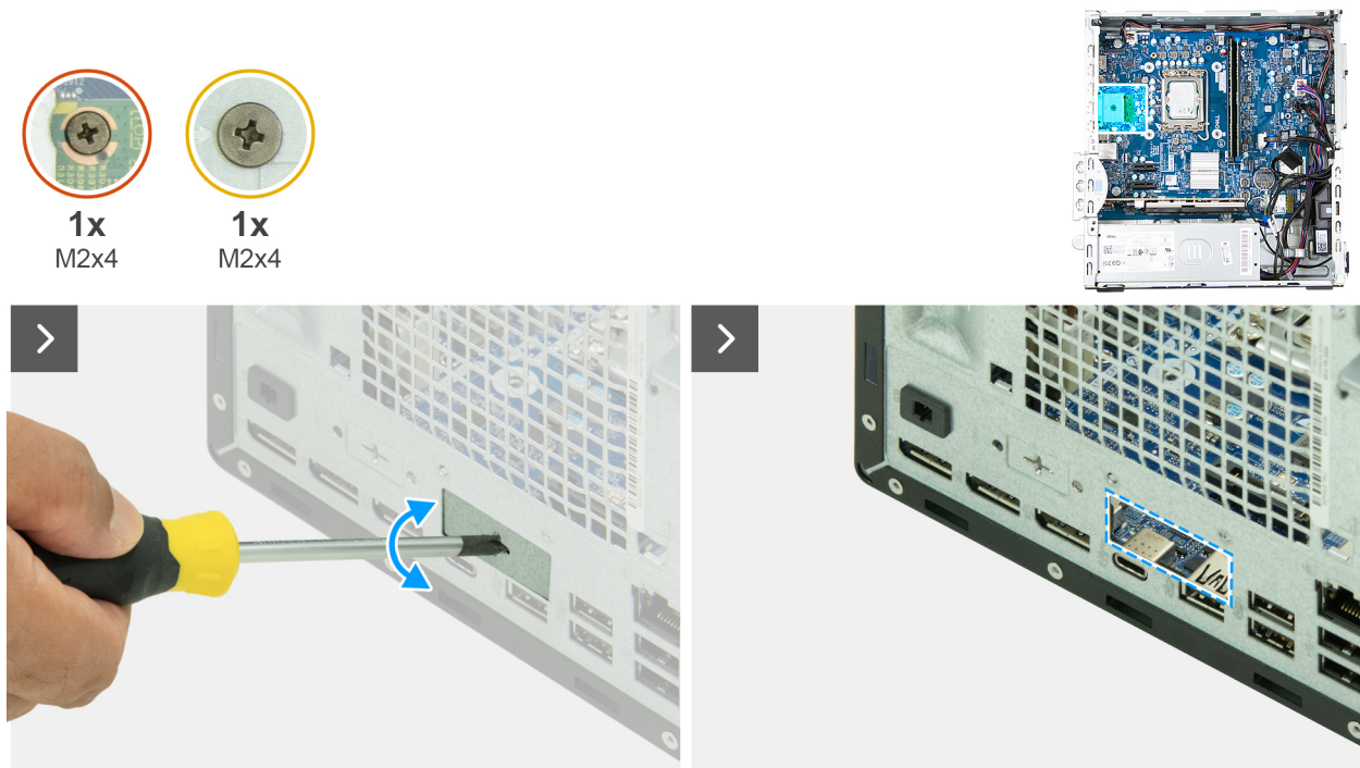
Abbildung 54. Installieren des optionalen Anschlussmoduls
