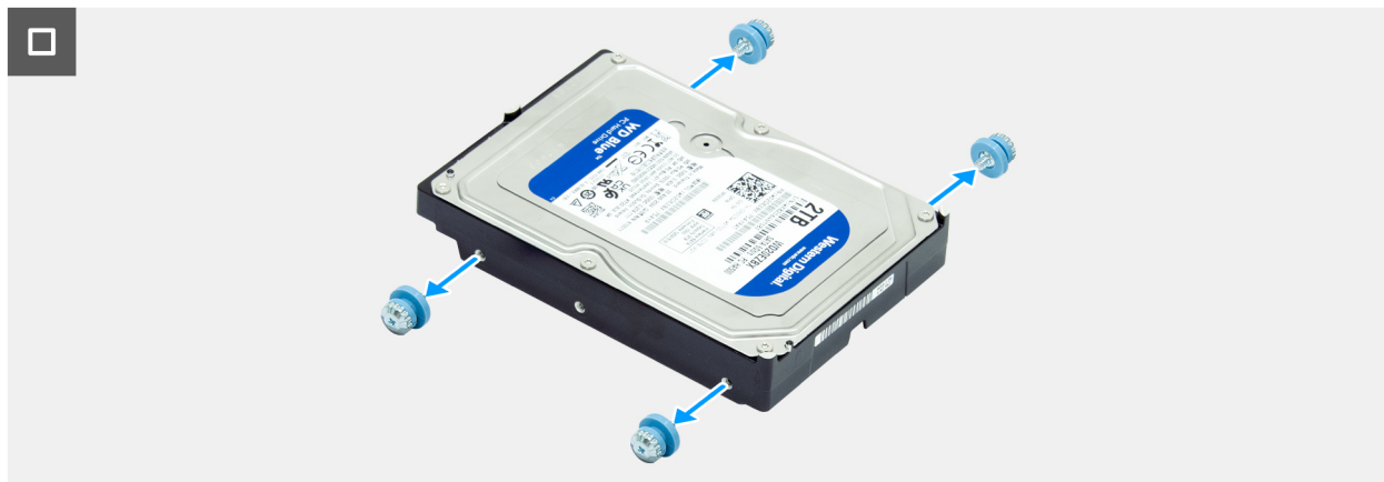
Abbildung 39. Entfernen der Festplatte
