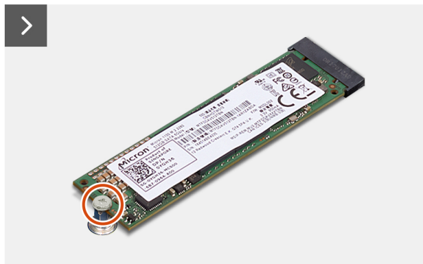
Abbildung 24. Entfernen des M.2-2280-Solid-State-Laufwerks
