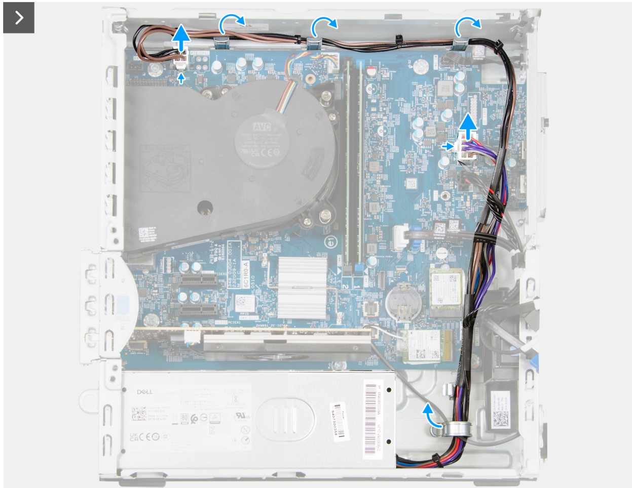
Abbildung 47. Entfernen der Stromversorgungseinheit
