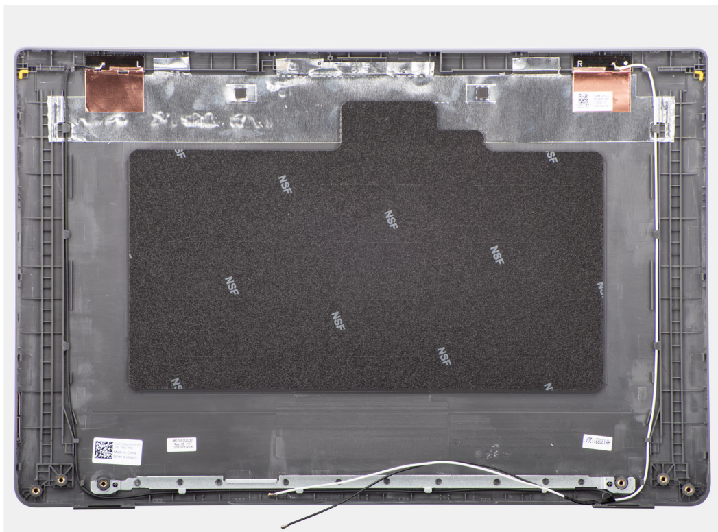
Figure 70. Retrait du capot arrière d'écran
