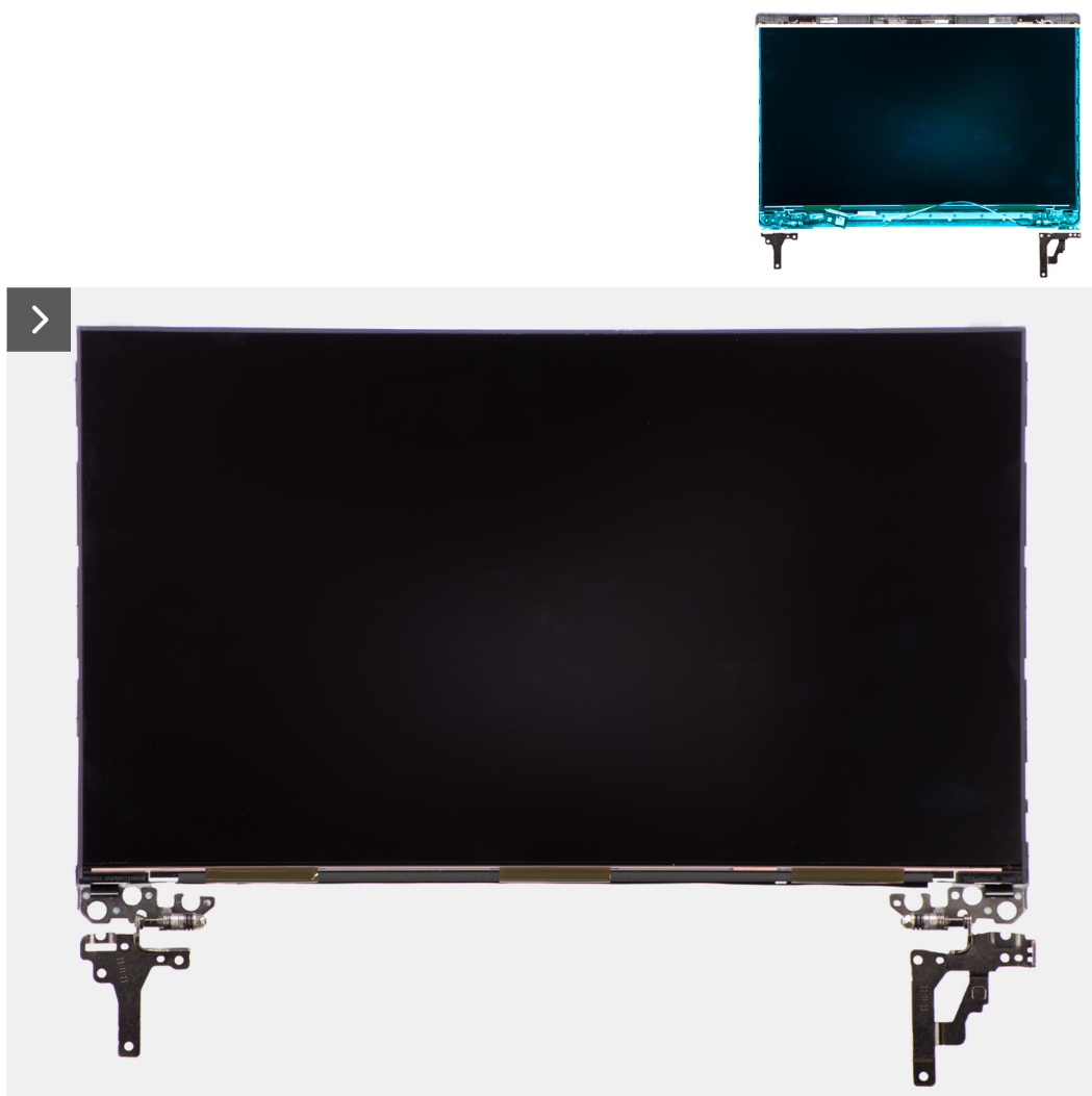
Figure 61. Installation du panneau d'écran
