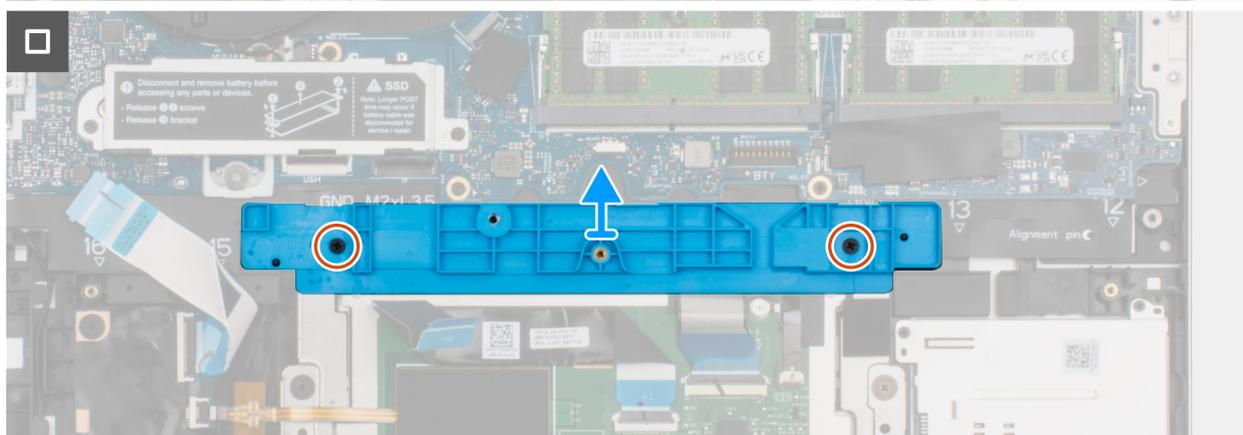
**Ilustración 45. Extracción del soporte de la batería**
