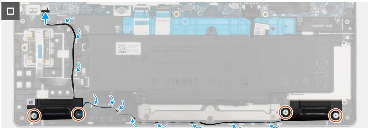
**Ilustración 37. Instalación de los parlantes**
