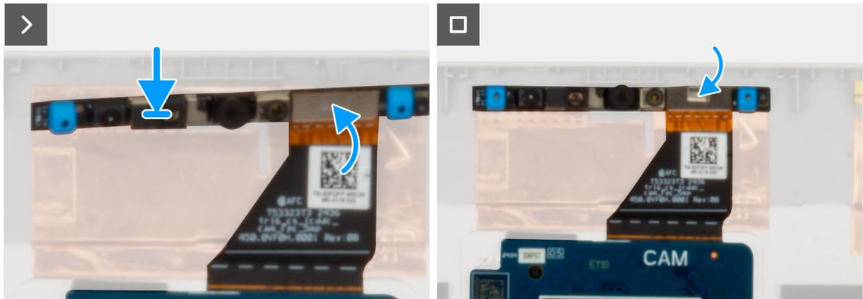
**Ilustración 76. Instalación del módulo de la cámara**
