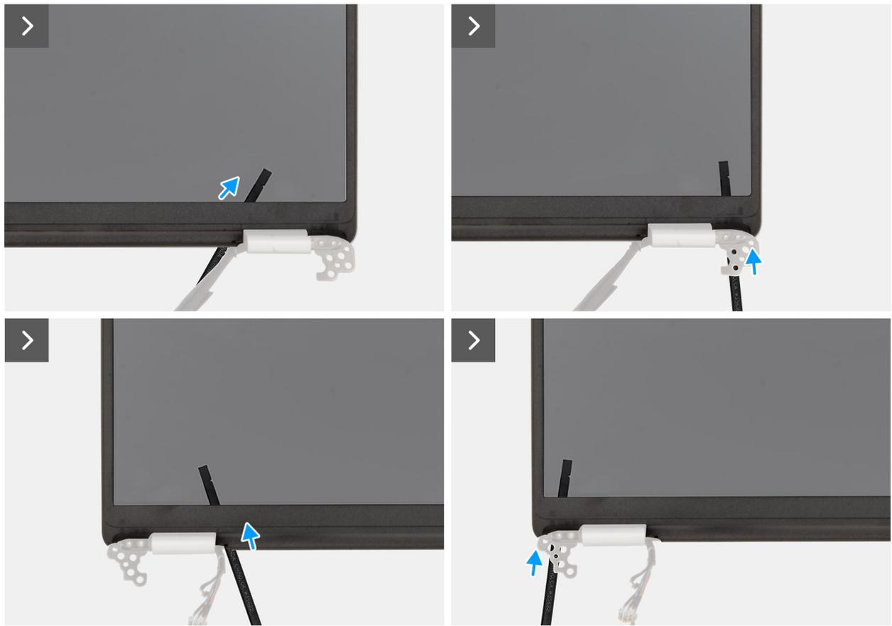
Ilustración 63. Extracción del embellecedor de la pantalla
