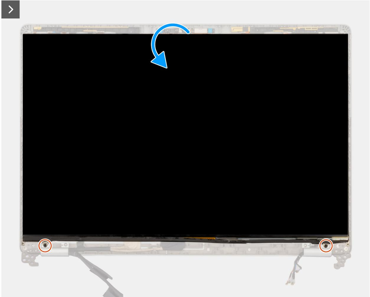
**Ilustración 67. Extracción del panel de pantalla**
