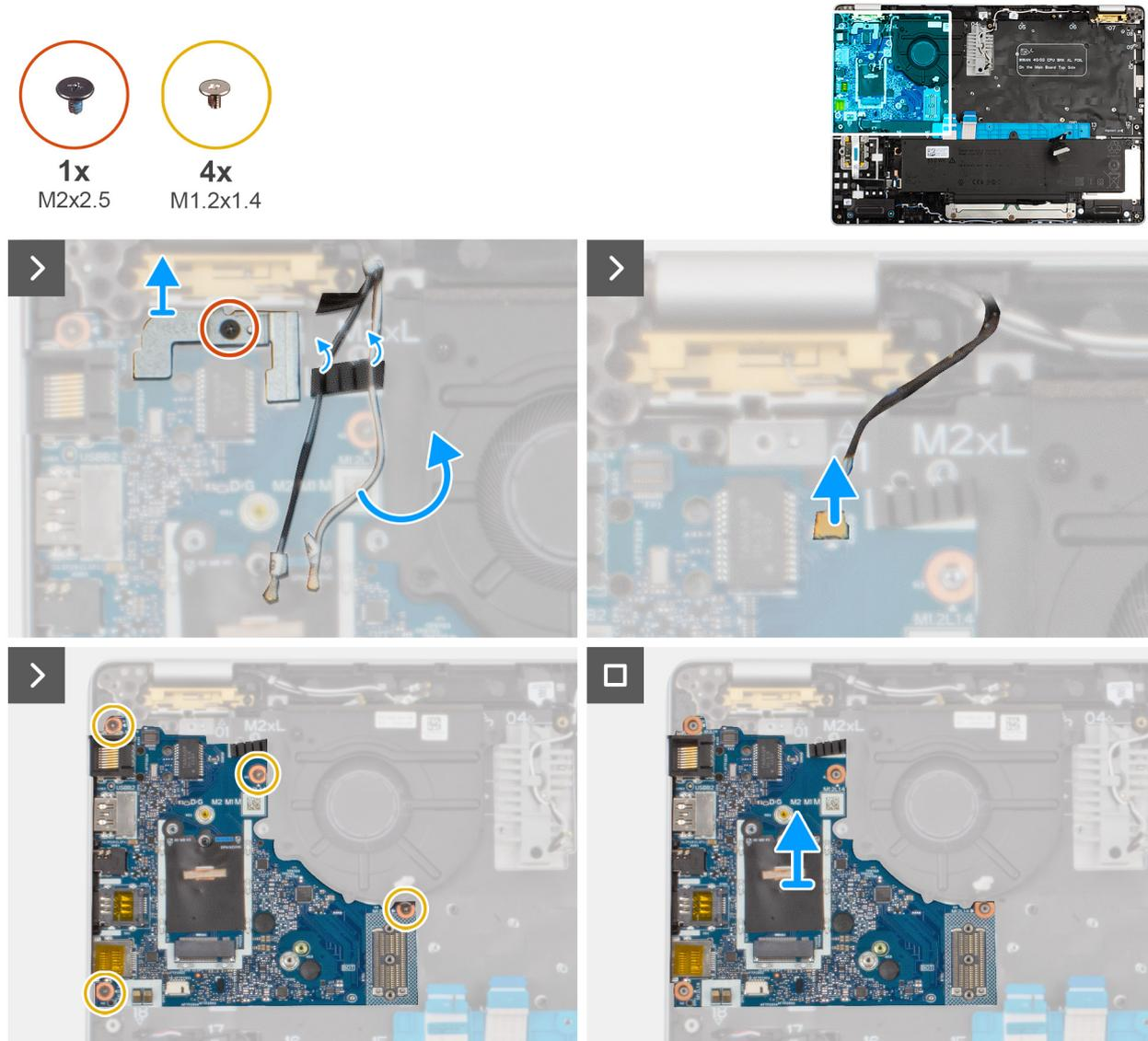
**Ilustración 55. Extracción de la placa de I/O**
