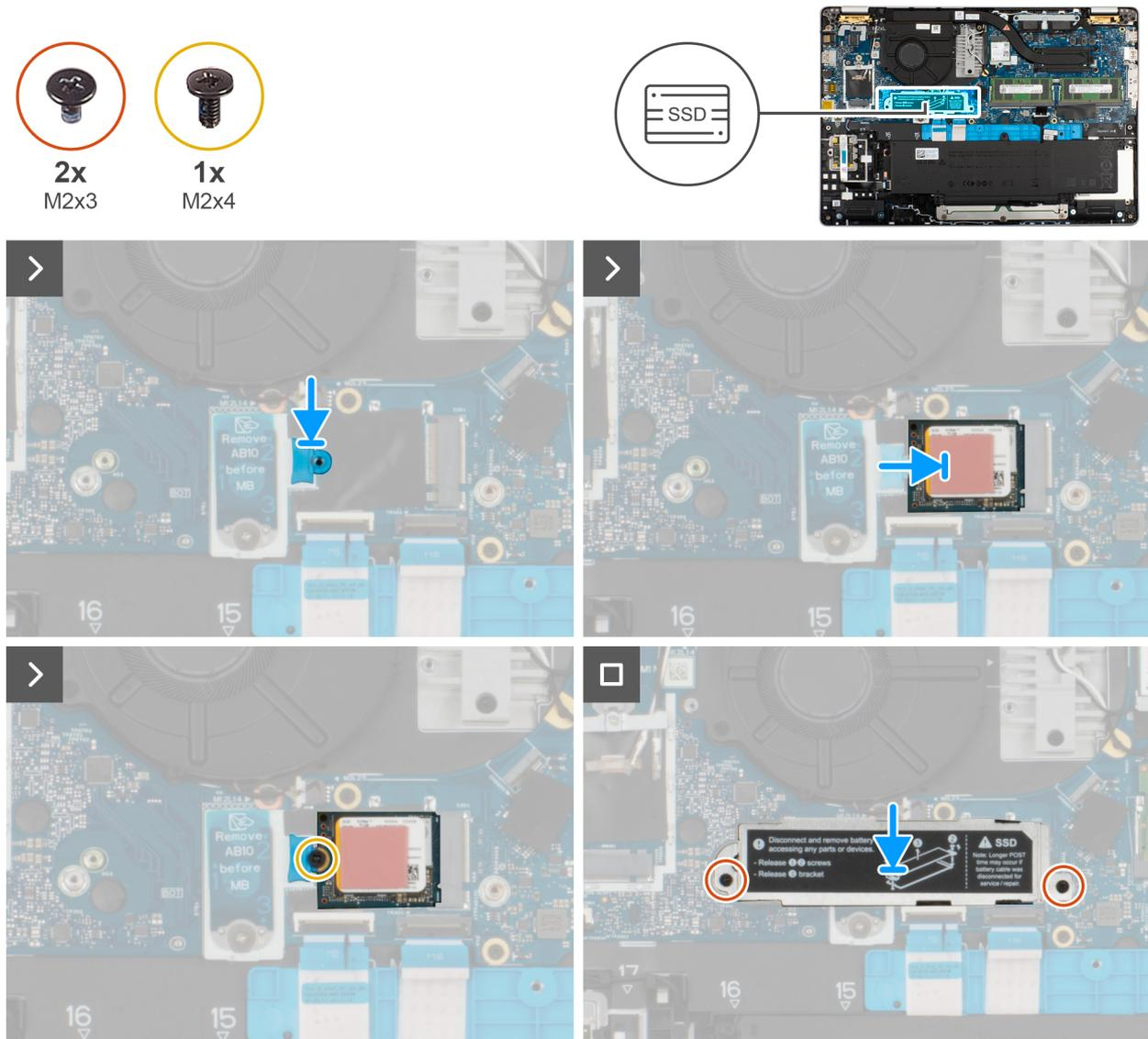
**Ilustración 25. Instalación de la SSD M.2 2230**
