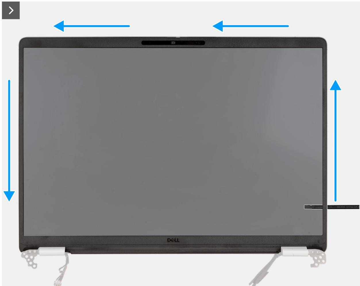
Ilustración 64. Extracción del embellecedor de la pantalla
