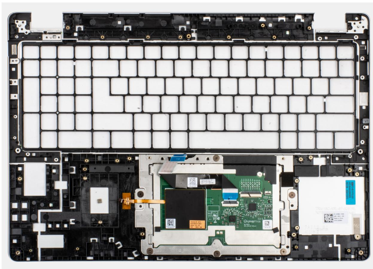
**Ilustración 87. Extracción del ensamblaje del reposamanos**
