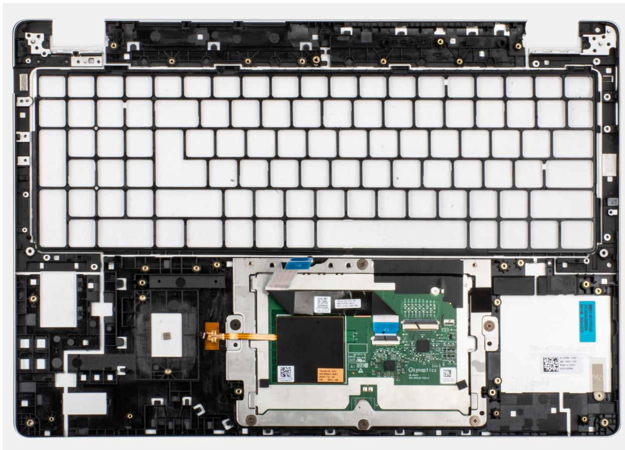
**Ilustración 88. Extracción del ensamblaje del reposamanos**
