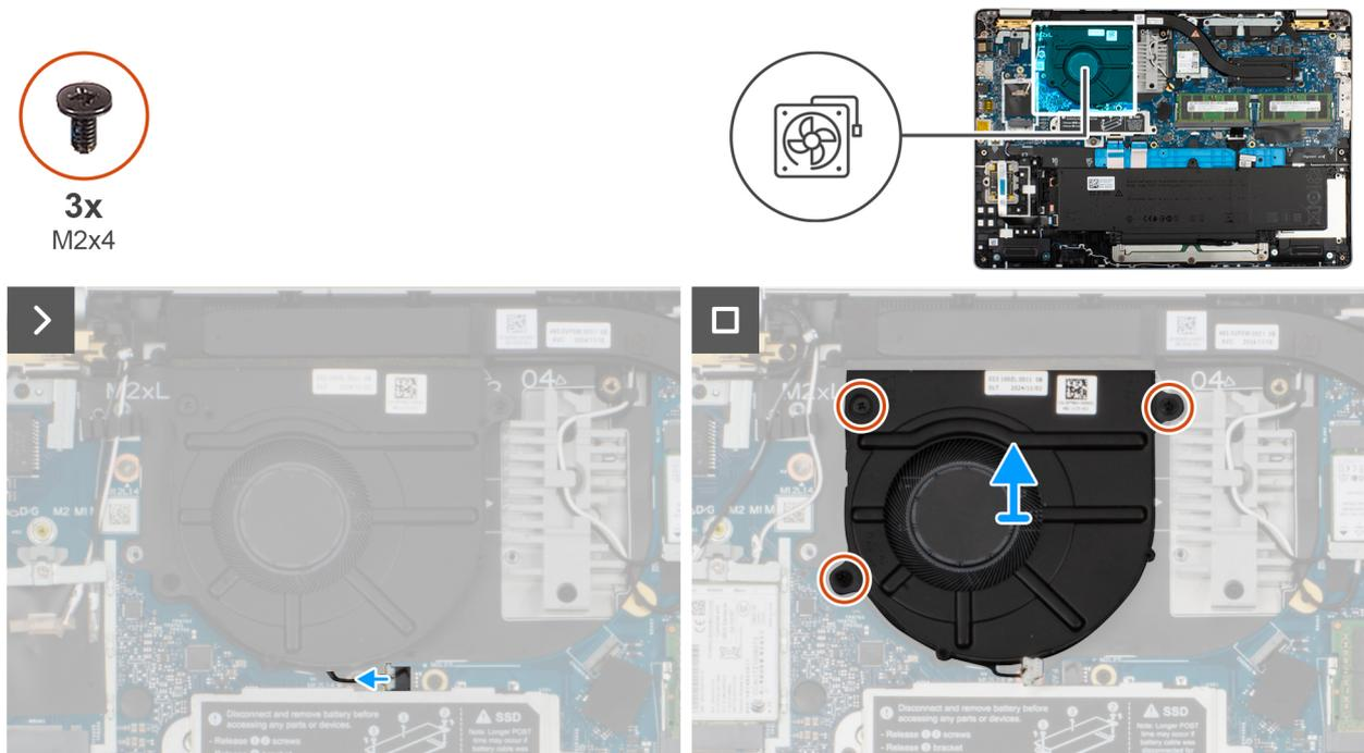
**Ilustración 35. Extracción del ventilador**
