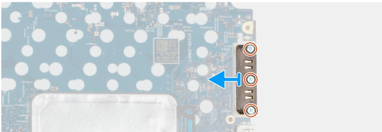
**Ilustración 79.** Extracción del módulo del conector USB Type-C
