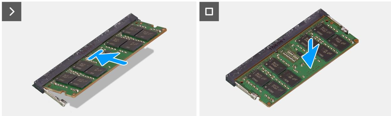
**Ilustración 23. Instalación de los módulos de memoria**
