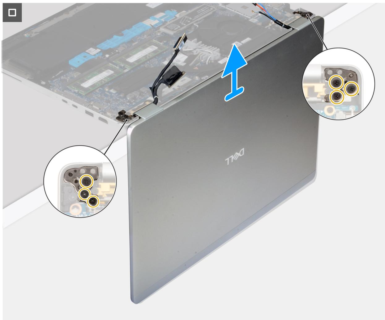
**Ilustración 59. Extracción del ensamblaje de la pantalla**
