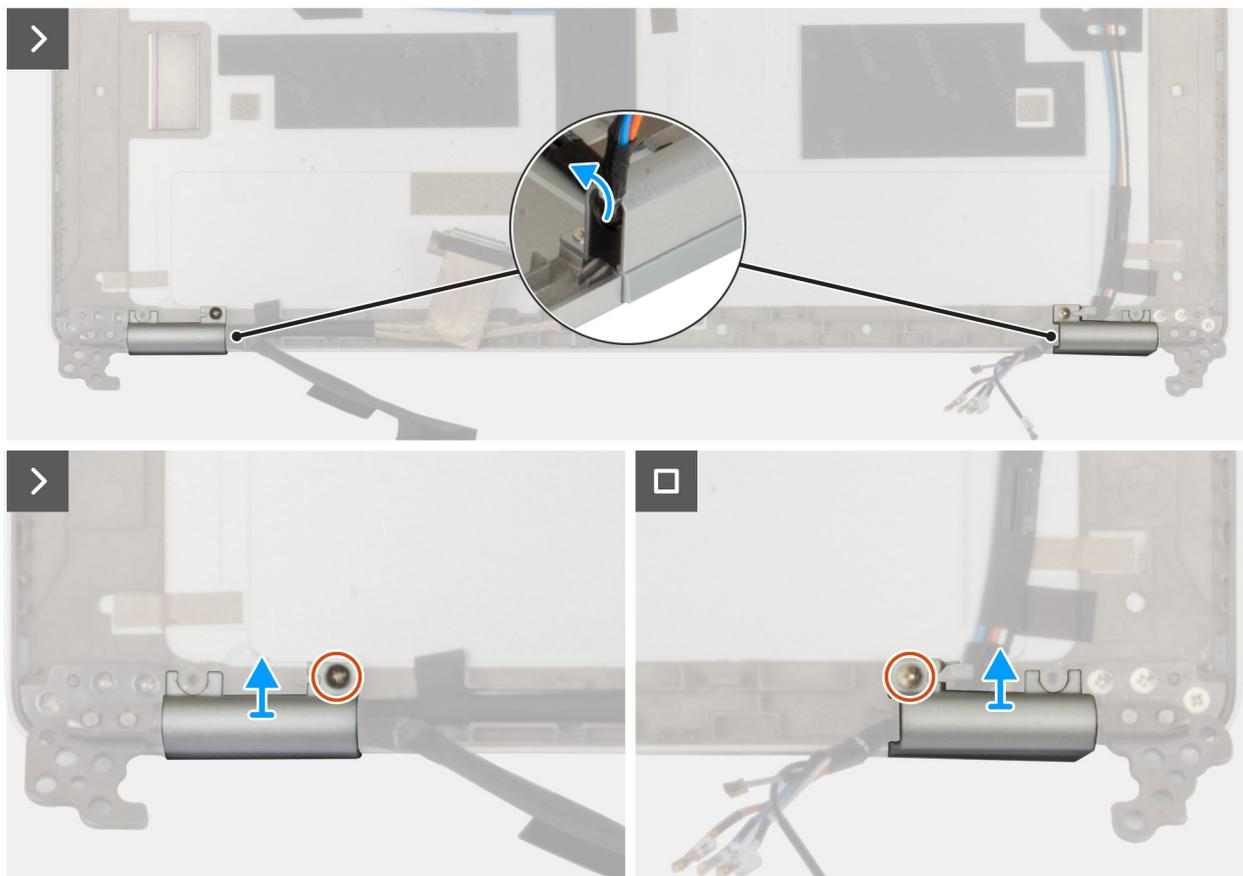
**Ilustración 71. Extracción de la tapa de las bisagras de la pantalla**
