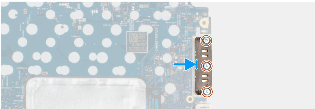
**Ilustración 80. Instalación del módulo del conector USB Type-C**
