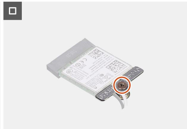
**Ilustración 34. Instalación de la tarjeta WLAN**
