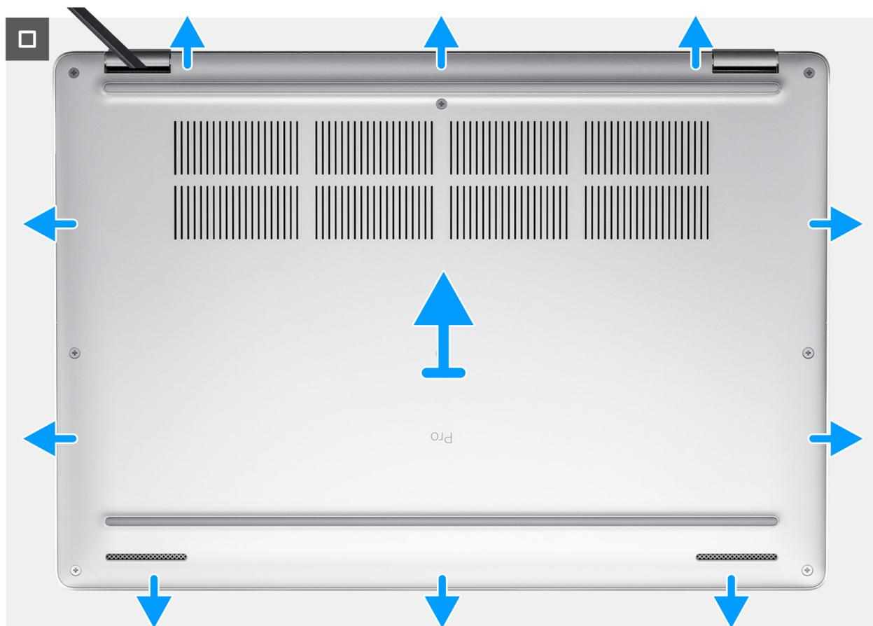
**Ilustración 14. Extracción de la cubierta de la base**
