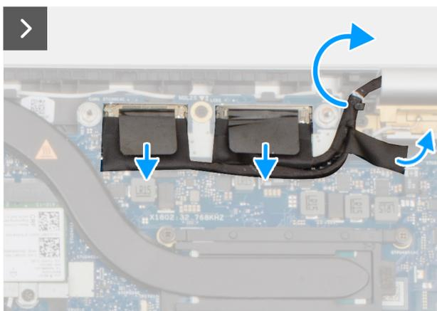
Ilustración 41. Extracción de la antena WLAN
