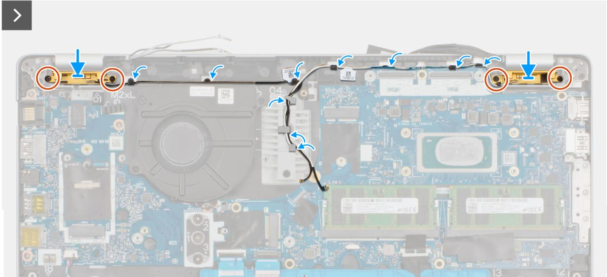
Ilustración 43. Instalación de la antena WLAN
