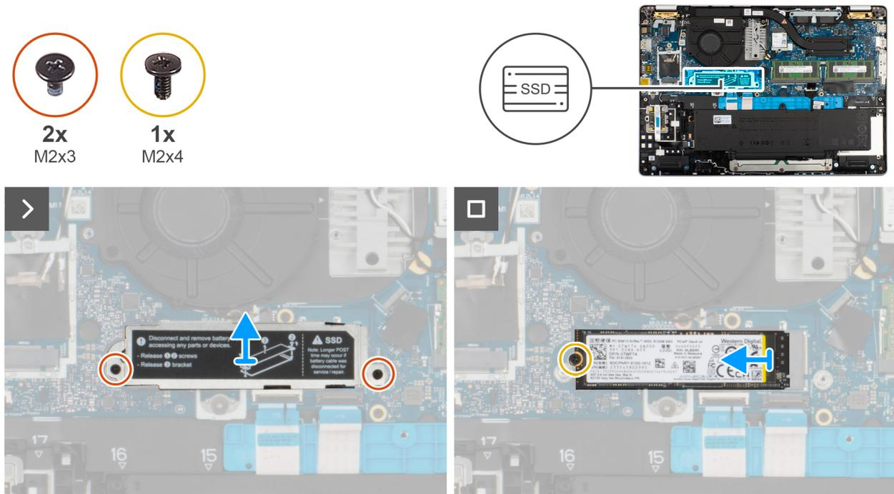
**Ilustración 26. Extracción de la SSD M.2 2230**
