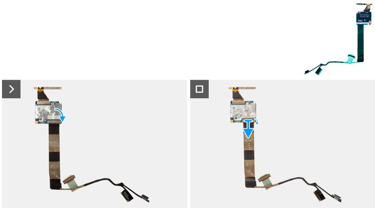
**Ilustración 73. Extracción del cable de pantalla**
