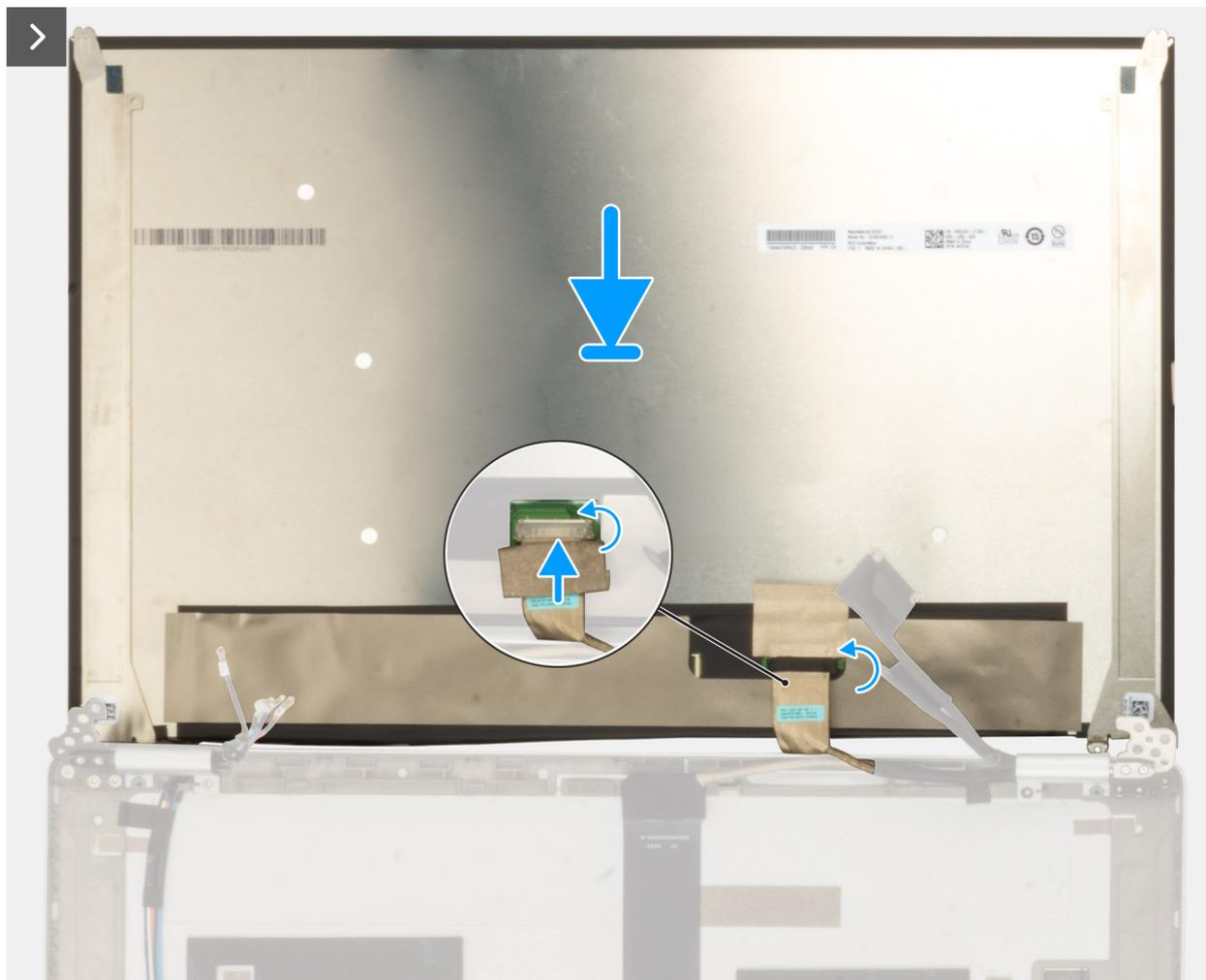
**Ilustración 69. Instalación del panel de pantalla**
