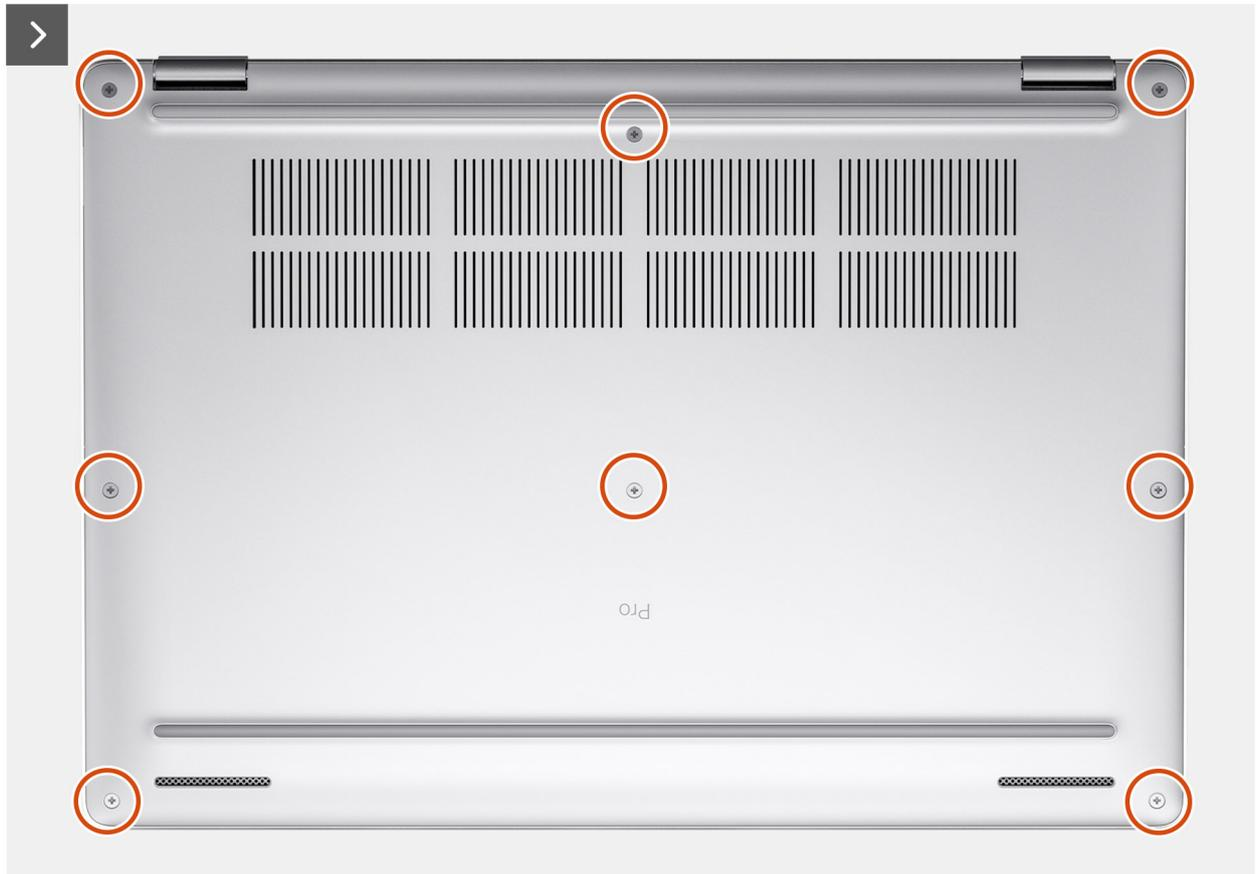
Ilustración 13. Extracción de la cubierta de la base
