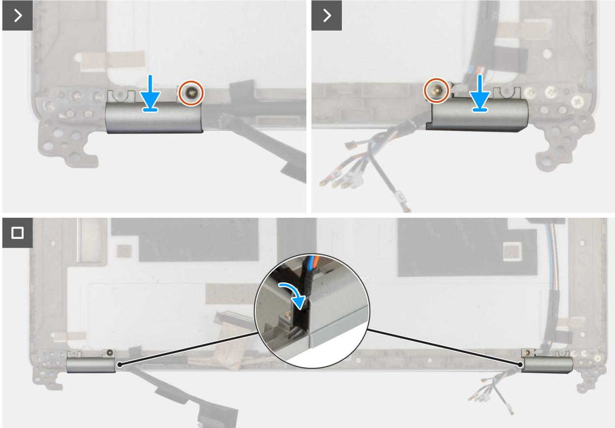
**Ilustración 72. Instalación de la tapa de la bisagra de la pantalla**
