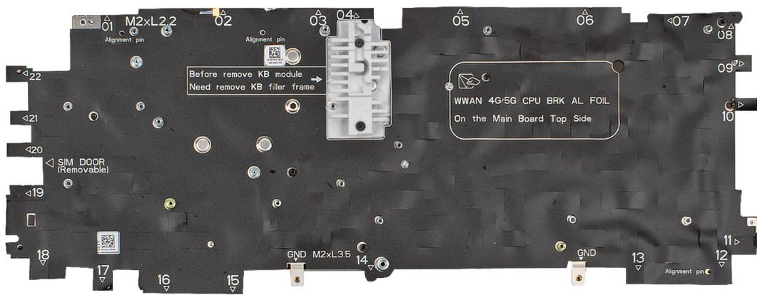
**Ilustración 84. Extracción del relleno del teclado**
