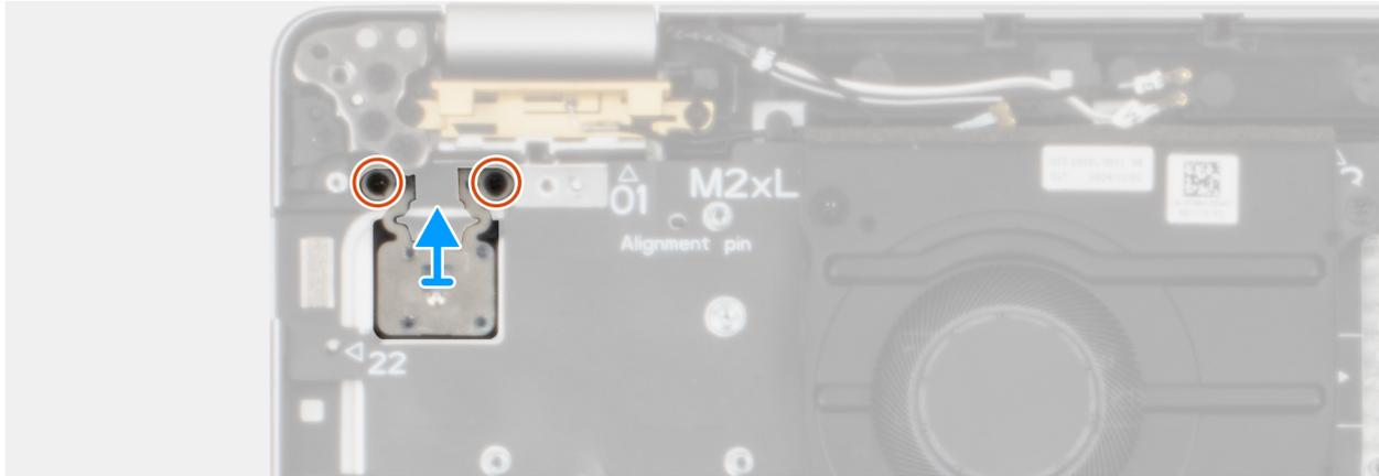
**Ilustración 56. Instalación del botón de encendido con un lector de huellas digitales opcional**
