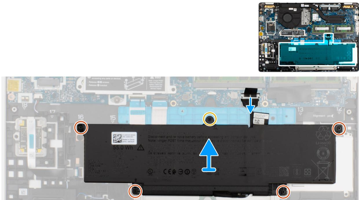
**Ilustración 15. Desconexión del cable de la batería**
