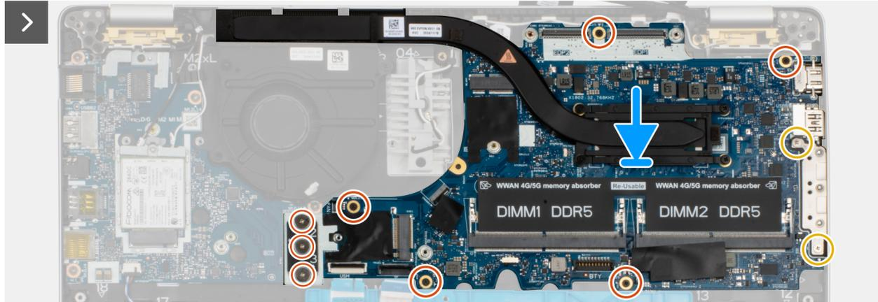
**Ilustración 53. Instalación de la tarjeta madre**
