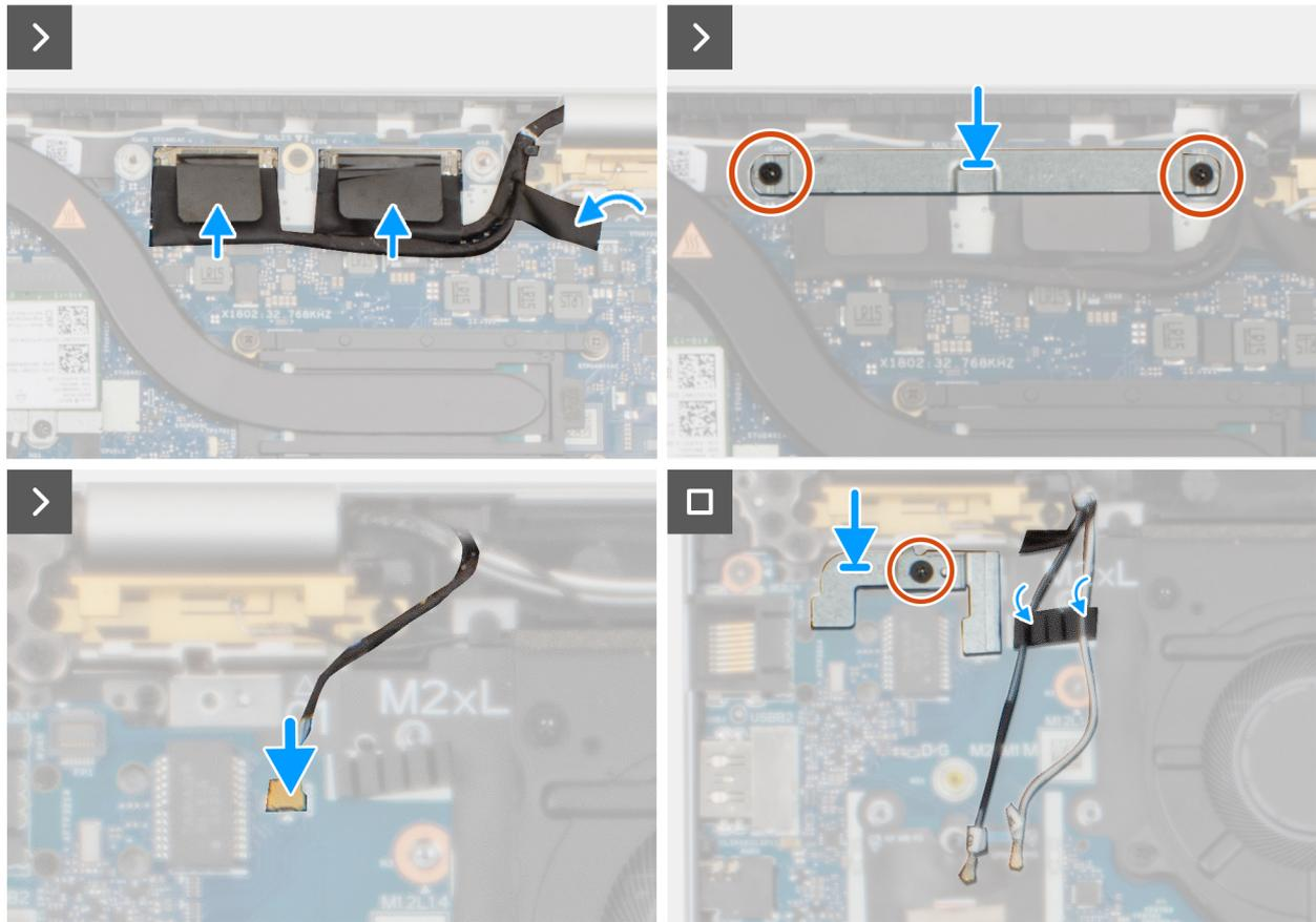
**Ilustración 44. Instalación de la antena WLAN**
