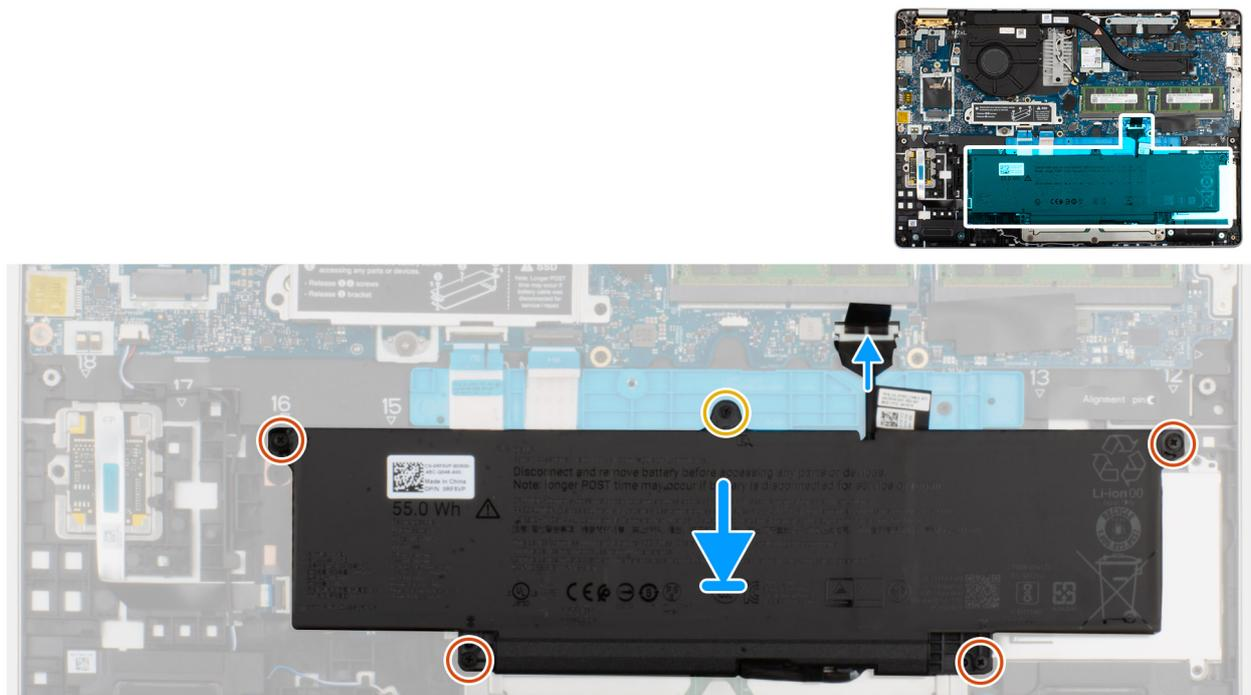
Ilustración 16. Conexión del cable de la batería
