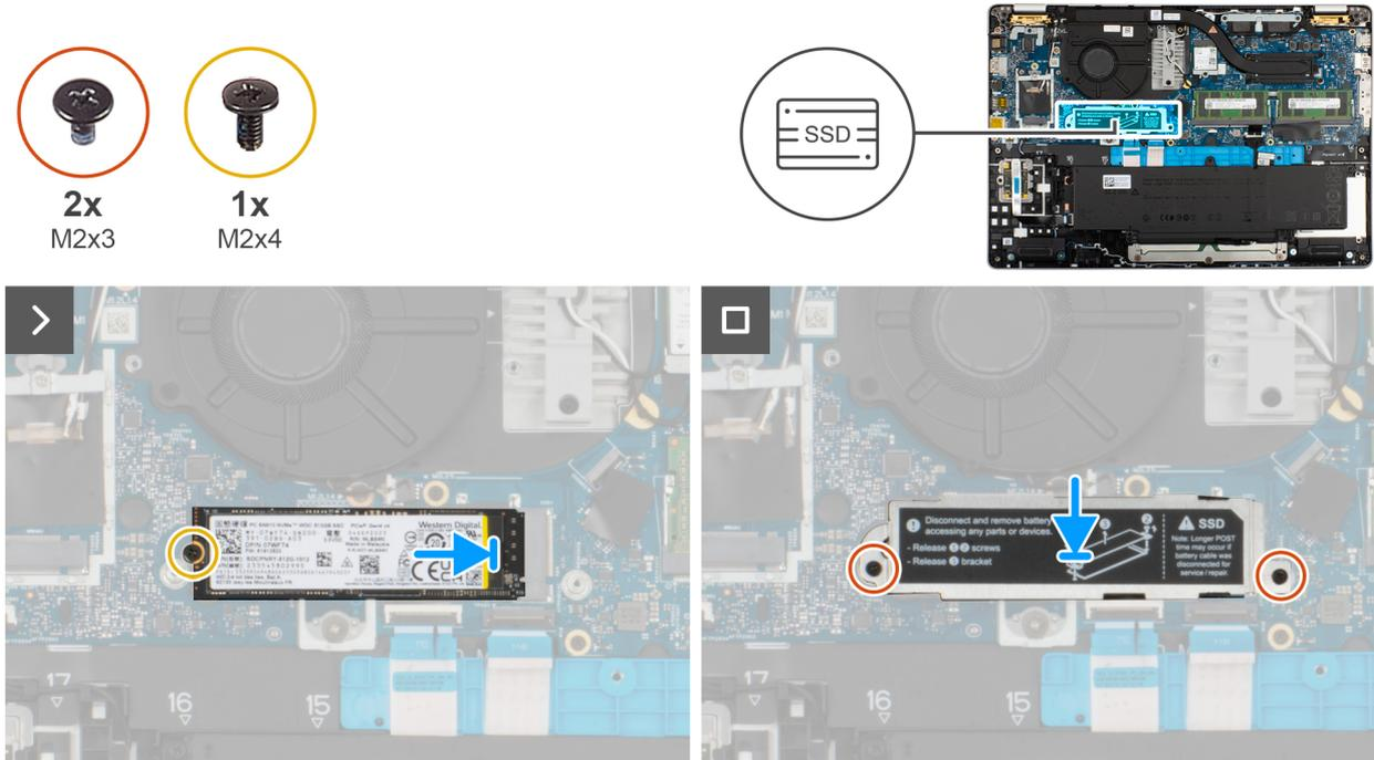
**Ilustración 28. Instalación de la SSD M.2230**
