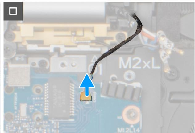
Ilustración 58. Extracción del ensamblaje de la pantalla
