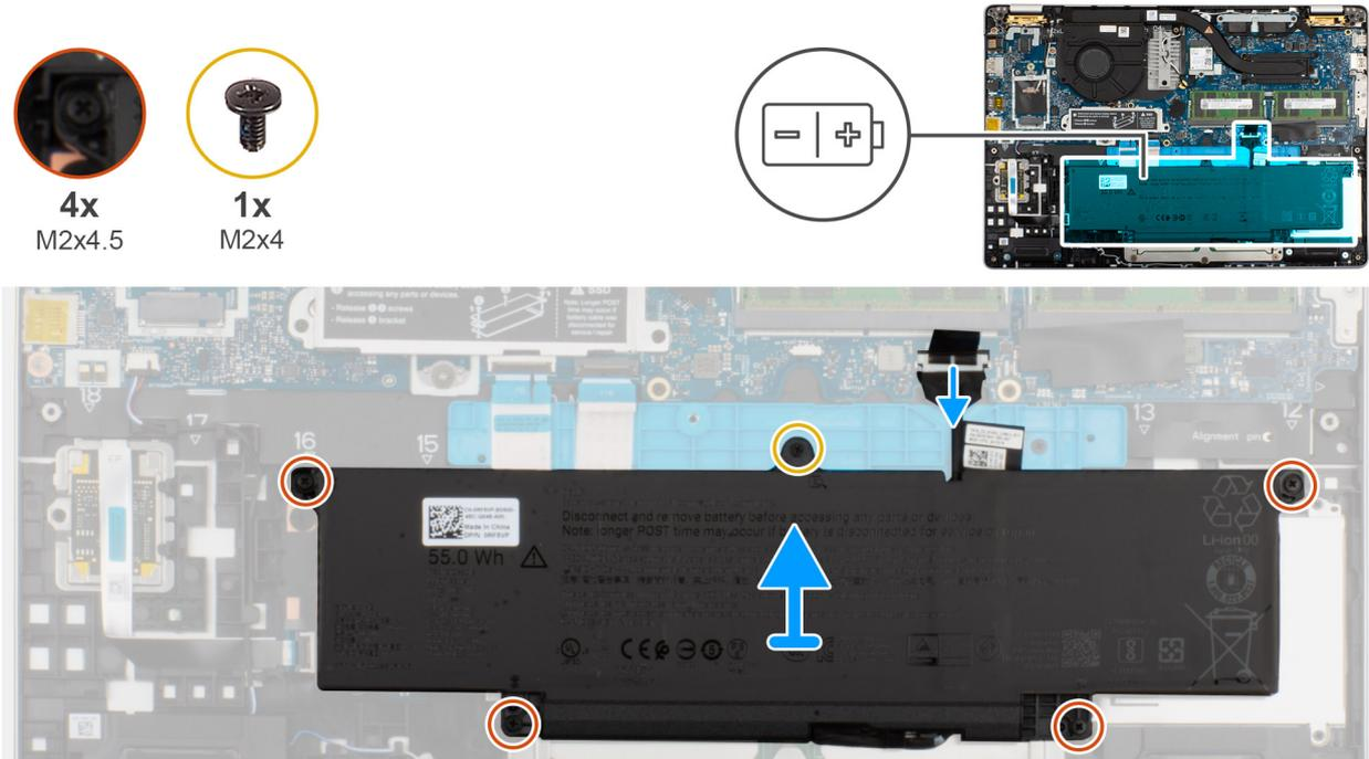
Ilustración 18. Extracción de la batería
