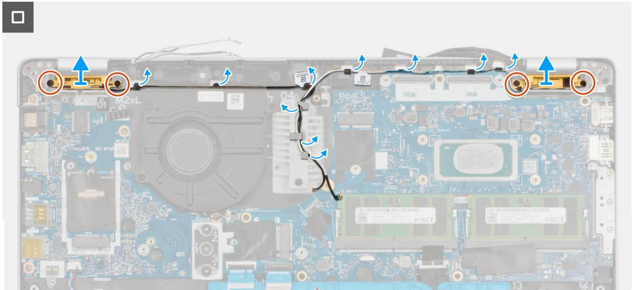
**Ilustración 42. Extracción de la antena WLAN**
