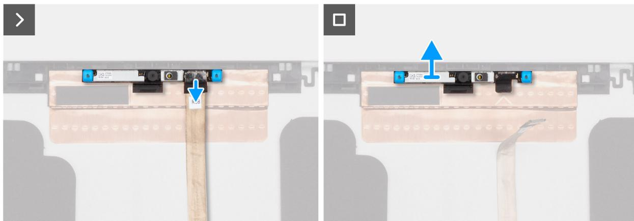
**Ilustración 75. Extracción del módulo de la cámara**
