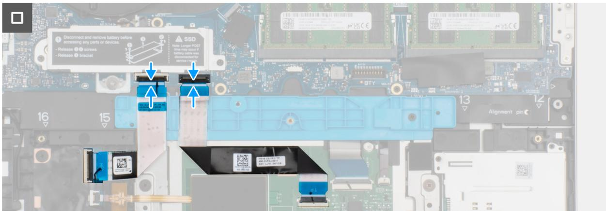
**Ilustración 46. Instalación del soporte de la batería**
