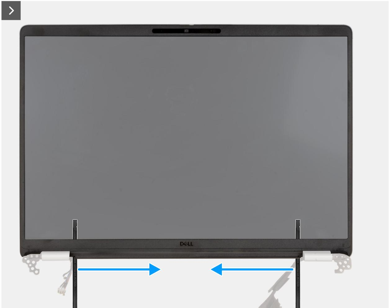
Ilustración 62. Hacer palanca en el bisel por los lados
