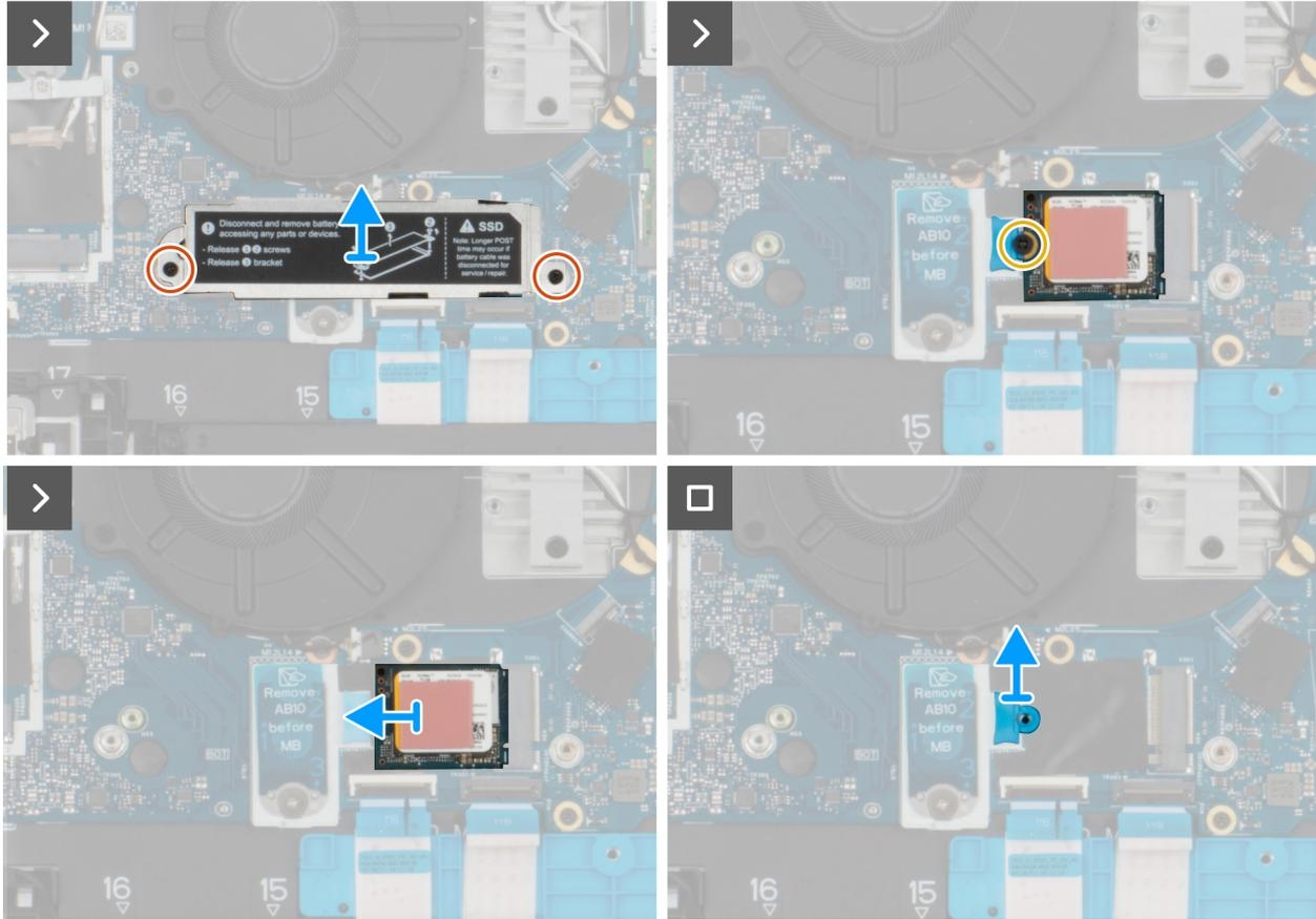
**Ilustración 24. Extracción de la SSD M.2 2230**
