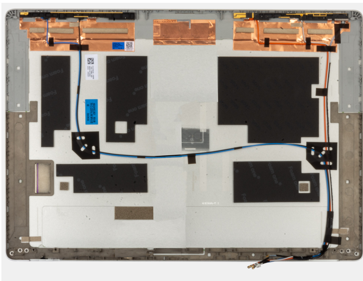
Ilustración 75. Extracción de la cubierta posterior de la pantalla
