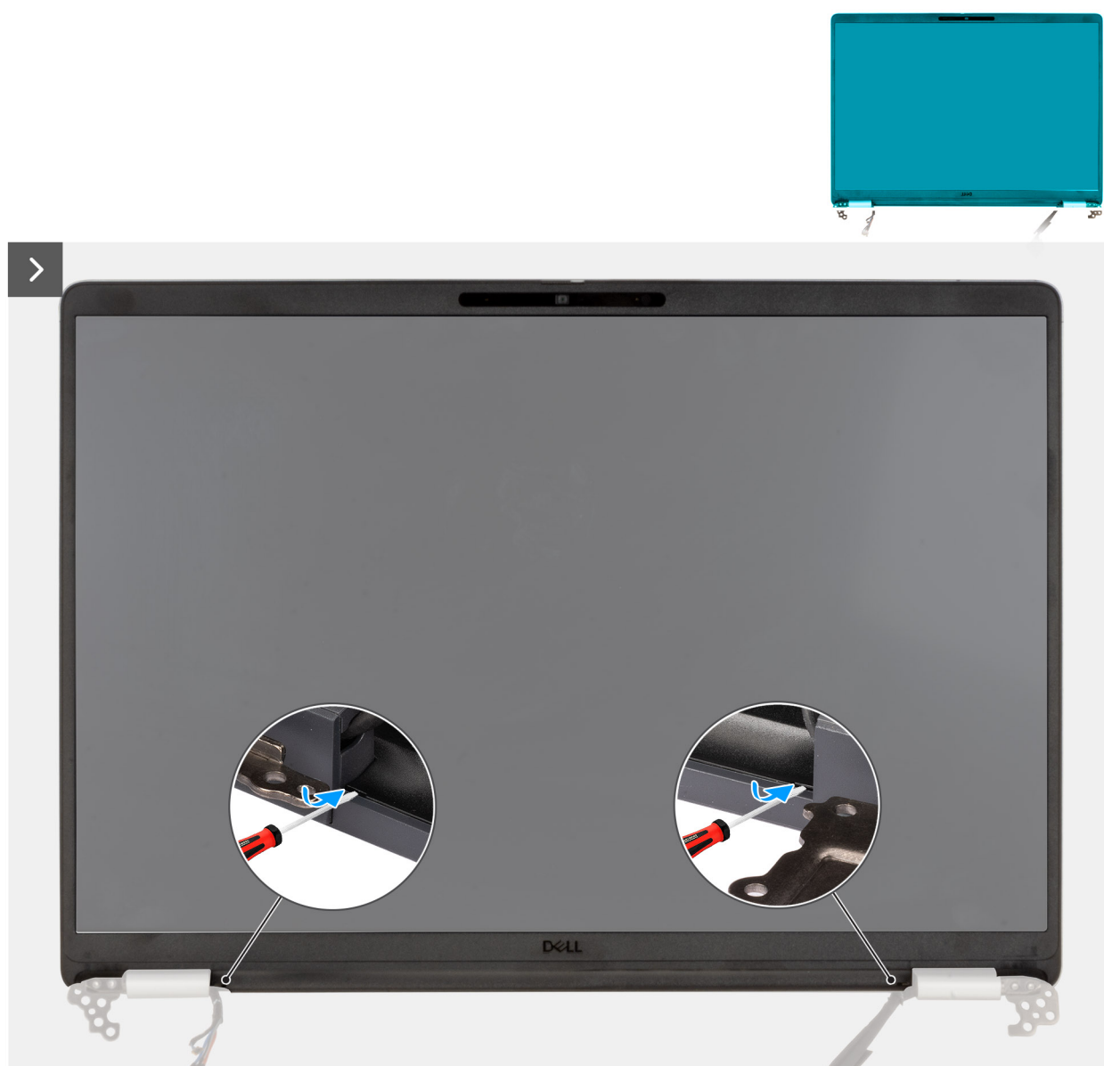
Ilustración 64. Hacer palanca en el bisel de plástico
