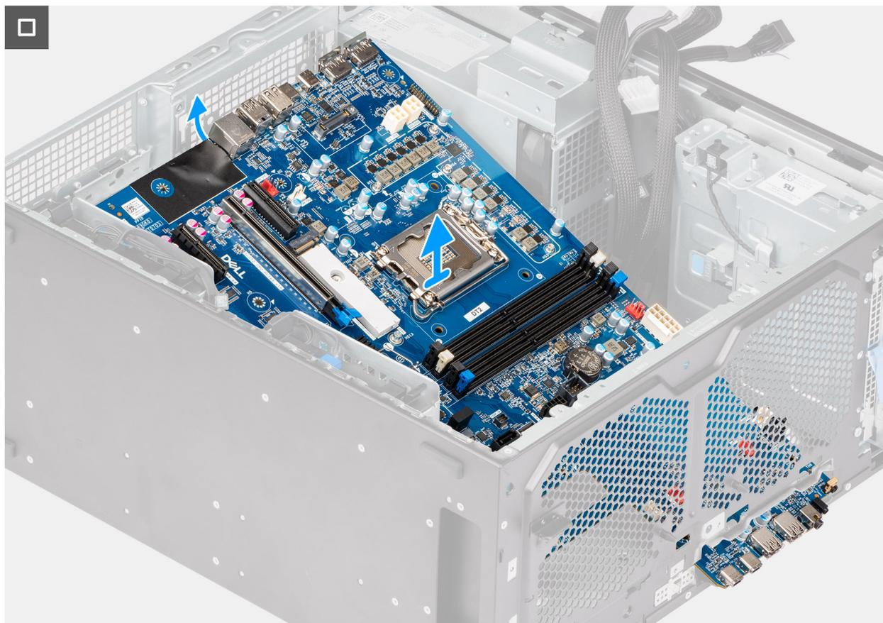
**Figura 92. Retirar a placa de sistema**
