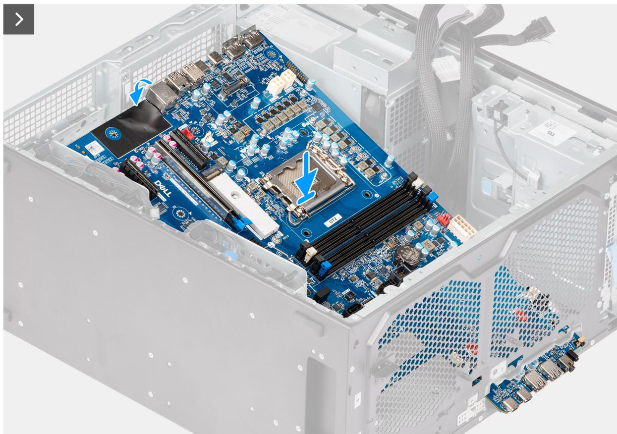
Figura94. Instalar a placa de sistema
