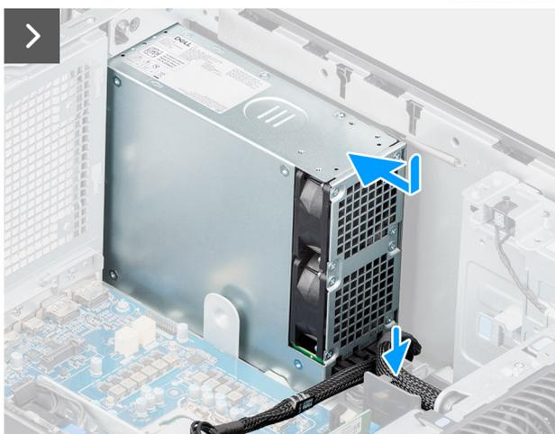
Figura55. Instalar a unidade de fonte de alimentação de 1500 W
