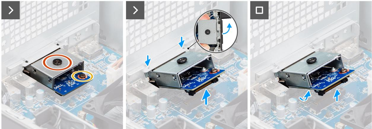
**Figura85. Remover o módulo VGA opcional**
