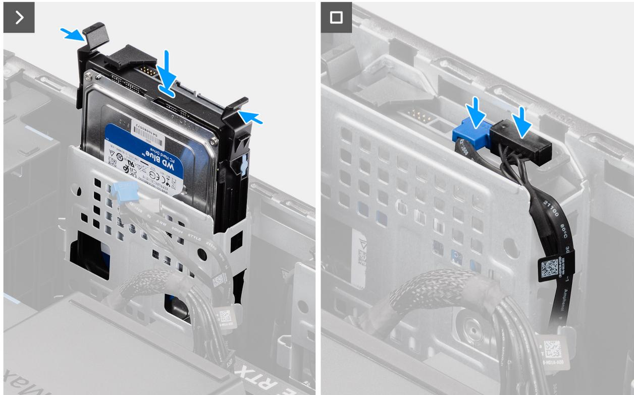
Figura30. Instalar o conjunto do disco rígido de 3,5 polegadas do Compartimento 1
