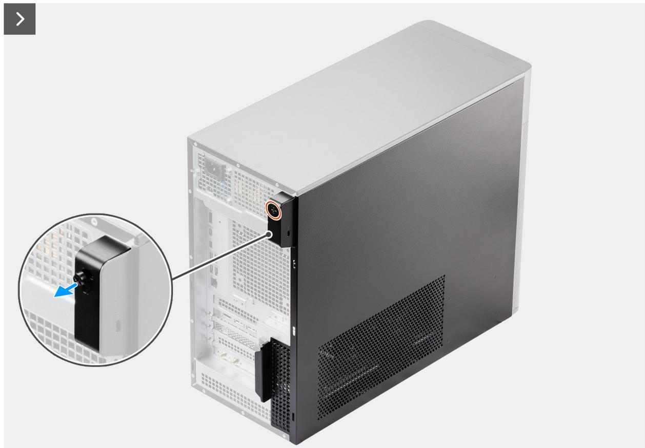
Ilustración 9. Extracción de la cubierta lateral
