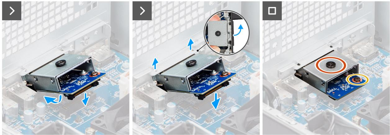
**Ilustración 87. Instalación del módulo VGA opcional**
