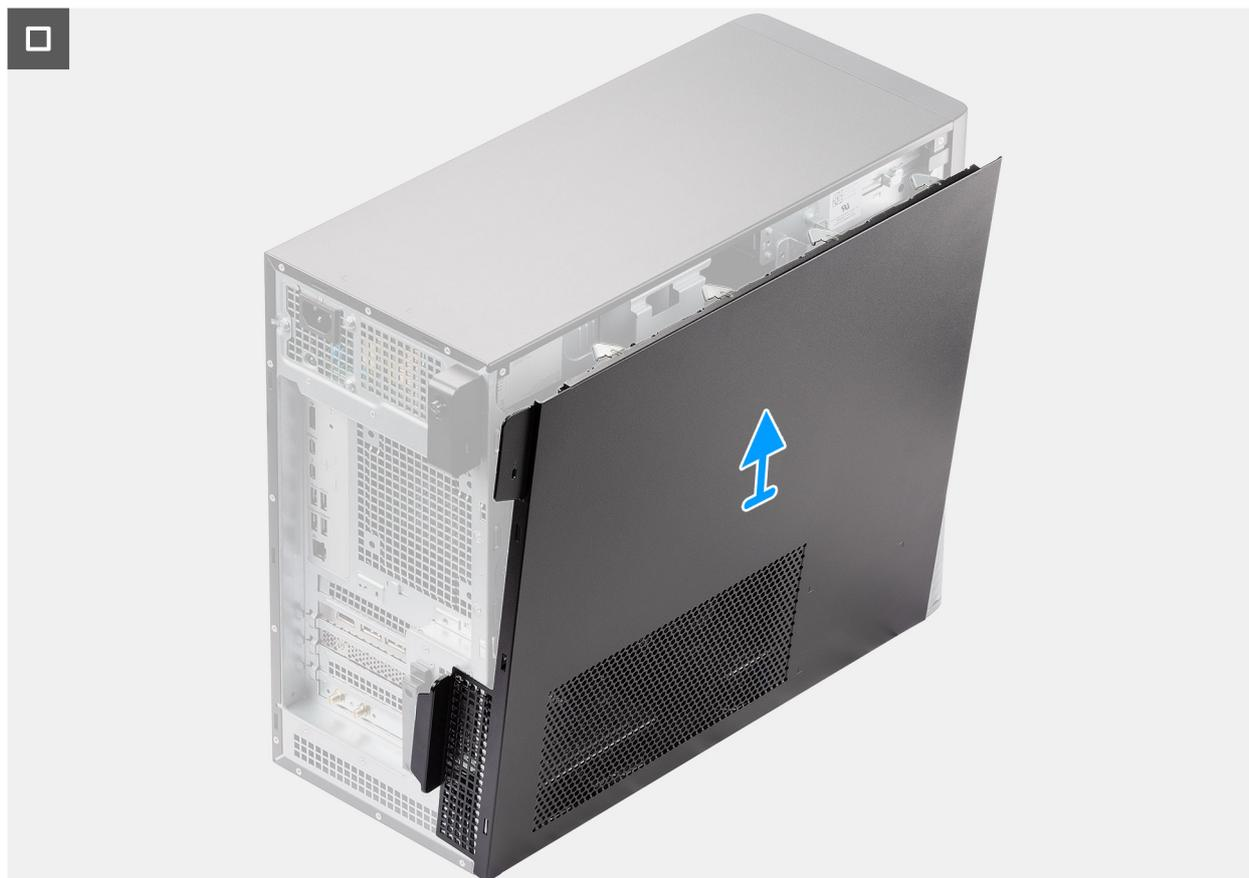
**Ilustración 10. Extracción de la cubierta lateral**
