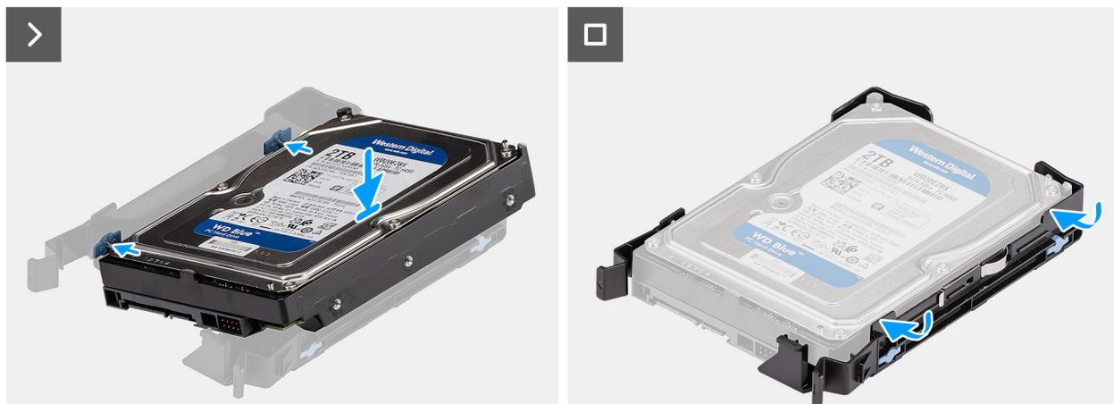
**Ilustración 28. Instalación del soporte de disco duro de 3,5 pulgadas**
