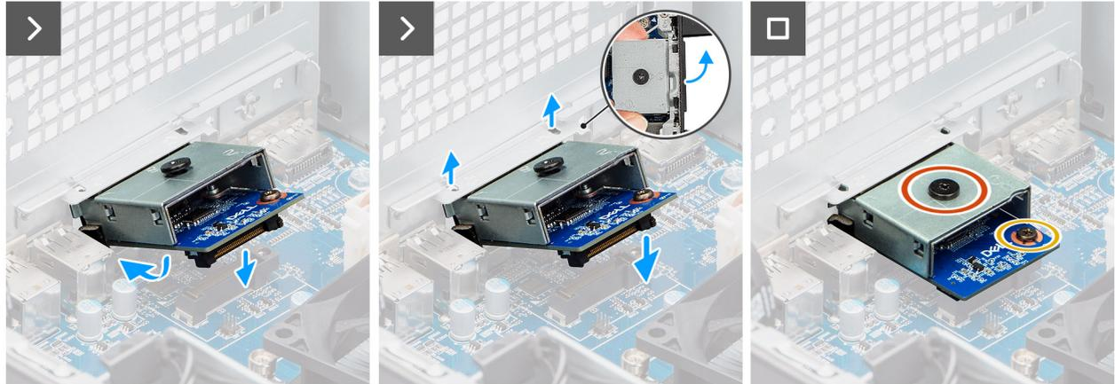
**Ilustración 72. Instalación del módulo HDMI opcional**
