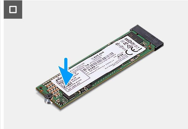
**Ilustración 34. Instalación de la unidad de estado sólido PCIe M.2 2280**
