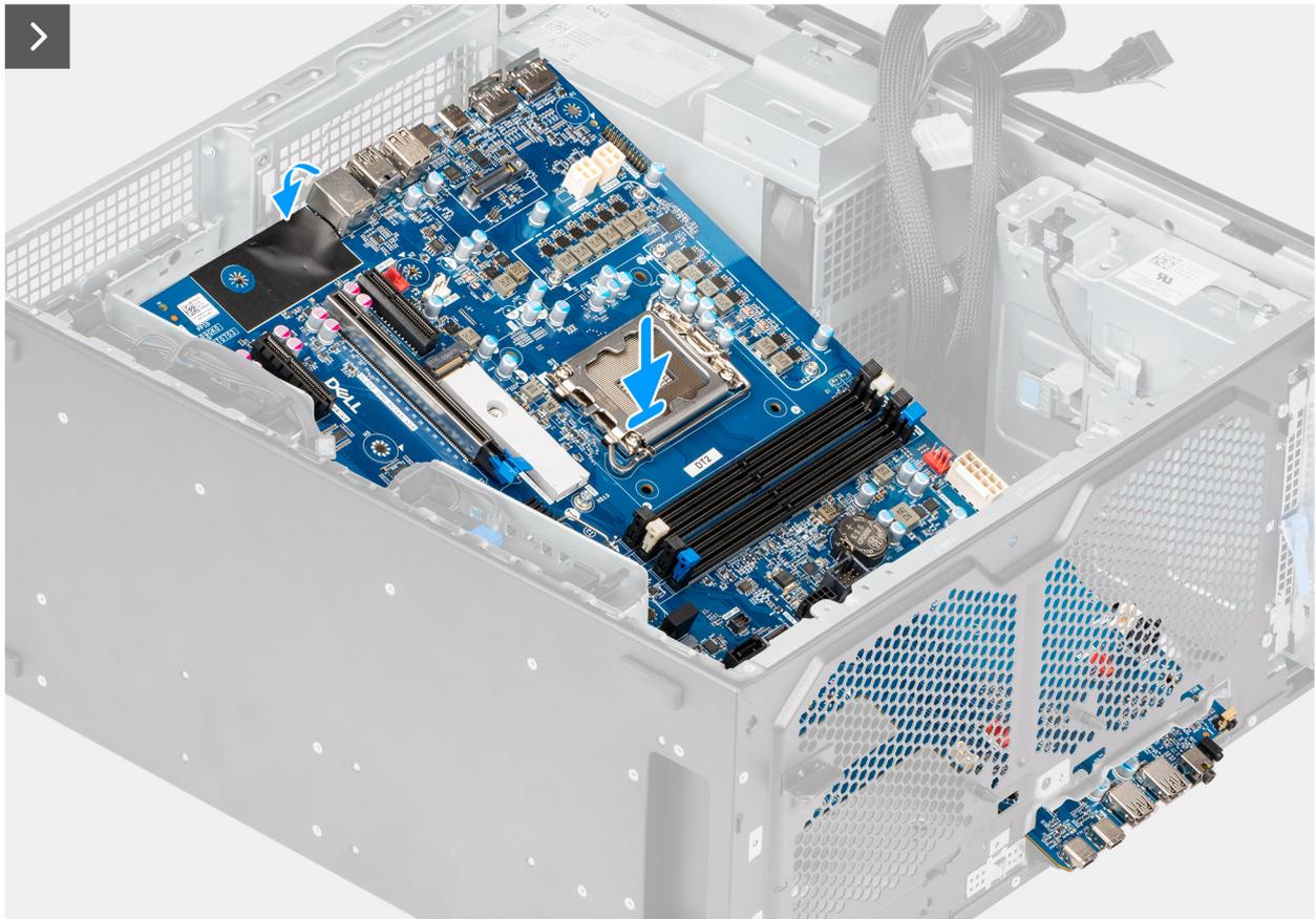
Ilustración 94. Instalación de la tarjeta madre
