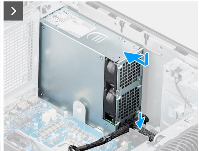
Ilustración 55. Instalación de la fuente de alimentación de 1500 W
