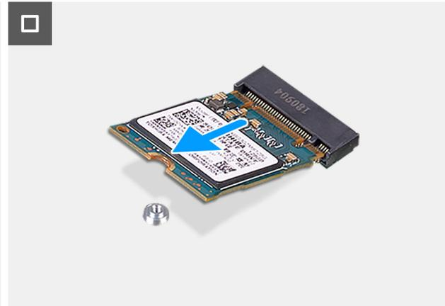
**Ilustración 31. Extracción de la unidad de estado sólido PCIe M.2 2230**
