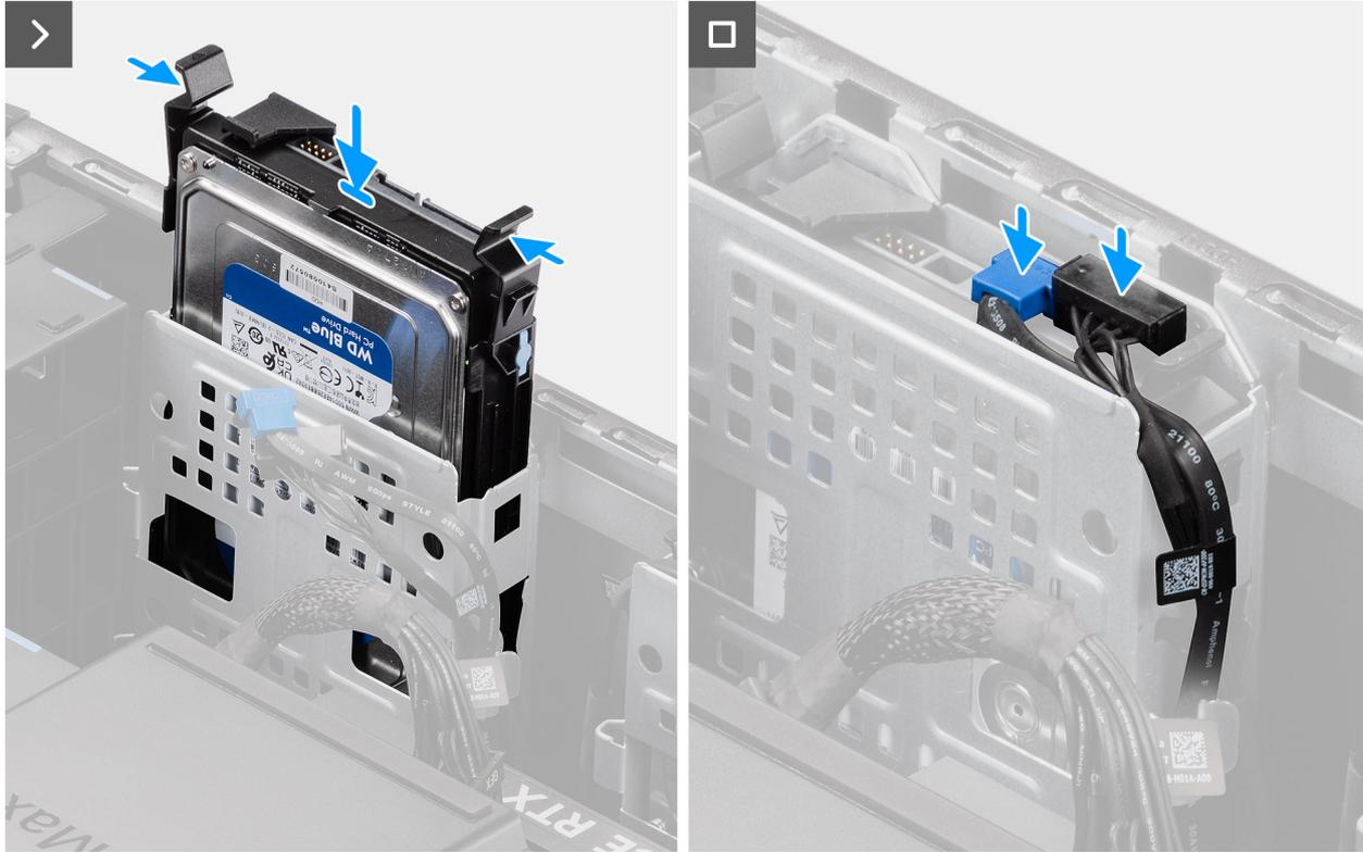
**Ilustración 30. Instalación del ensamblaje de disco duro de 3,5 pulgadas desde la bahía 1**
