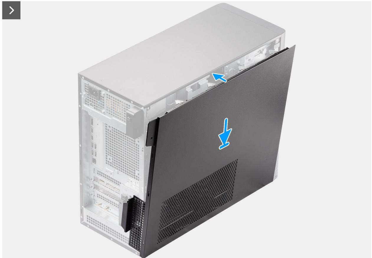
Ilustración 11. Instalación de la cubierta lateral
