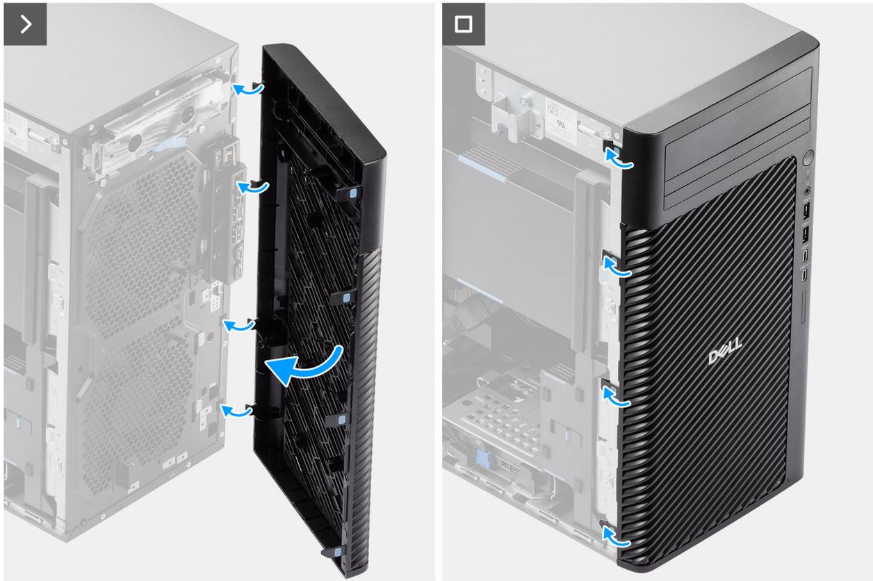
**Ilustración 18. Instalación del bisel frontal**
