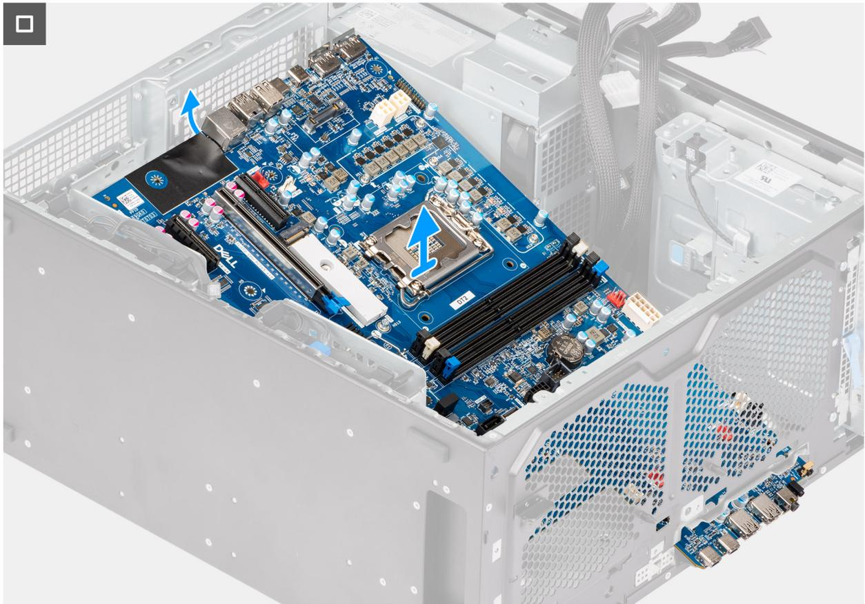
**Figura 92. Rimozione della scheda di sistema**
