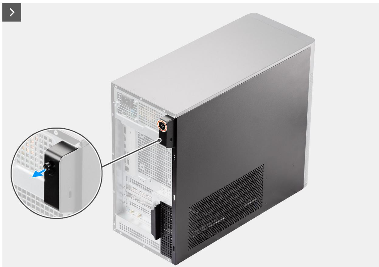
Figura 9. Rimozione del coperchio laterale
