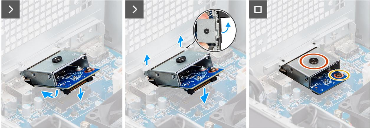
Figura 87. Installare il modulo VGA opzionale.
