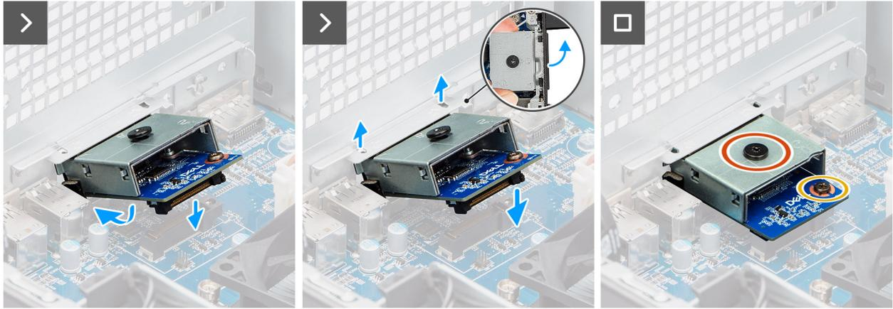
Figura 72. Installare il modulo HDMI opzionale.
