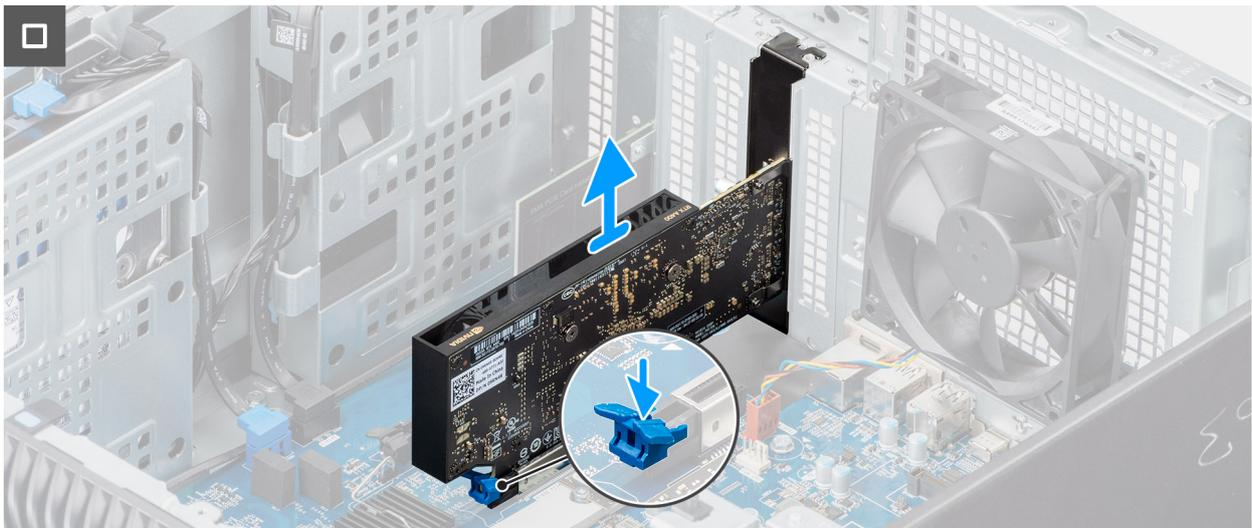
**Figura 37. Rimozione della scheda grafica**
