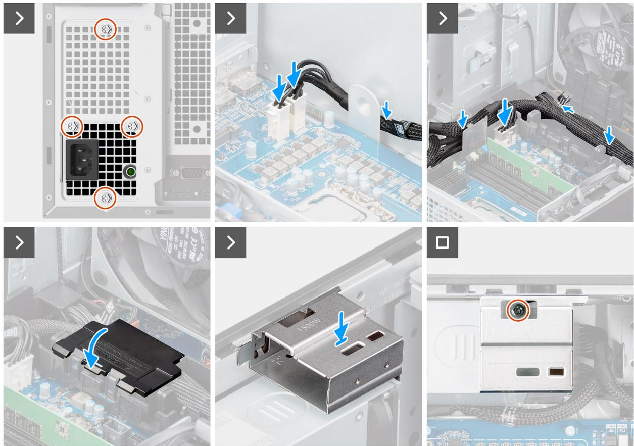
**Figura 56. Installazione dell'unità di alimentazione da 1500 W**
