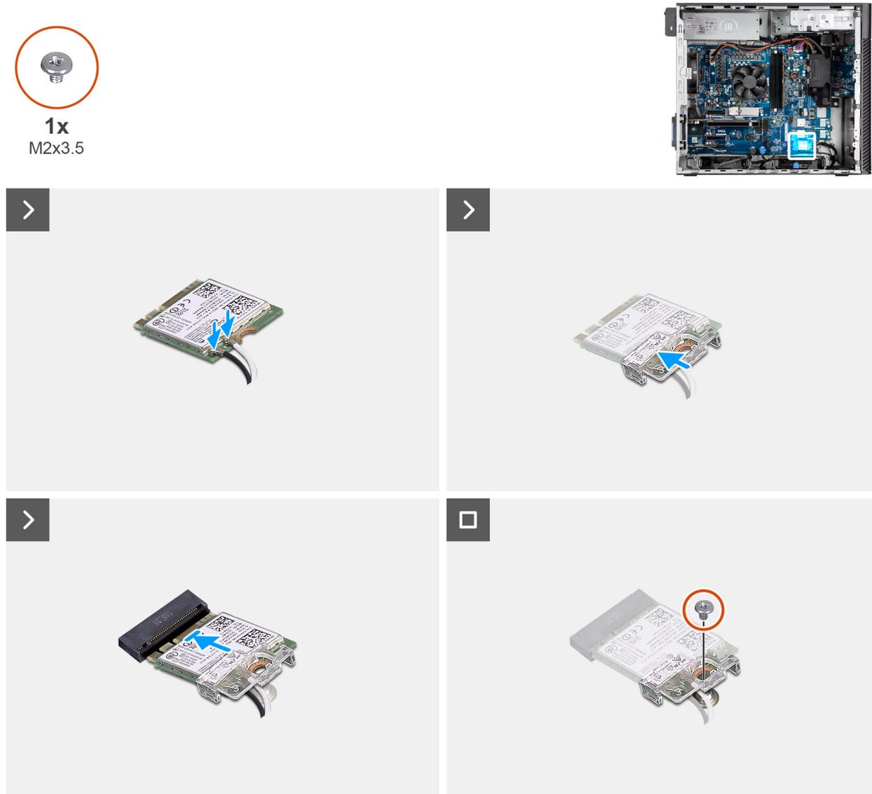
Figura 42. Installazione della scheda wireless
