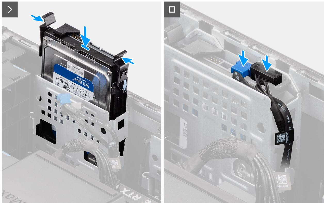
Figura 30. Installazione del gruppo del disco rigido da 3,5 pollici dall'alloggiamento 1
