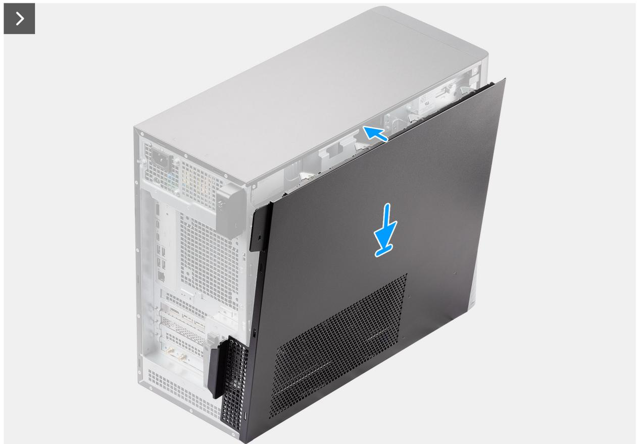
Figura 11. Installazione del coperchio laterale
