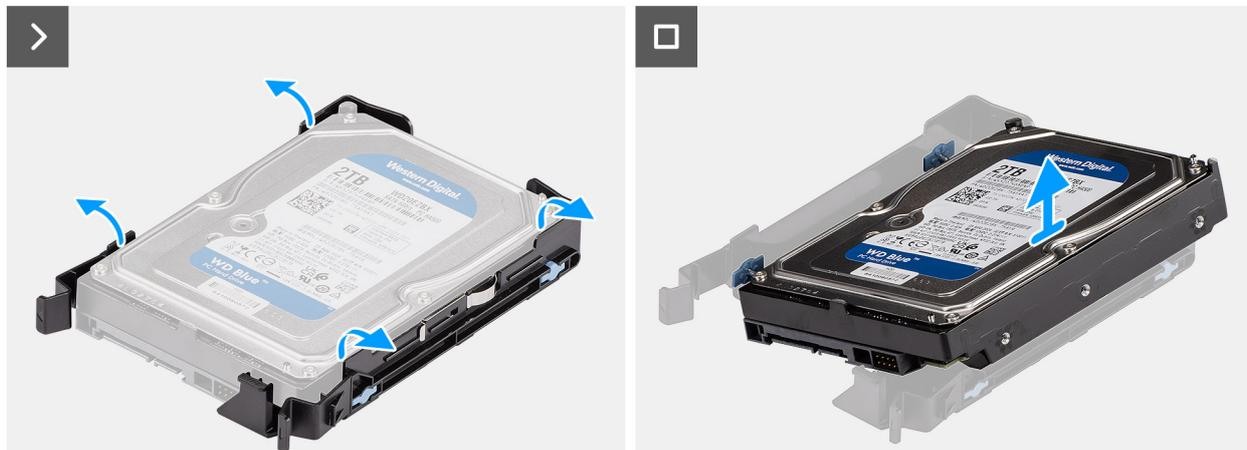
Figura 27. Rimozione della staffa dell'unità del disco rigido da 3,5 pollici
