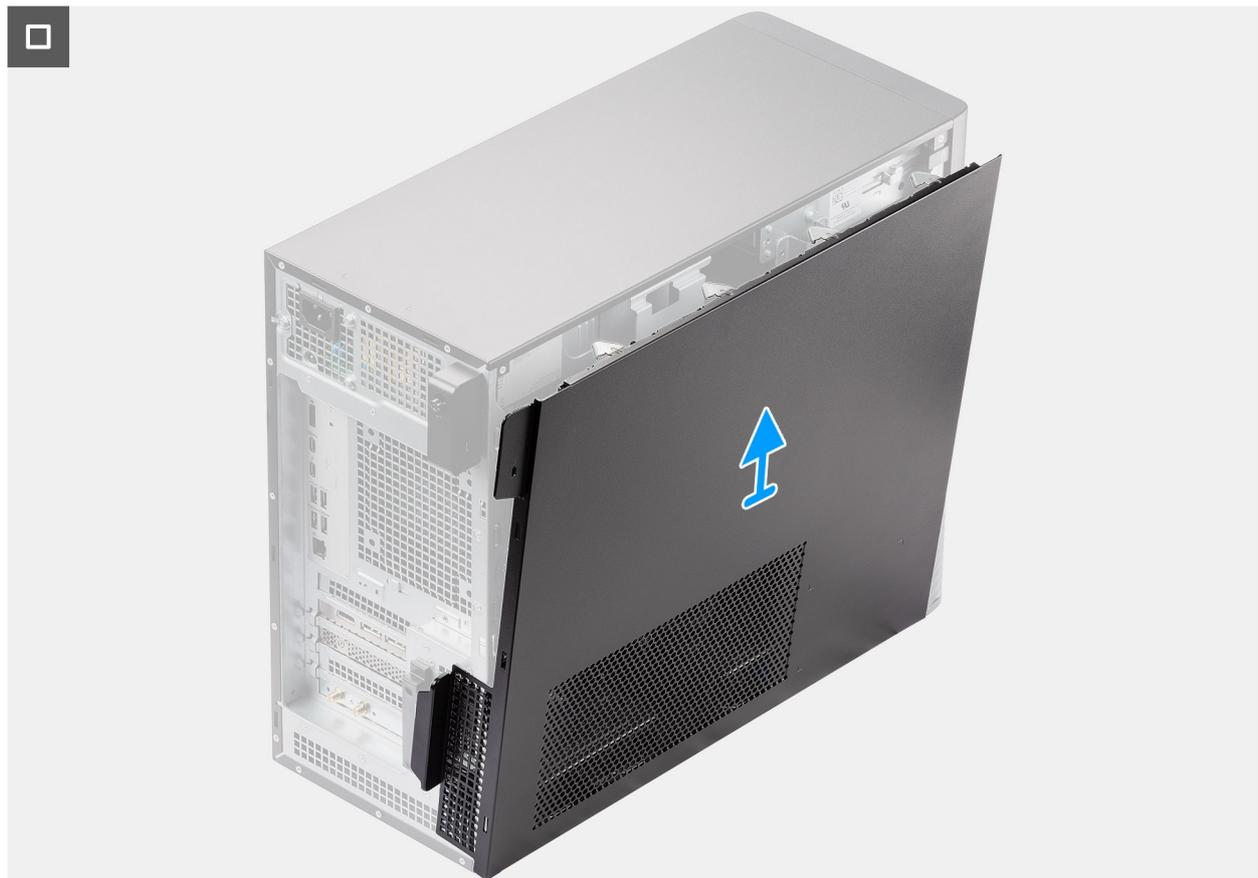
**Figura 10. Rimozione del coperchio laterale**
