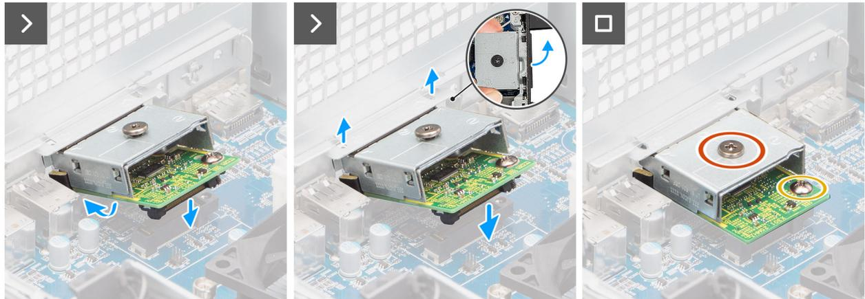
Figura 69. Installare il modulo DisplayPort opzionale.
