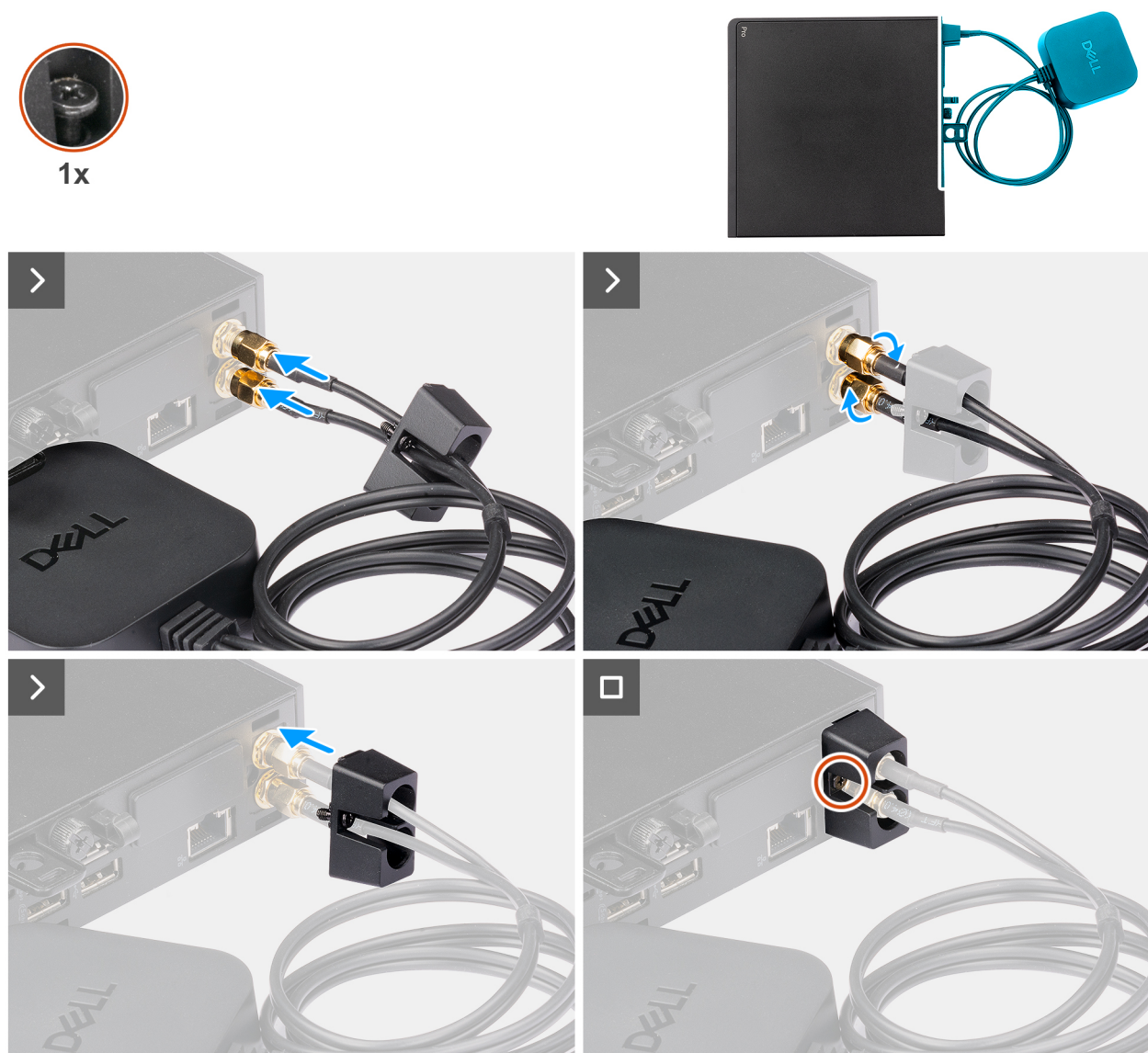
Figure 35. Installation de l'antenne Puck externe
