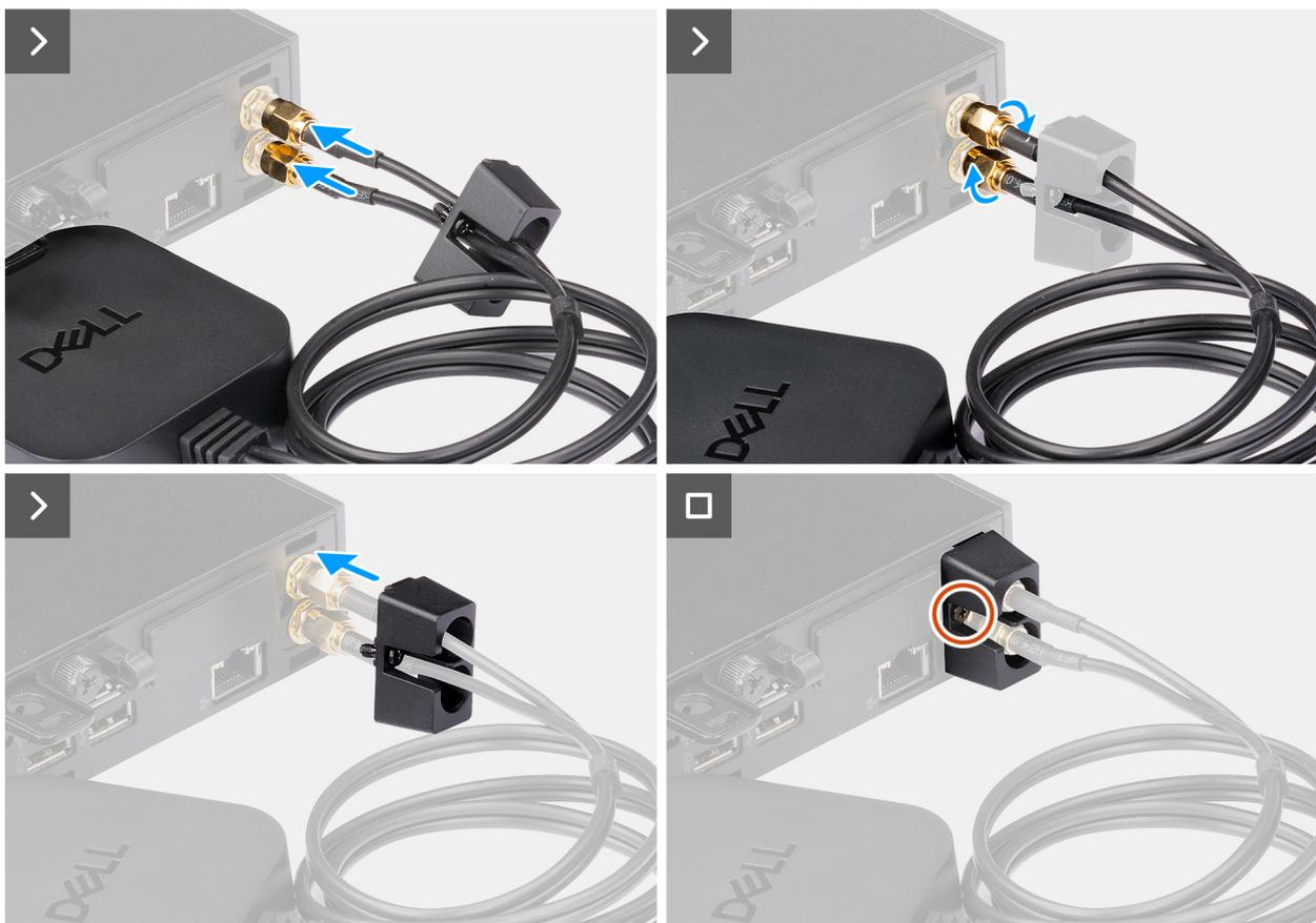
Figura 35. Installazione dell'antenna a disco esterna
