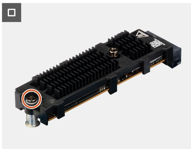
**Figura 25. Installazione dell'unità SSD PCIe M.2 2280**
