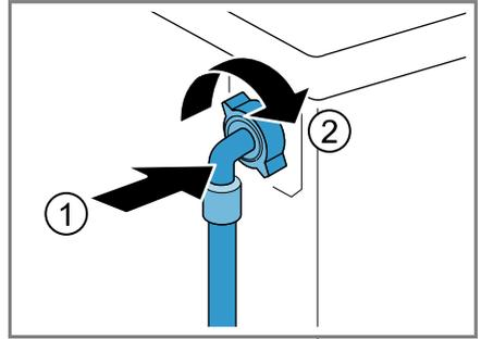
2. Raccordez le tuyau d'arrivée d'eau au robinet d'eau (26,4 mm = 3/4").
