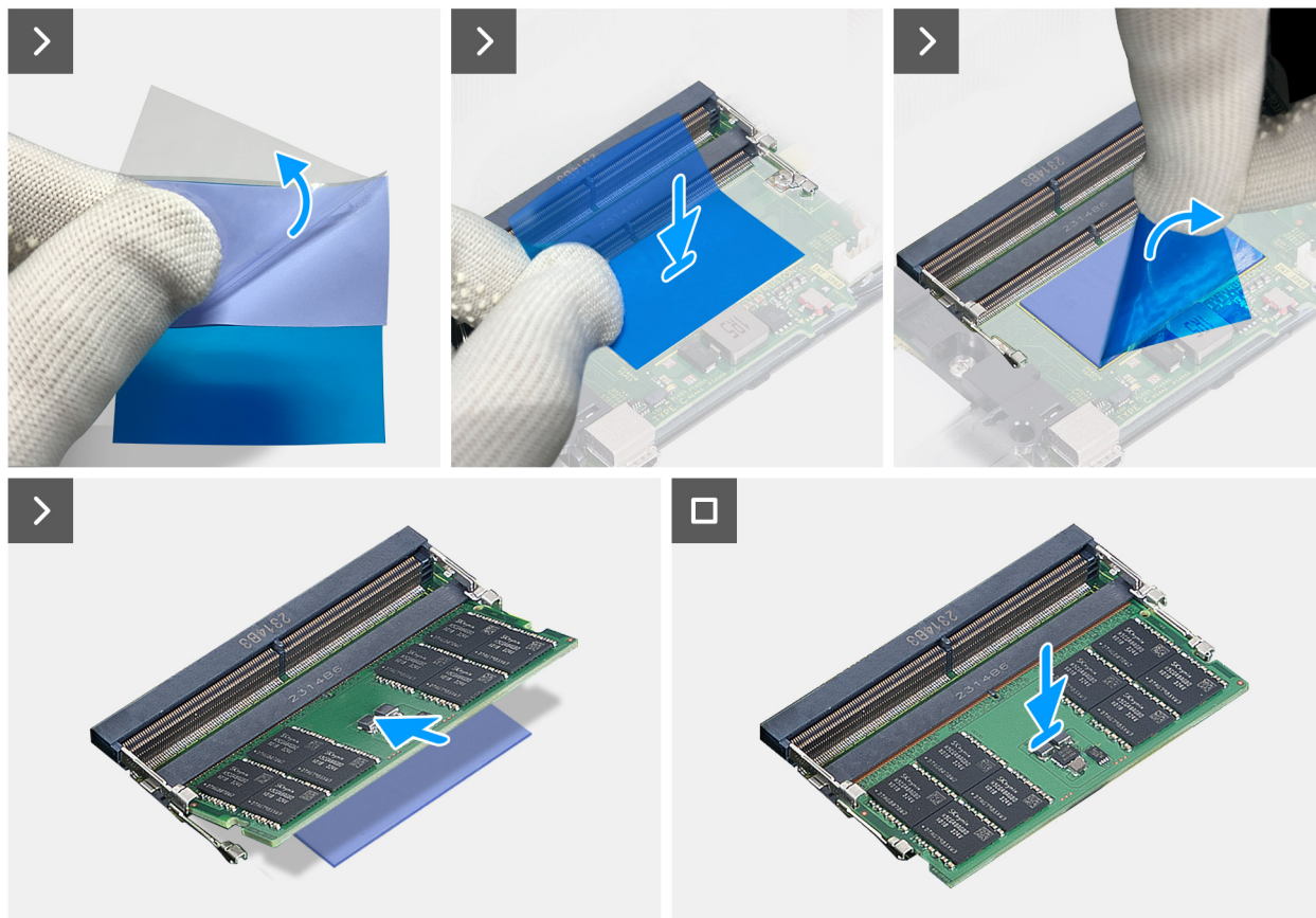
Ilustración 33. Instalación del módulo de memoria
