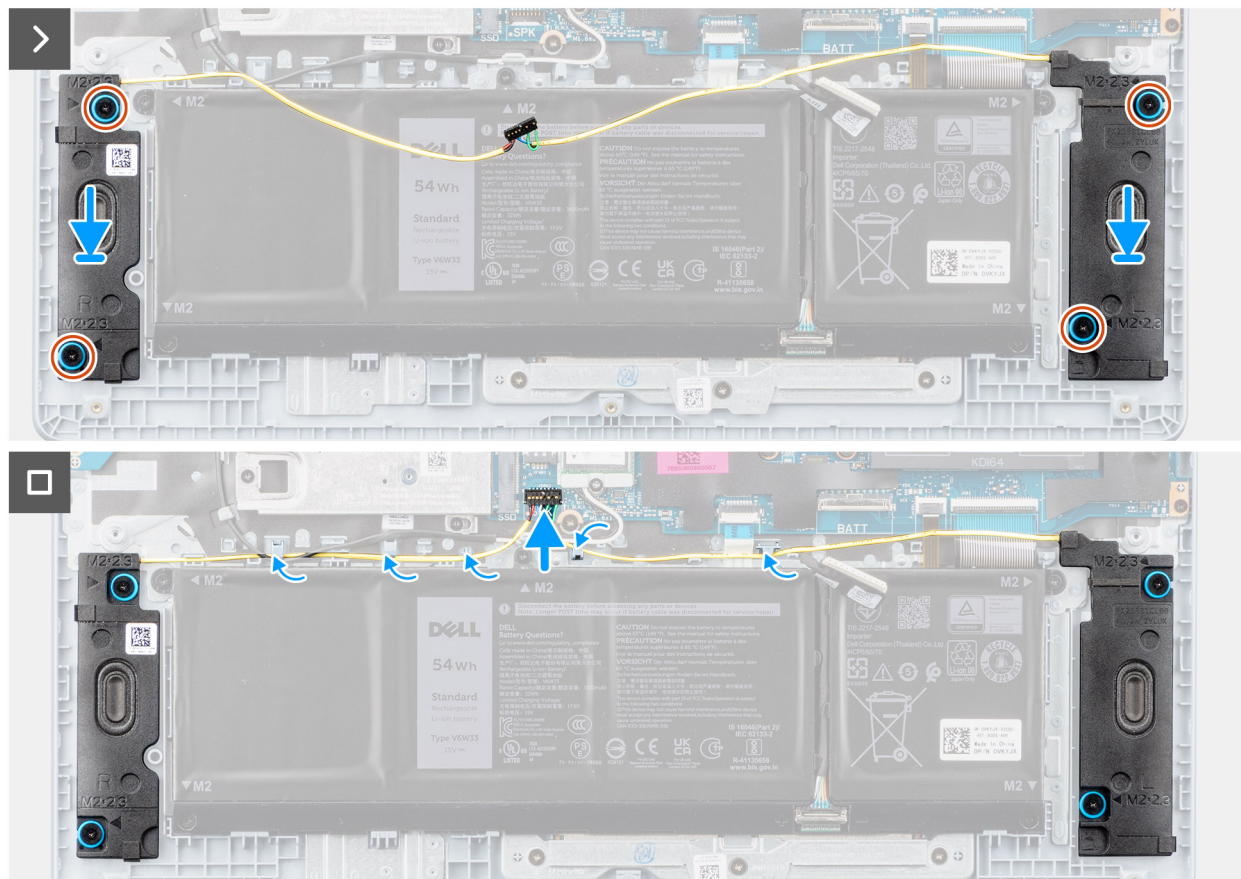
Rysunek 35. Instalowanie głośników
