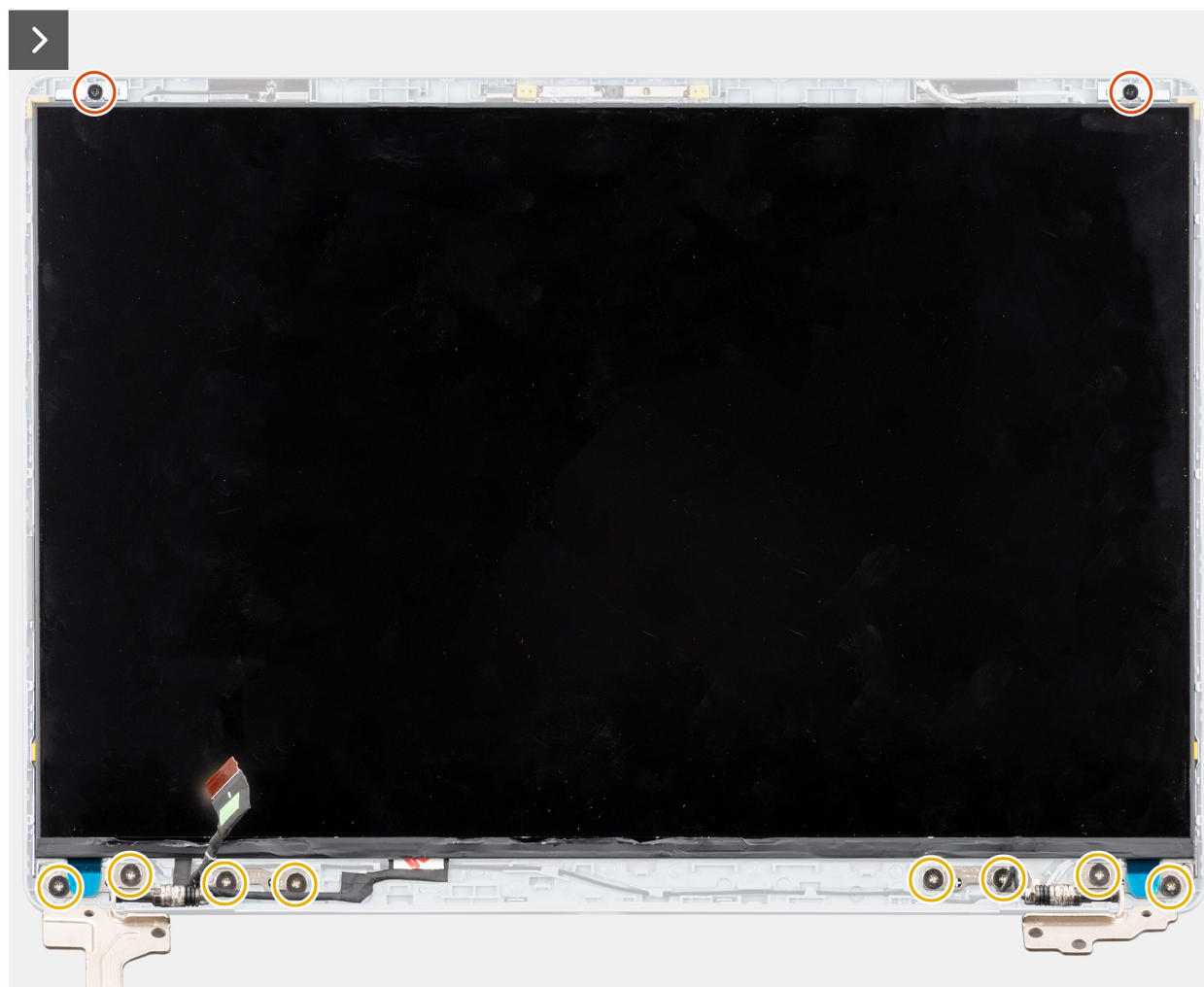
Rysunek 61. Wymontowywanie wyświetlacza
