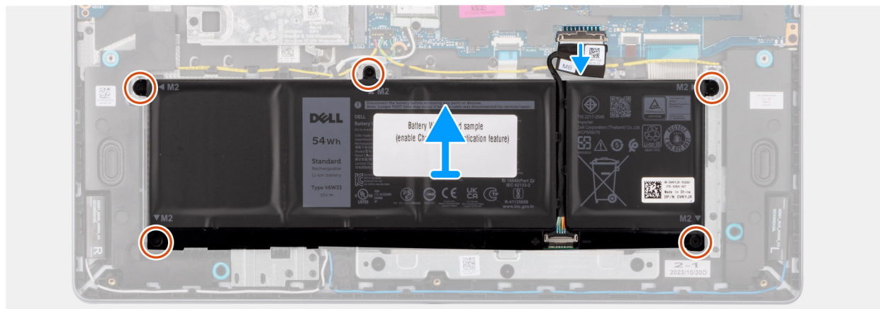
Rysunek 19. Wymontowywanie baterii 4-ogniowej
