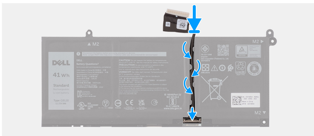
Rysunek 25. Podłączanie kabla baterii
