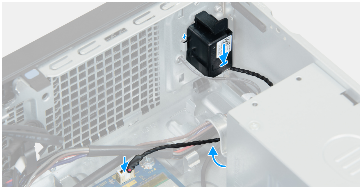
Ilustración 19. Instalación del altavoz interno
