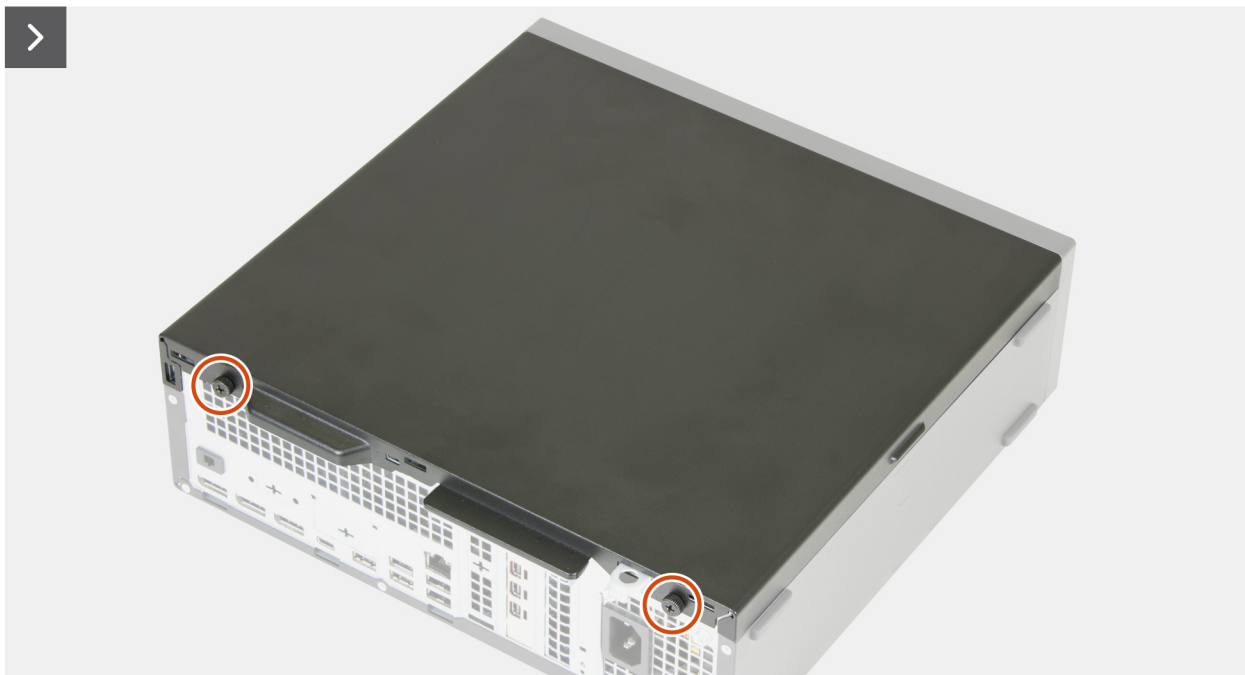
Ilustración 6. Extracción de la cubierta lateral
