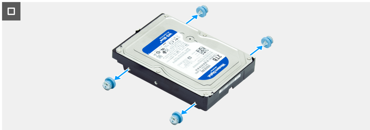
Ilustración 40. Extracción del disco duro
