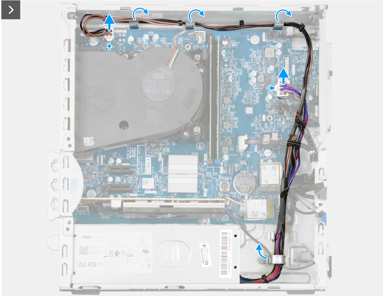
Ilustración 48. Extracción de la fuente de alimentación
