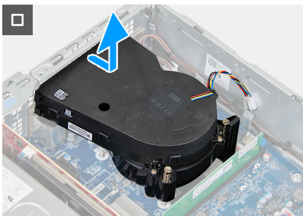
Ilustración 52. Extracción del ensamblaje del disipador de calor y el ventilador del procesador
