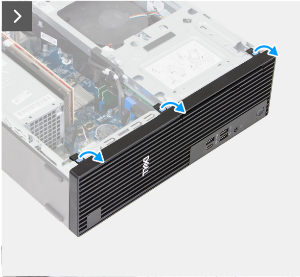
Ilustración 16. Extracción de la cubierta frontal
