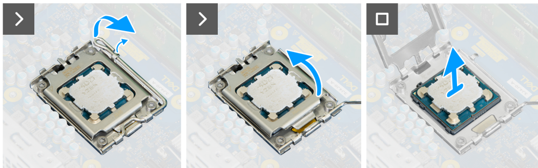
Ilustración 60. Extracción del procesador
