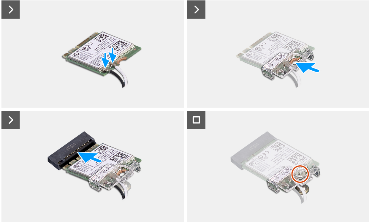
Ilustración 30. Instalación de la tarjeta inalámbrica
