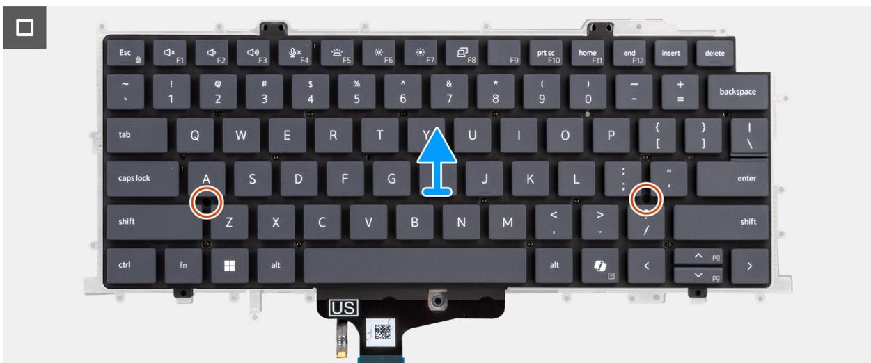
Abbildung 80. Entfernen der Tastatur
