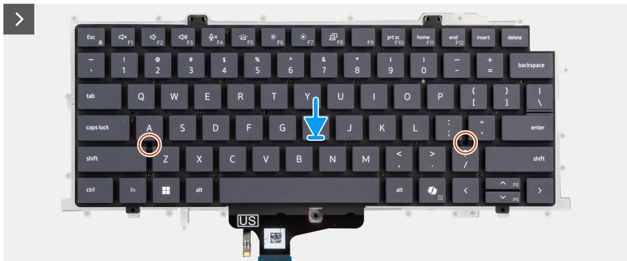
Abbildung 81. Einbauen der Tastatur
