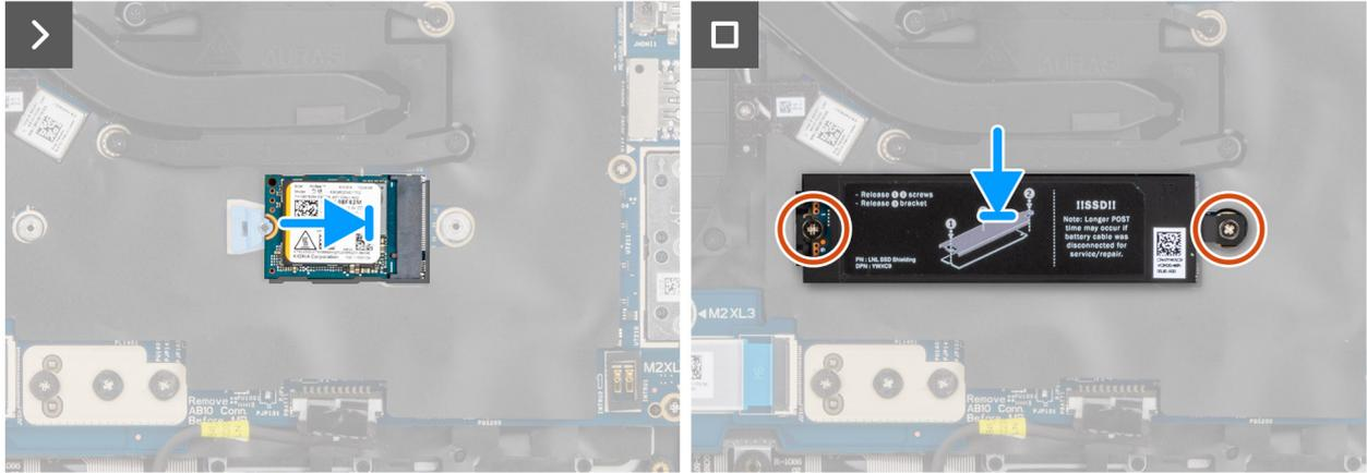
Abbildung 31. Einbauen des M.2-2280-SSD
