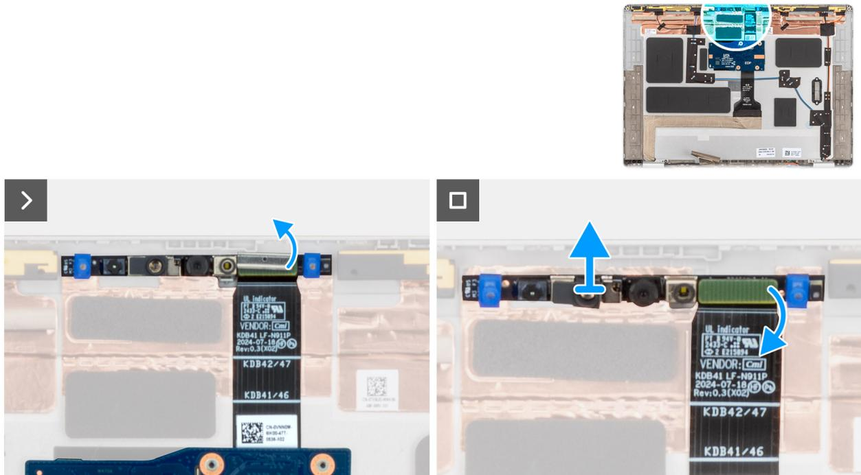
Abbildung 56. Entfernen der MIPI-Kamera
