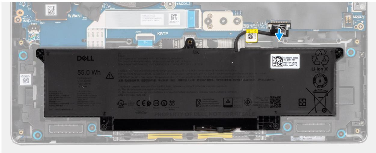
Abbildung 21. Trennen des Akkukabels
