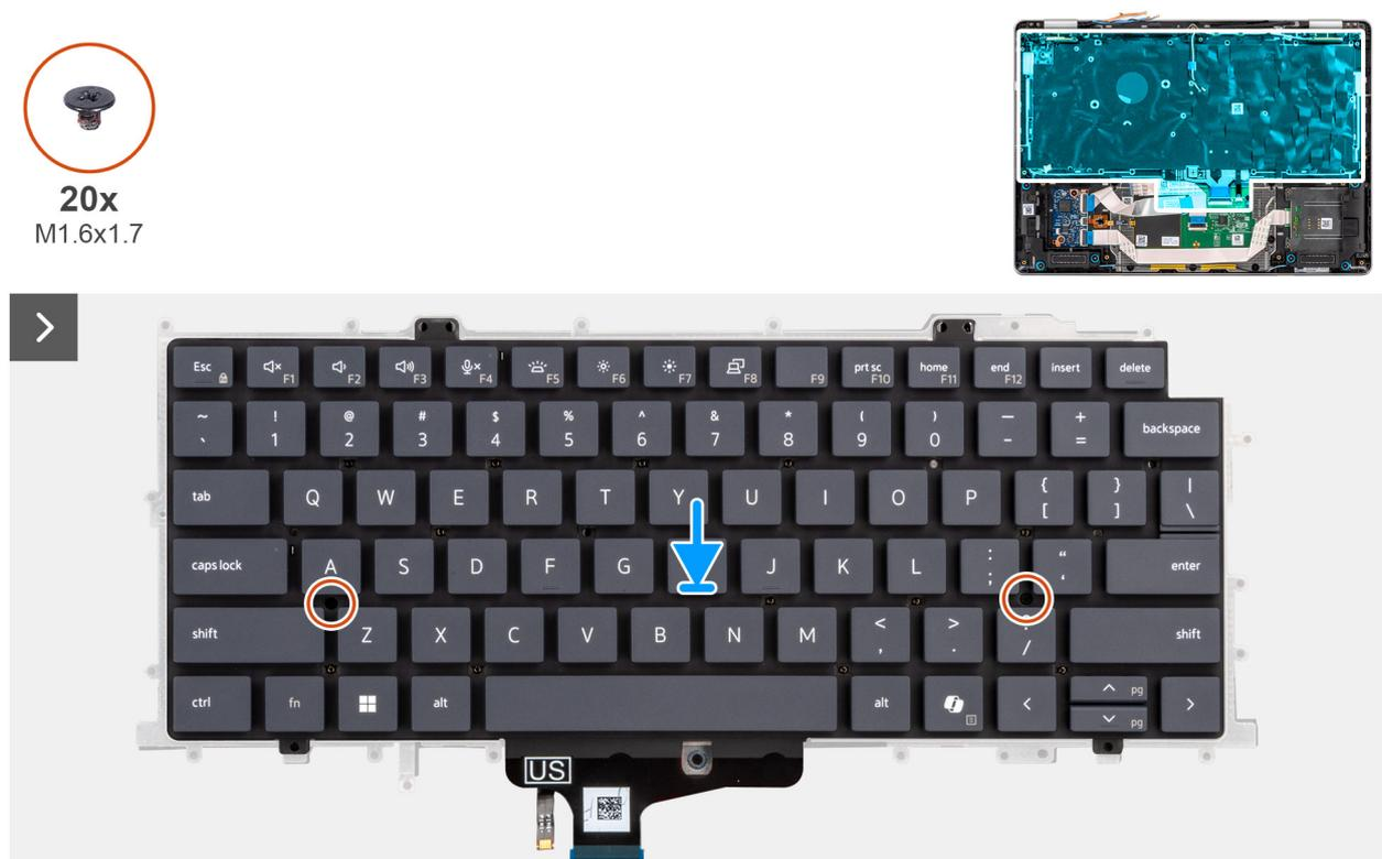
Figure 81. Installation du clavier
