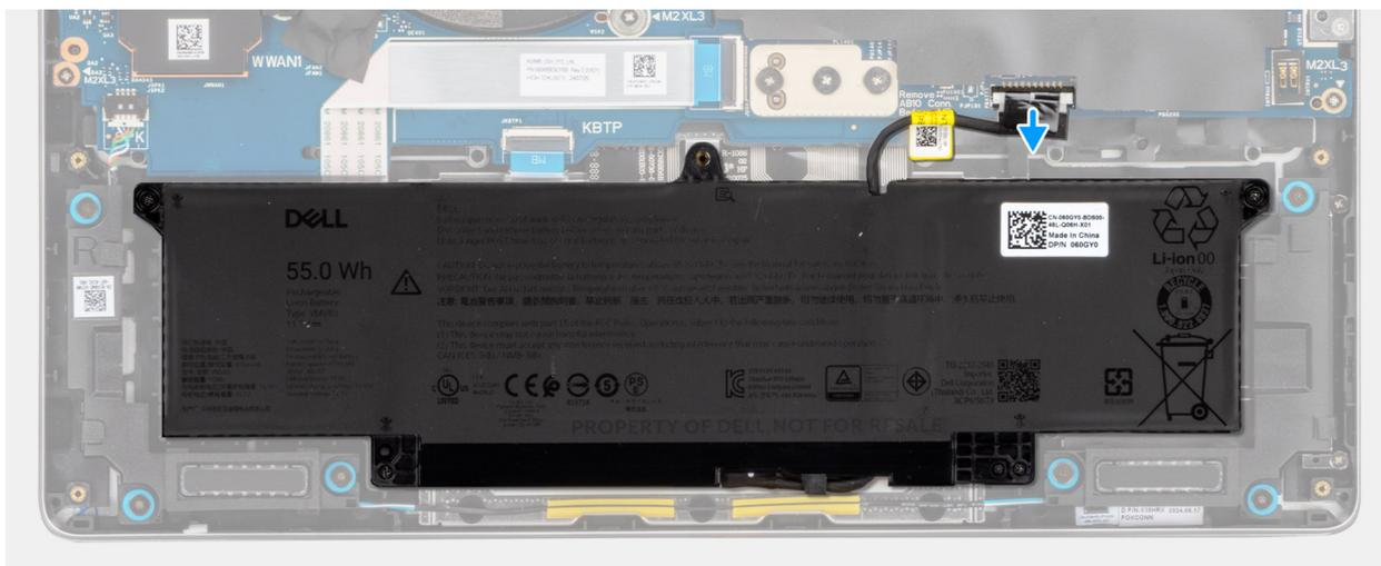
Figure 21. Déconnexion du câble de la batterie
