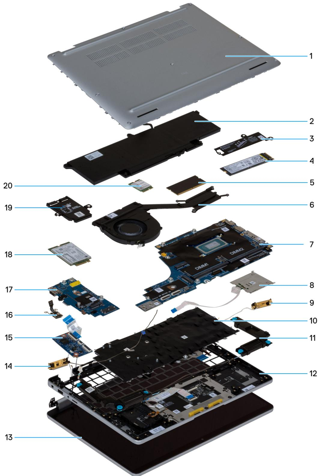
Abbildung 19. Hauptkomponenten von Dell Pro 14 Plus/Dell Pro 14 Plus 2-in-1-System
