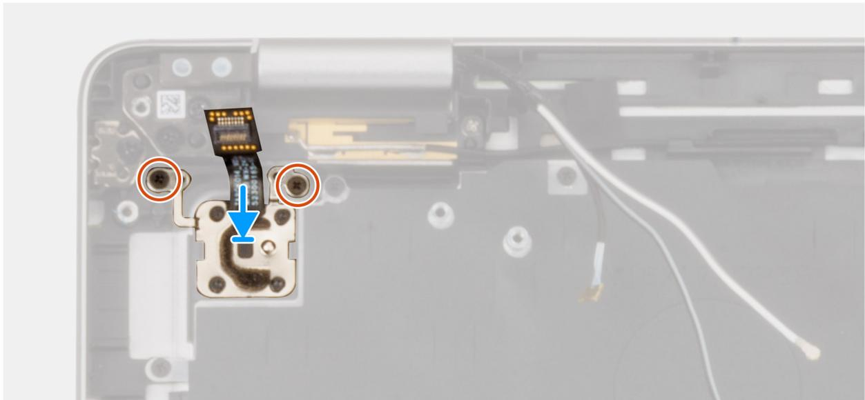
**Abbildung 63. Installieren des Netzschalters mit optionalem Fingerabdruck-Lesegerät**
