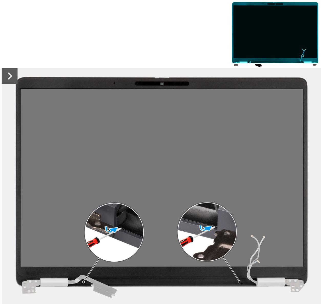
Abbildung 68. Entfernen der Bildschirmblende
