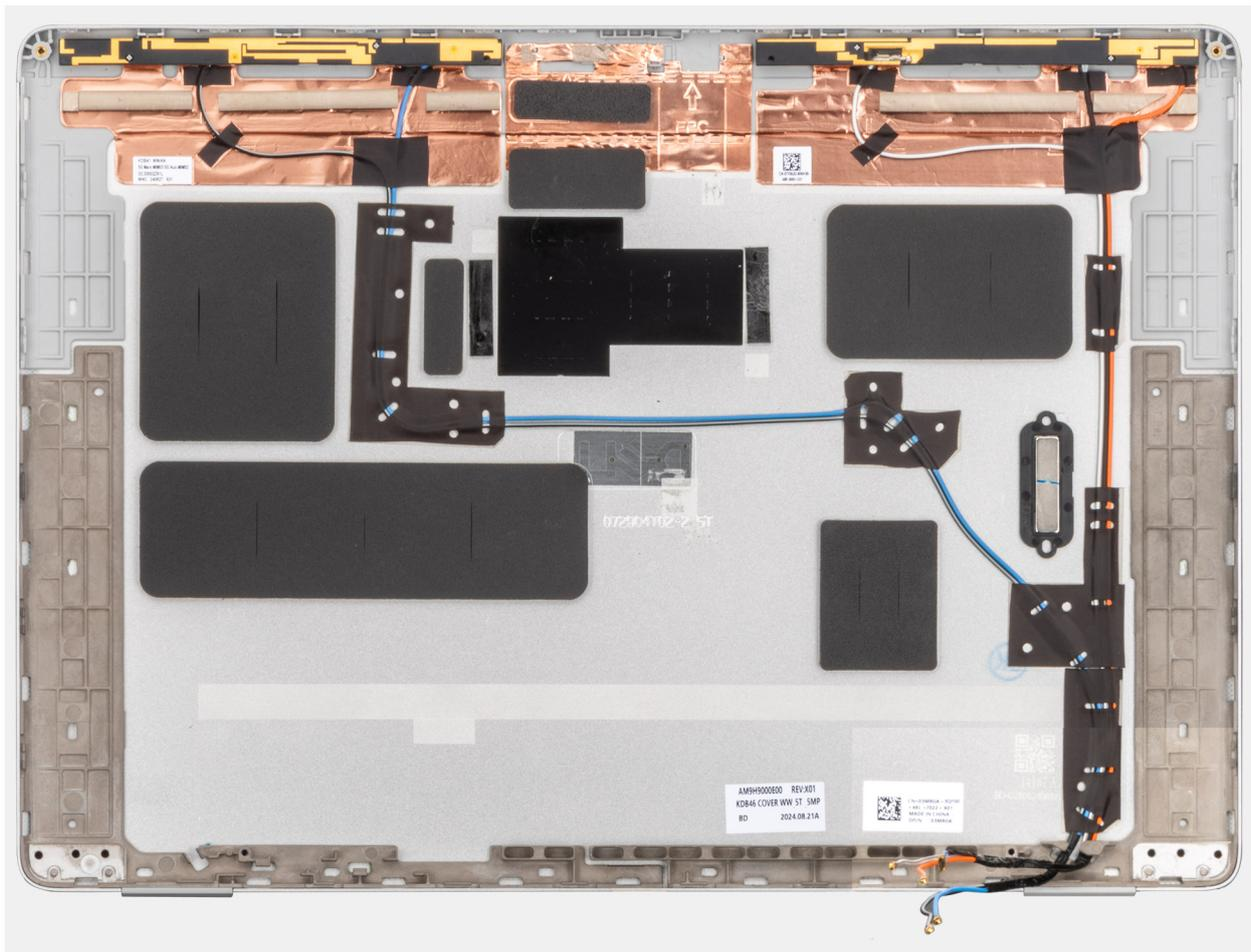
Abbildung 96. Bildschirmrückwand-Antennen-Baugruppe
