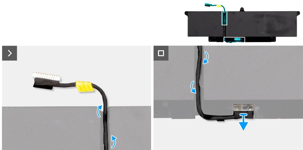
Abbildung 30. Entfernen des Akkukabels
