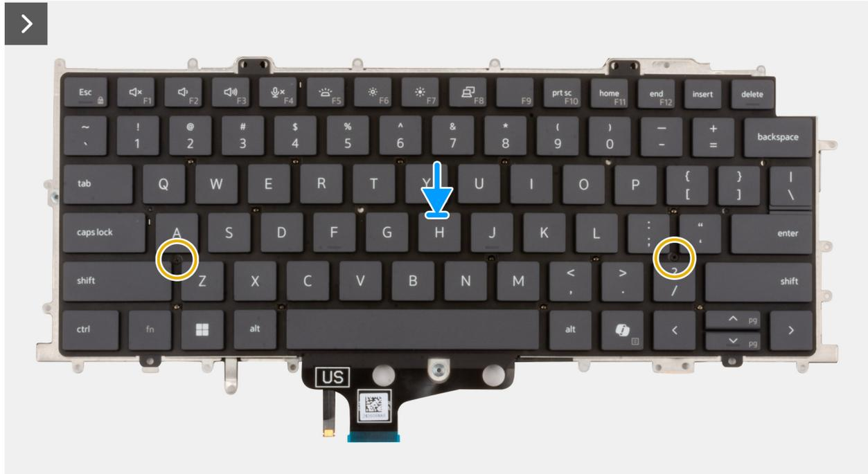
Abbildung 100. Einbauen der Tastatur
