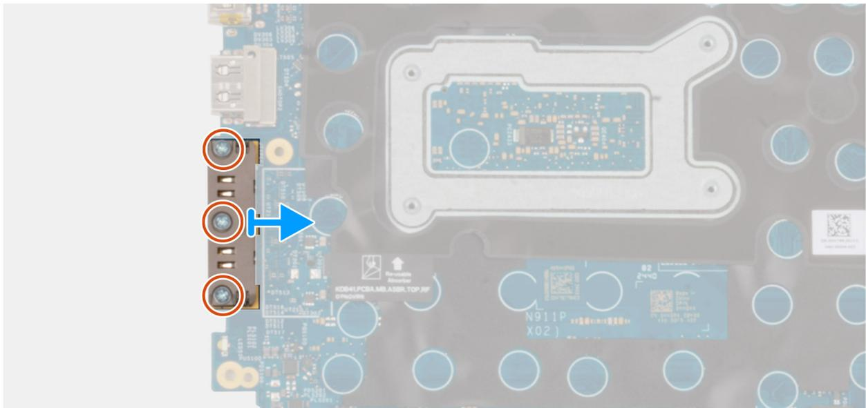
**Abbildung 58. Entfernen des USB-Type-C-Anschlussmoduls**
