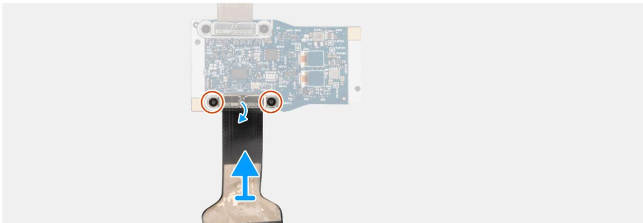
**Abbildung 90. Entfernen des Bildschirmkabels für die MIPI-Kamera**
