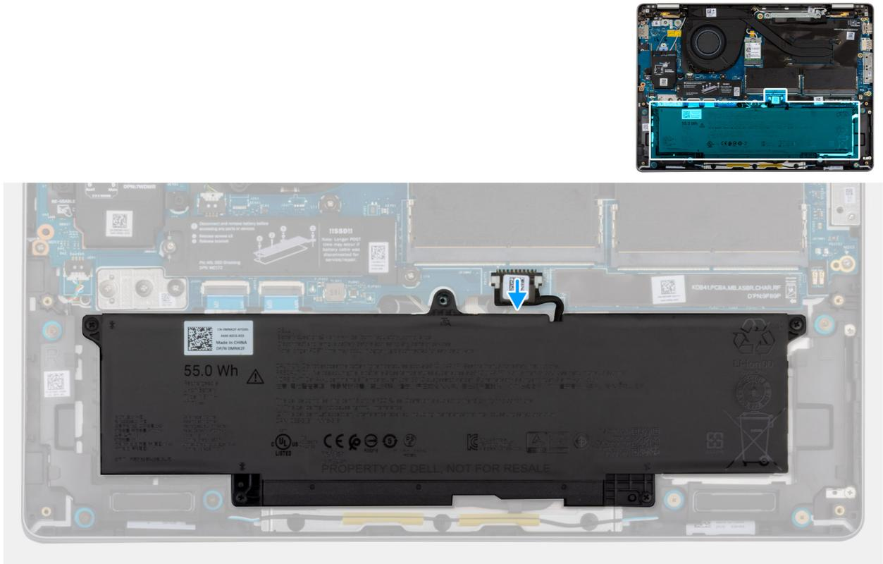
Abbildung 24. Trennen des Akkukabels
