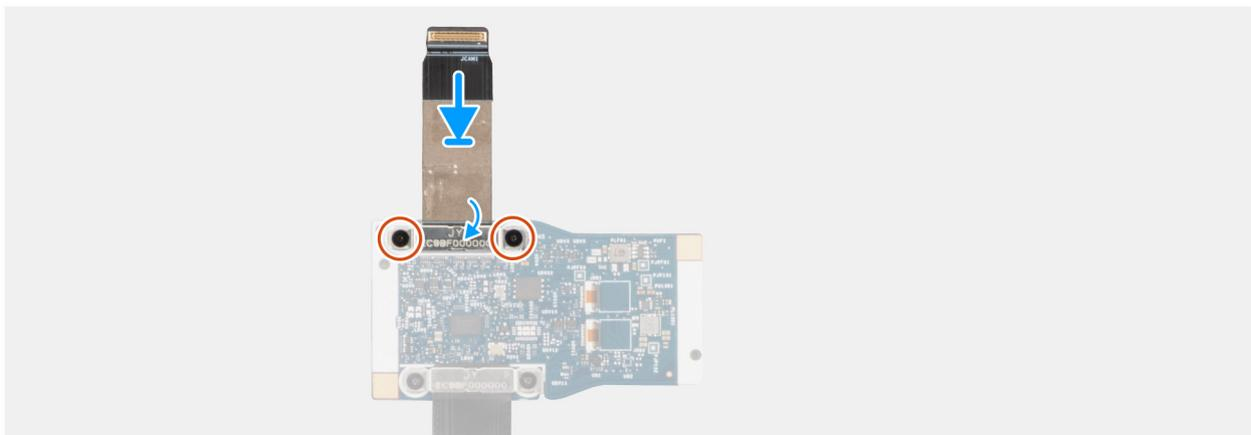
**Abbildung 93. Installieren des Kabels der mittleren Platine**
