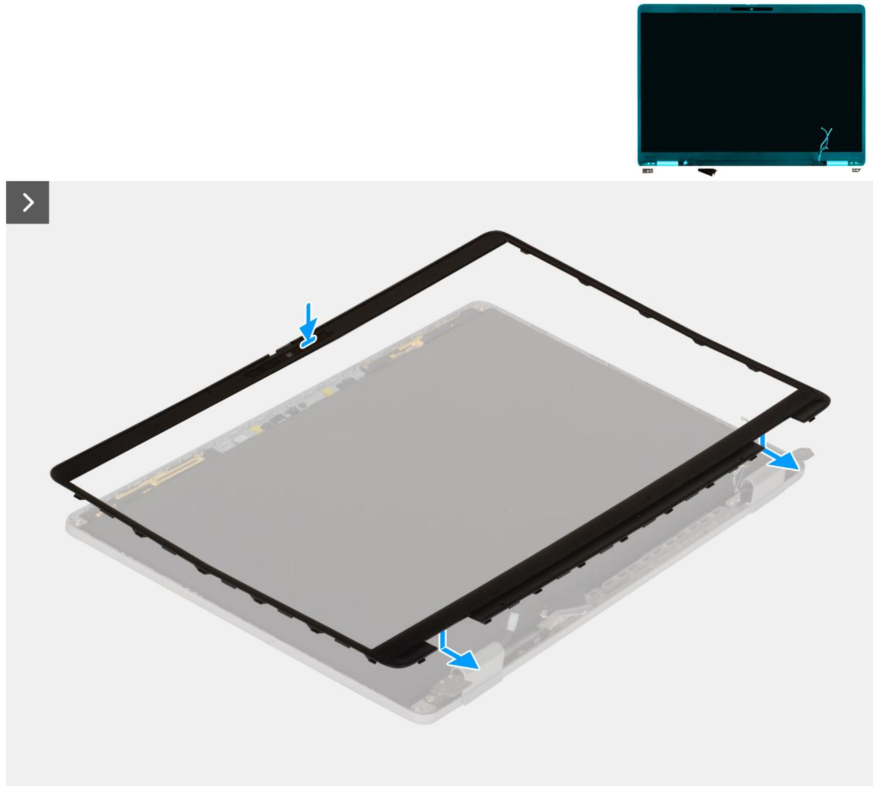
Abbildung 73. Einbauen der Bildschirmblende
