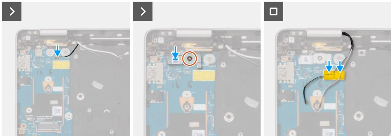
**Abbildung 57. Einbau des WLAN-Antennenmoduls**
