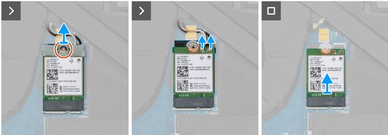
Abbildung 40. Entfernen der WLAN-Karte
