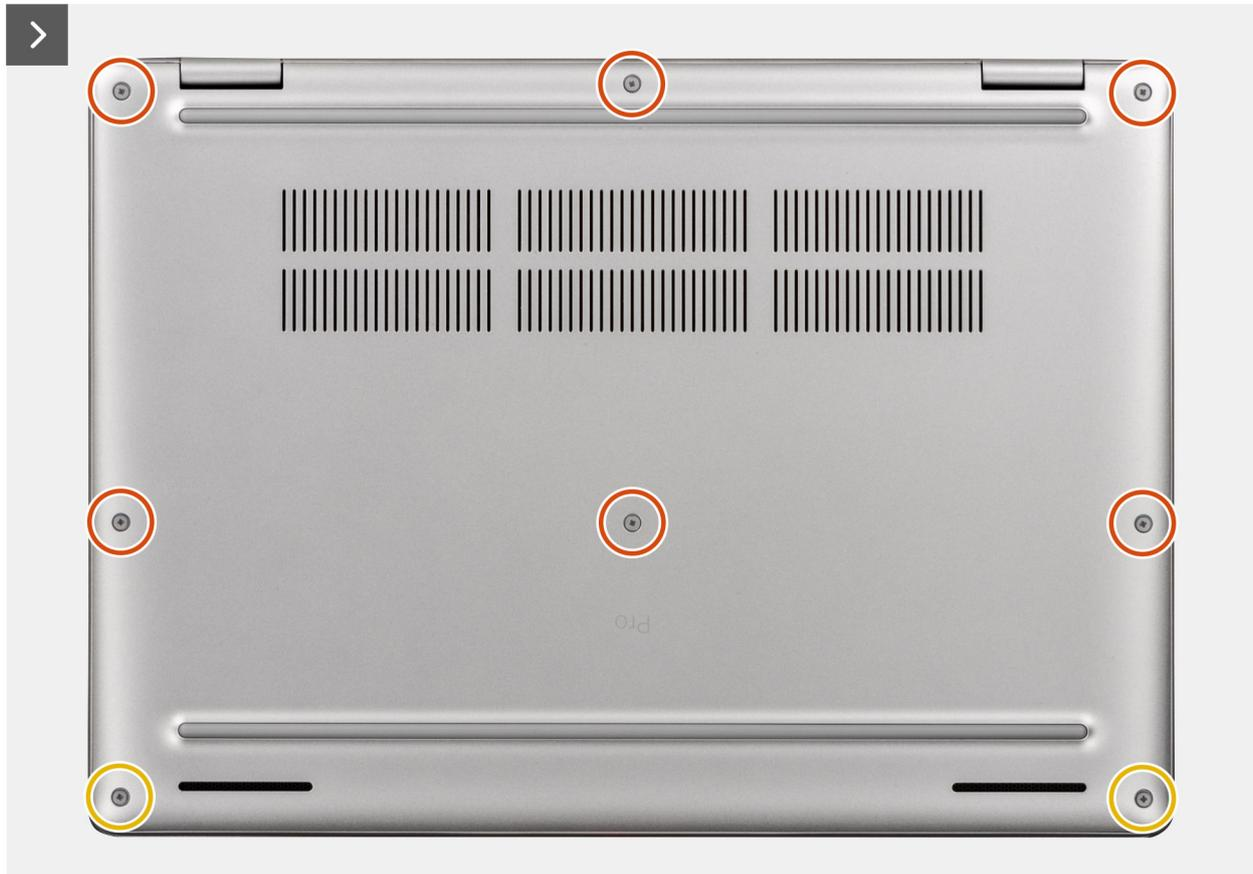
Abbildung 22. Entfernen der Bodenabdeckung
