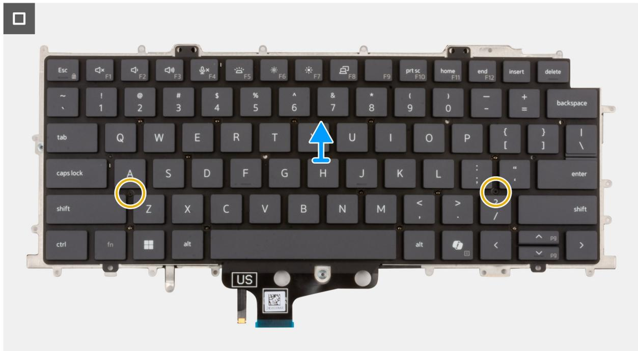
Abbildung 99. Entfernen der Tastatur
