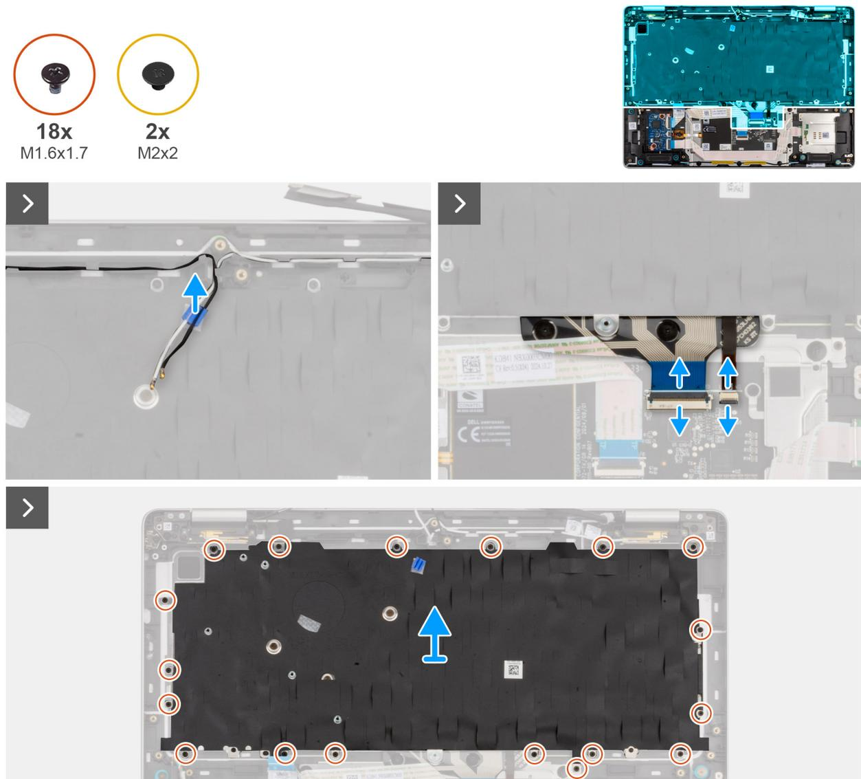
Abbildung 98. Entfernen der Tastatur
