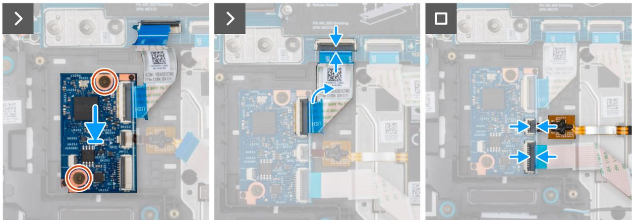
Abbildung 47. Einbauen der USH-Platine
