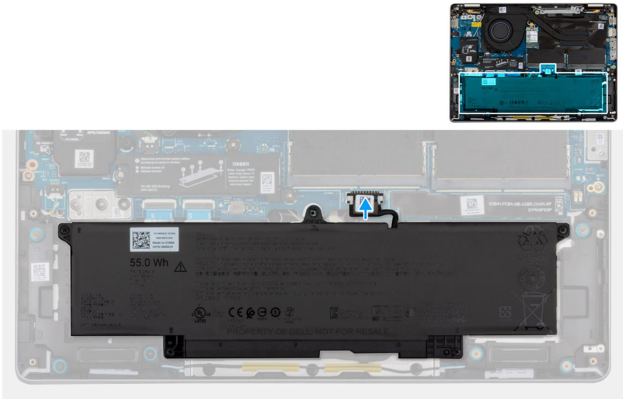
Abbildung 25. Verbinden des Akkukabels
