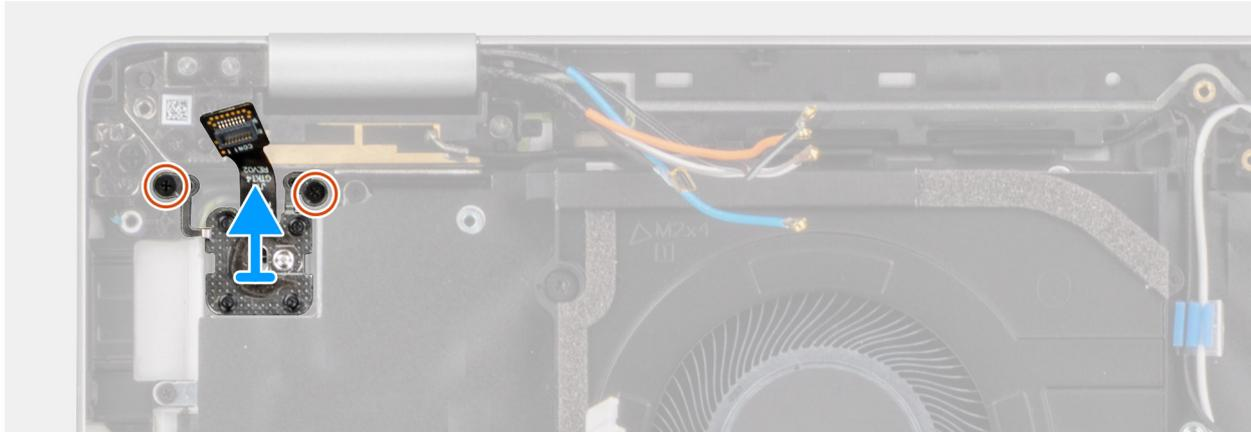
Abbildung 62. Entfernen des Netzschalters mit optionalem Fingerabdruck-Lesegerät
