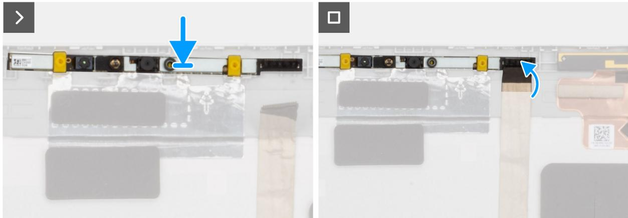
Abbildung 83. Installieren der RGB/IR-Kamera
