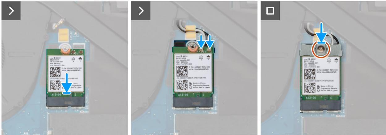
Abbildung 41. Einbauen der WLAN-Karte
