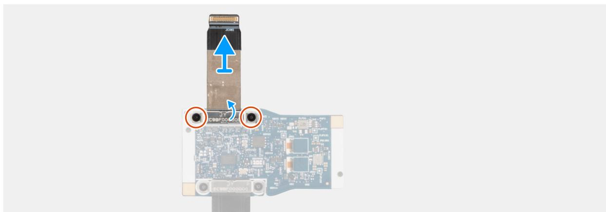
**Abbildung 92. Entfernen des Kabels der mittleren Platine**
