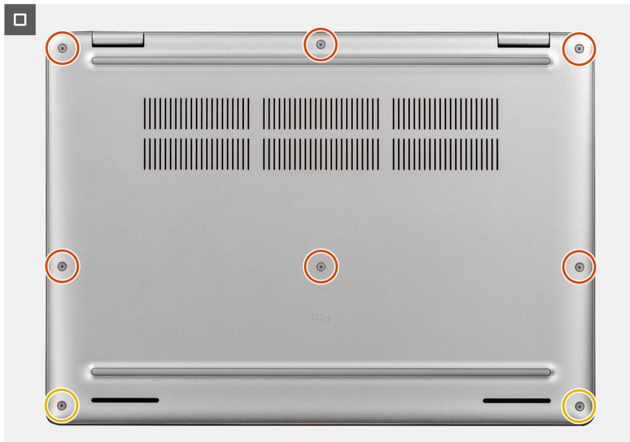
**Abbildung 27. Anbringen der Bodenabdeckung**
