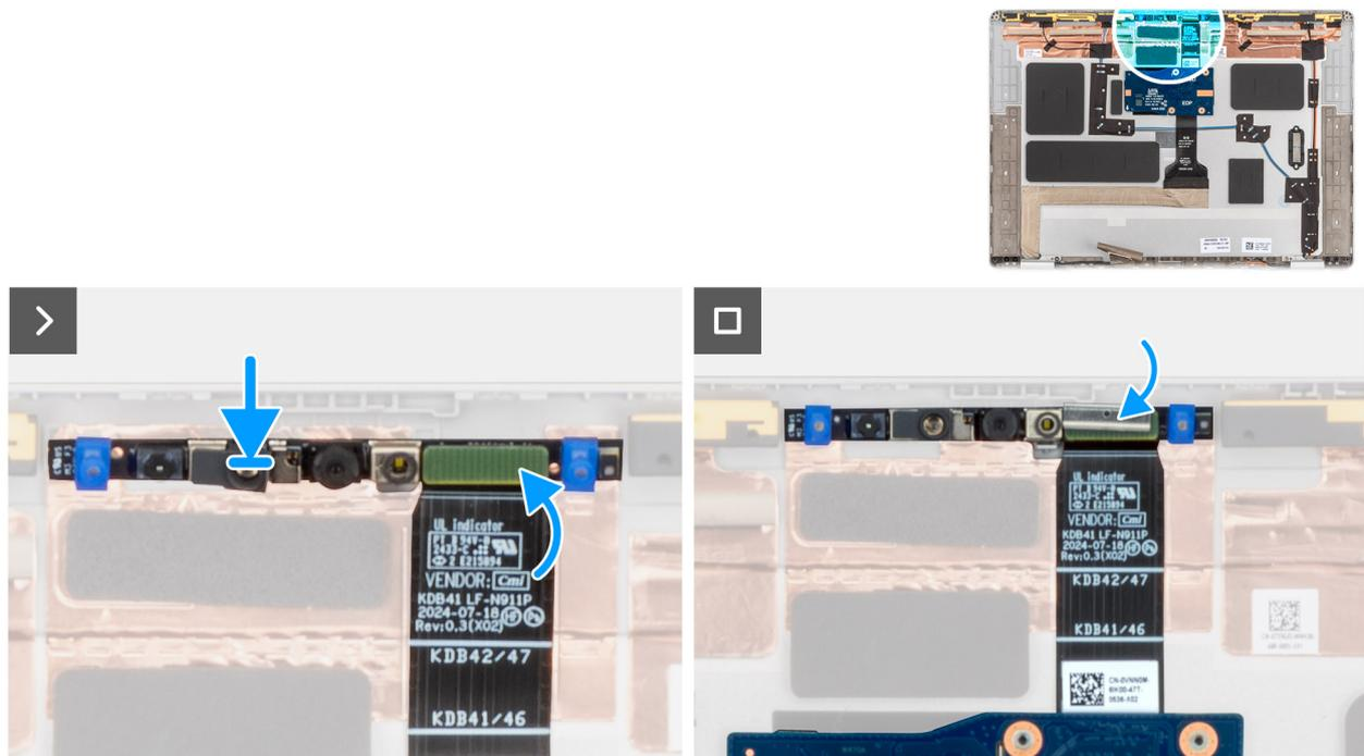
Abbildung 89. Installieren der MIPI-Kamera
