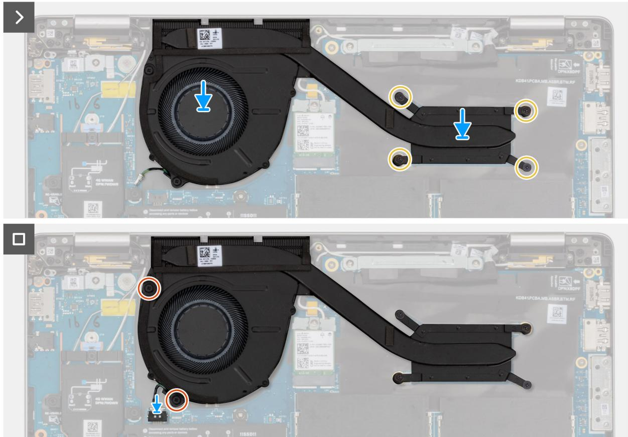
Abbildung 45. Installieren der Lüfter- und Kühlkörperbaugruppe
