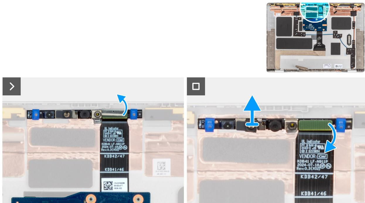
Abbildung 88. Entfernen der MIPI-Kamera
