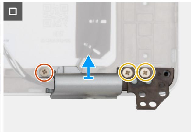
Abbildung 80. Entfernen der Bildschirmscharnierabdeckungen
