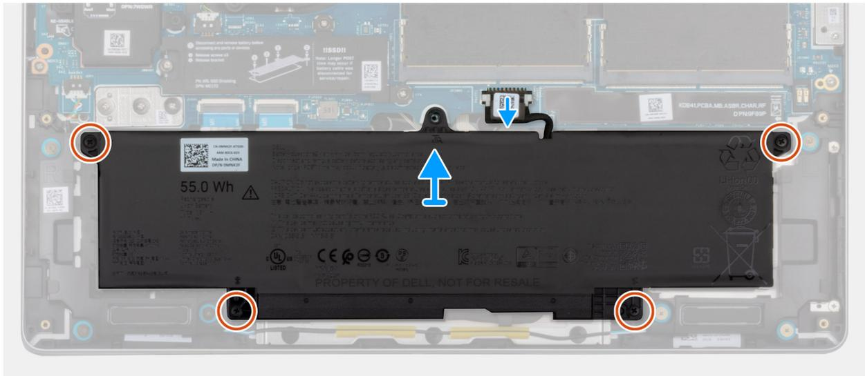
Abbildung 28. Entfernen des Akkus
