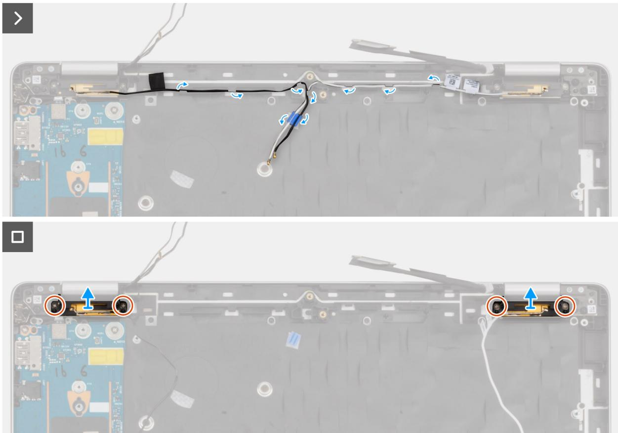
Abbildung 55. Entfernen des WLAN-Antennenmoduls
