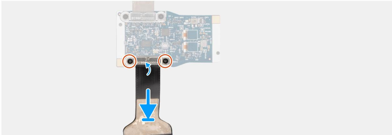
**Abbildung 91. Einbauen des Bildschirmkabels für die MIPI-Kamera**
