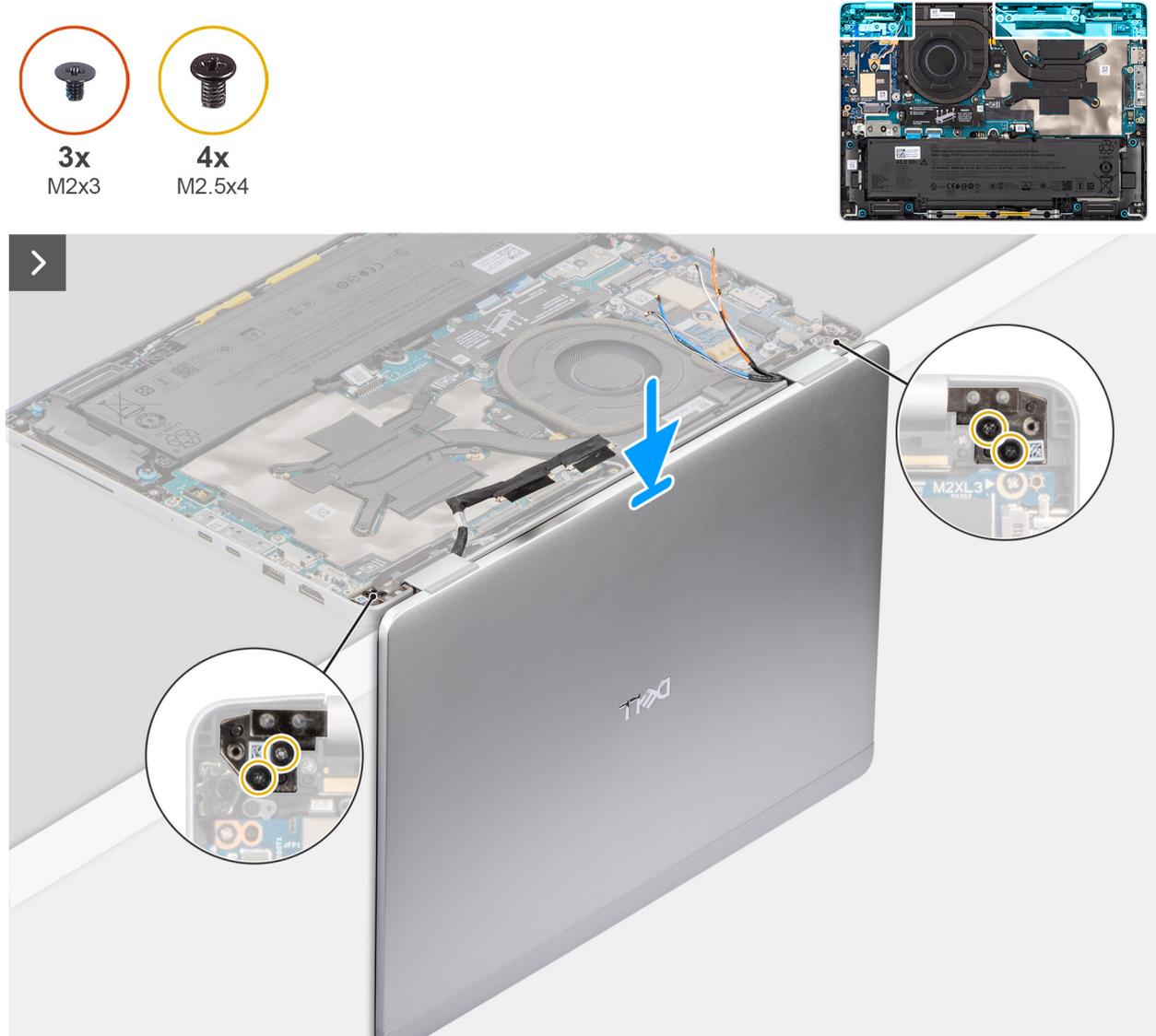
Abbildung 63. Ausrichten der Bildschirmbaugruppe an der Handauflagenbaugruppe
