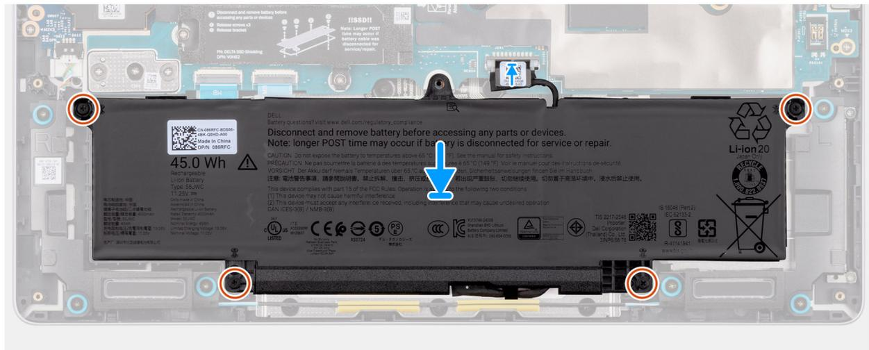
Abbildung 24. Einsetzen des Akkus
