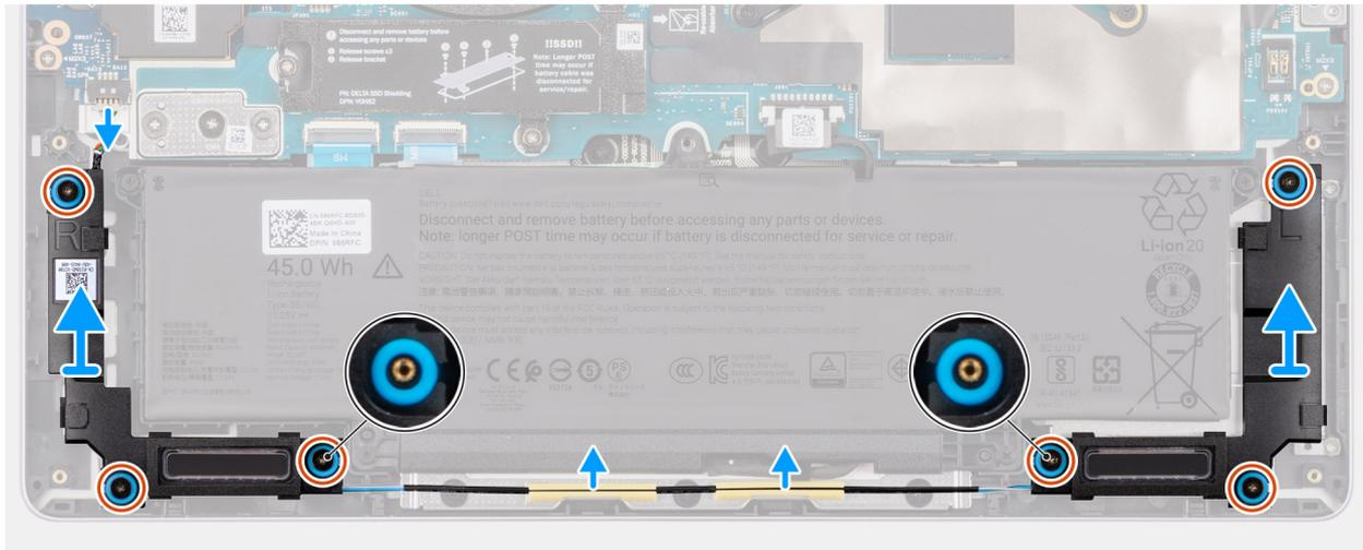
**Abbildung 35. Entfernen der Lautsprecher**
