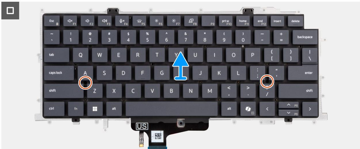
Abbildung 98. Entfernen der Tastatur
