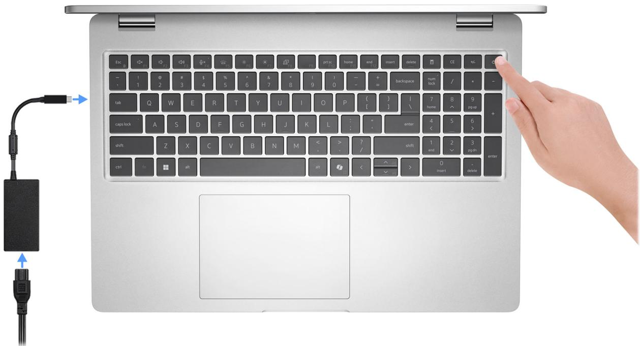
**Abbildung 11. Anschließen des Netzteils und Drücken des Netzschalters**
