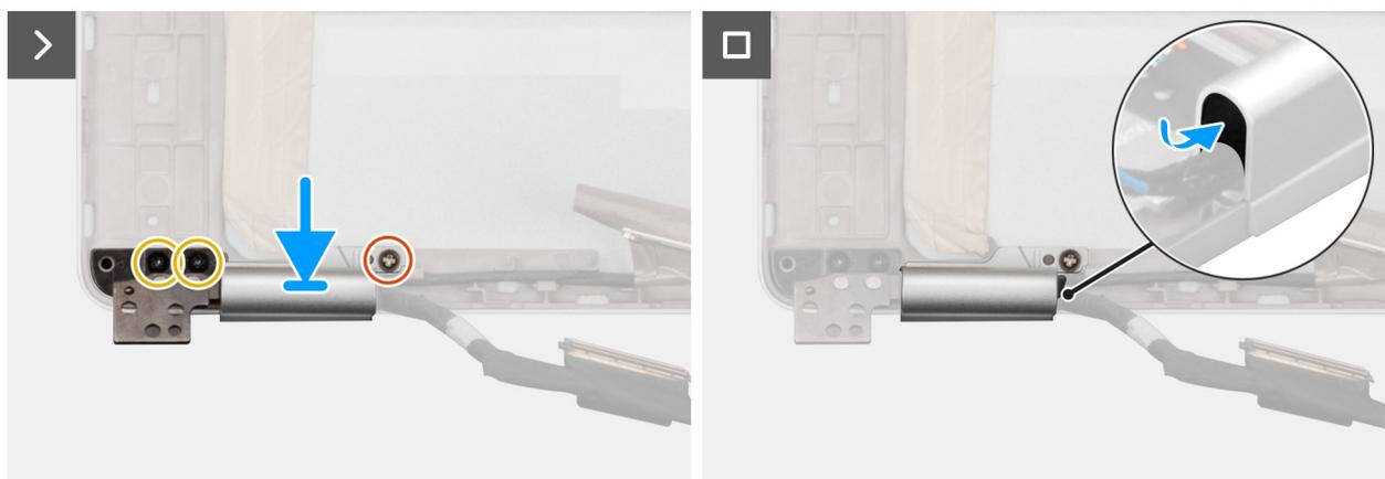
Abbildung 88. Einbauen des Bildschirmkabels für die RGB/IR-Kamera
