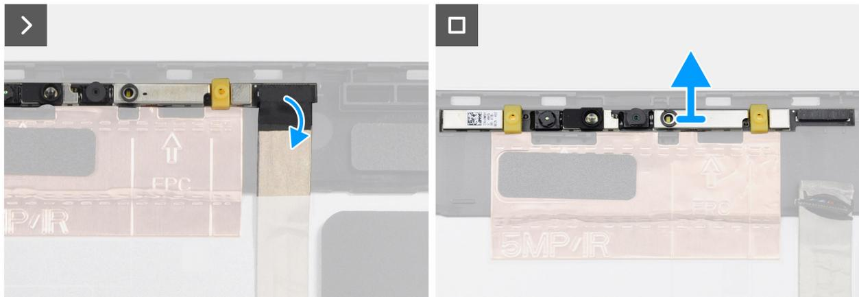
Abbildung 79. Entfernen der IR-Kamera
