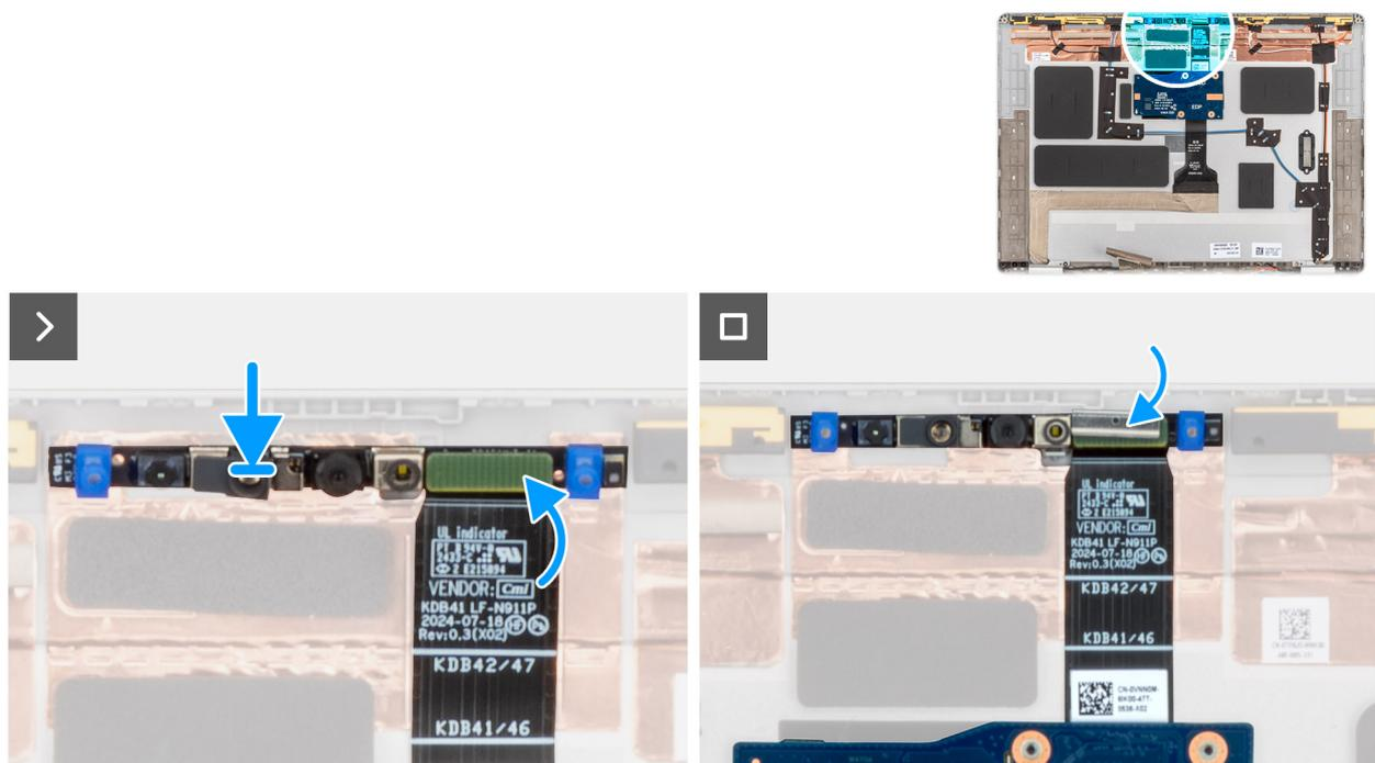
Abbildung 84. Installieren der MIPI-Kamera
