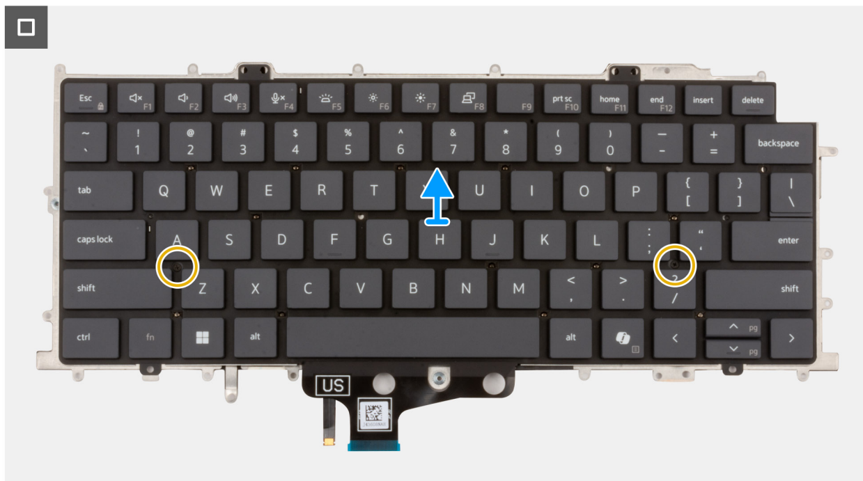
Figure 99. Retrait du clavier
