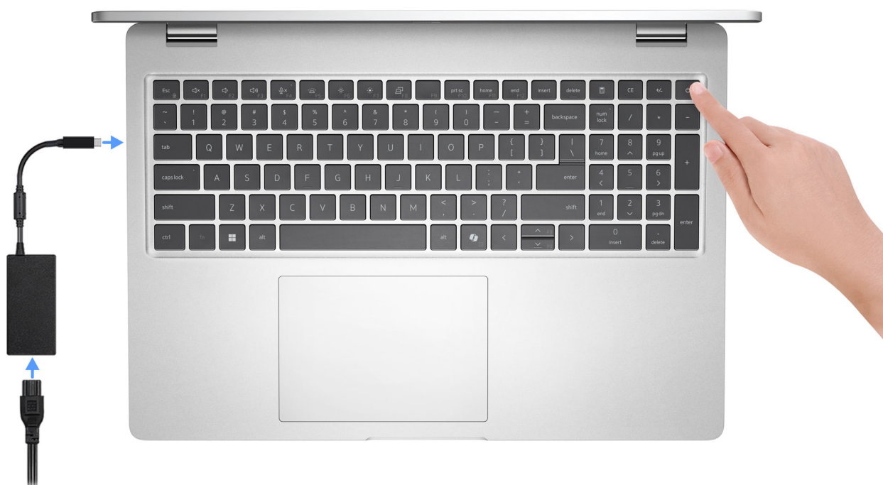
Figure 12. Branchez l'adaptateur secteur et appuyez sur le bouton d'alimentation.
