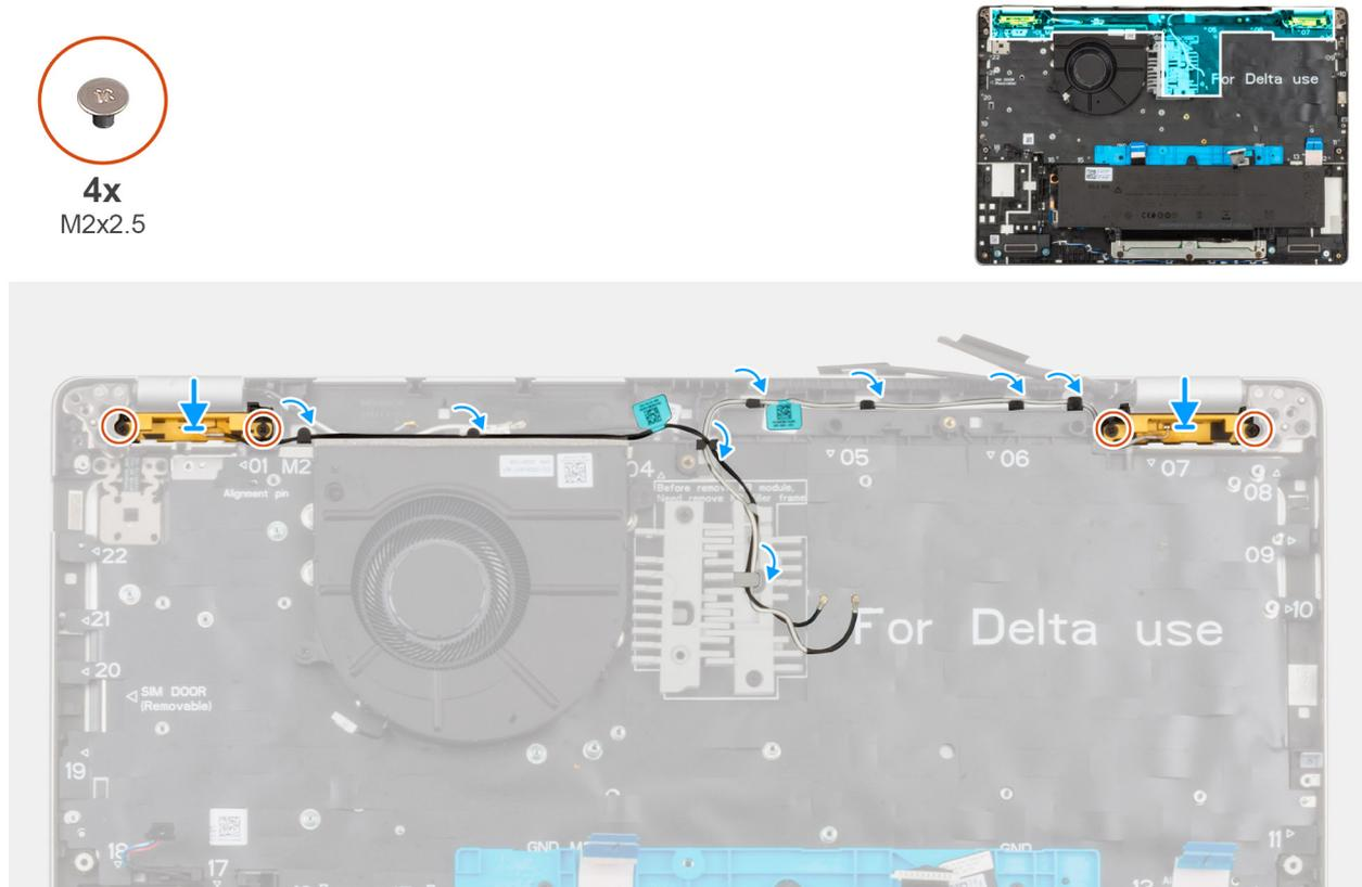
Figure 77. Installation de l'antenne sans fil
