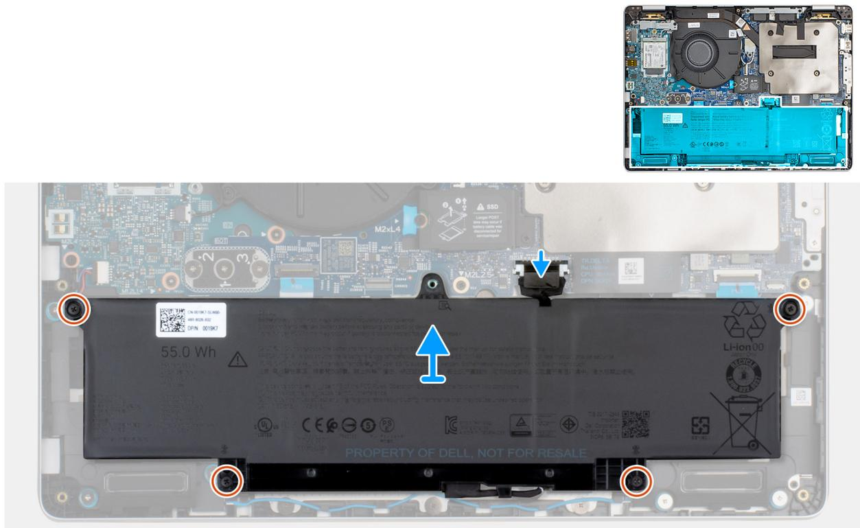
Figure 16. Connexion du câble de la batterie
