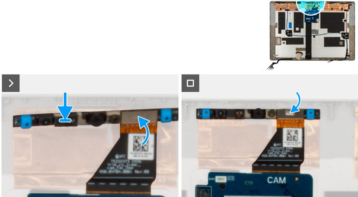
Figure 73. Installation du module de caméra
