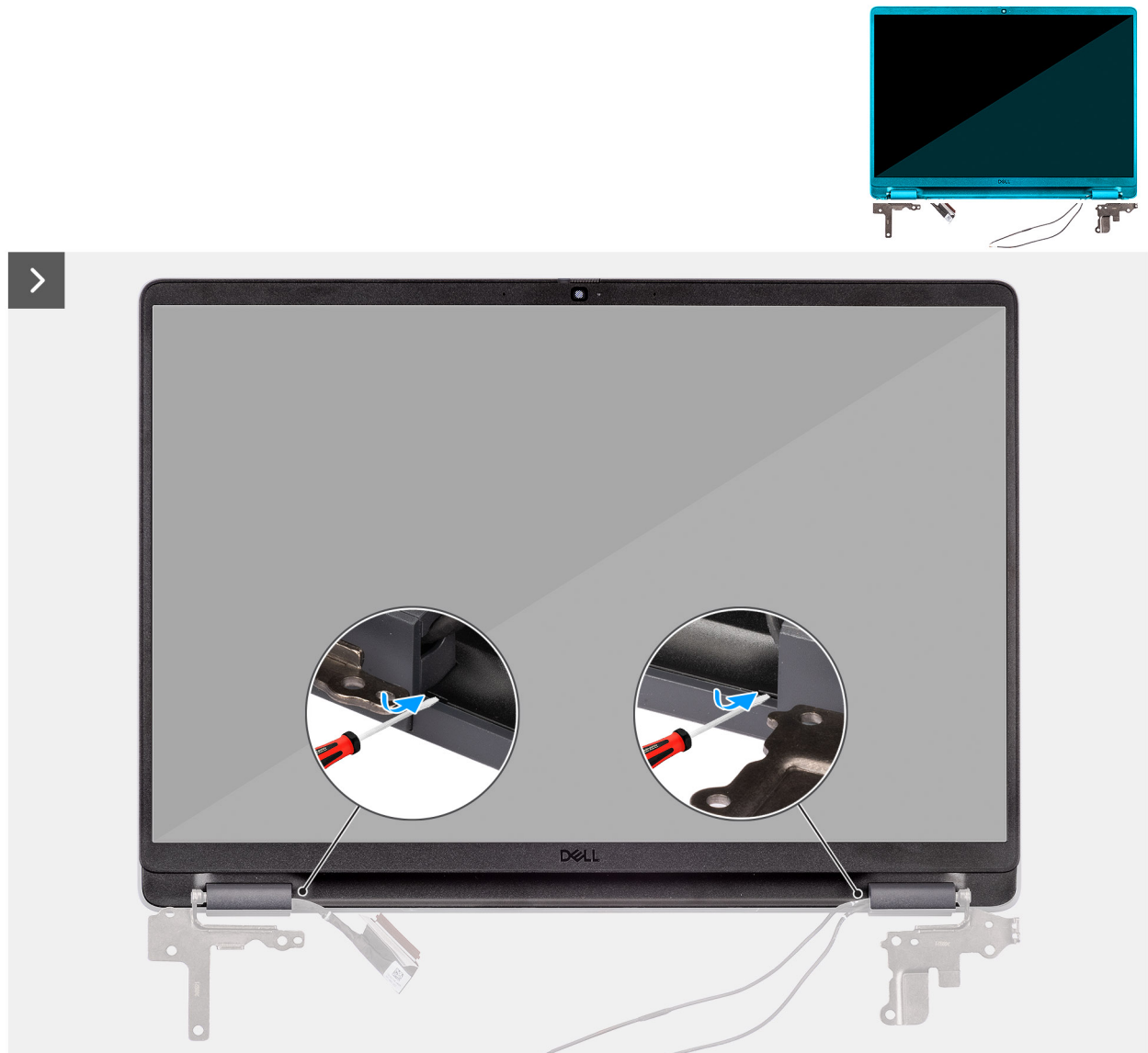
Abbildung 67. Entfernen der Bildschirmblende
