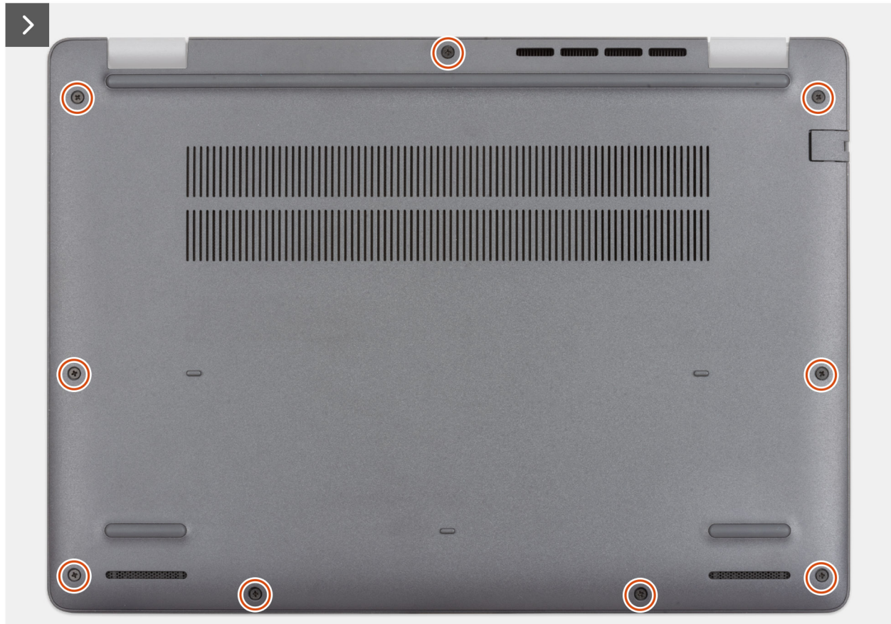
Abbildung 11. Entfernen der Bodenabdeckung
