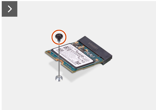
Abbildung 23. Entfernen des SSD
