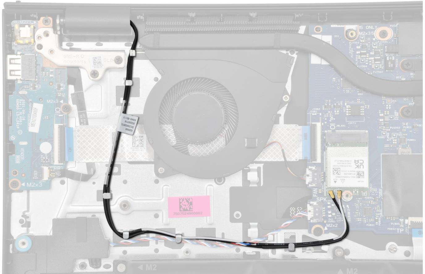
6. Pase el cable de los parlantes por las guías de enrutamiento del ensamblaje del teclado y el reposamanos.
