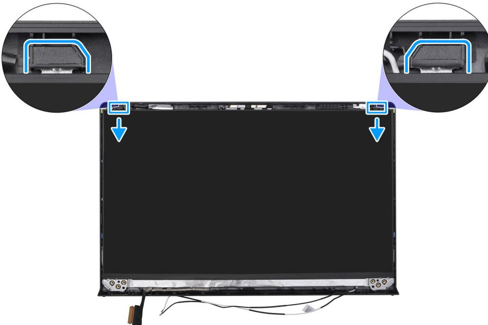
5. Con cuidado, voltee el ensamblaje del panel de pantalla hacia adelante y despegue la cinta que fija el cable de pantalla al conector en la parte posterior del panel de pantalla.
