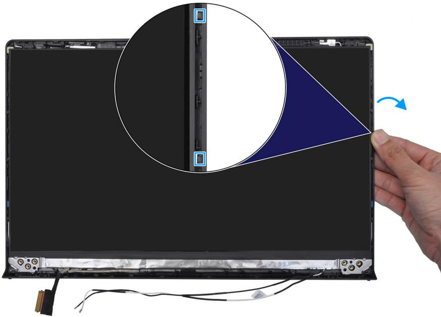
3. Repita los pasos 1 y 2 para el lado izquierdo del ensamblaje del panel de pantalla.
