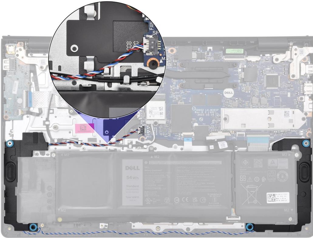
3. Conecte el cable del parlante al conector de la tarjeta madre.
