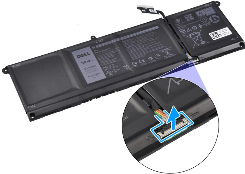
**PRECAUCIÓN:** NO tire del cable de la batería para desconectarlo de la batería. Esto puede dañar la batería o el cable.
