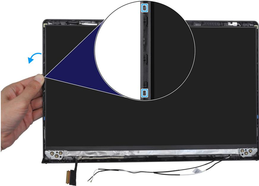
4. Levante la parte inferior del panel de pantalla y deslícelo hacia abajo para liberar los soportes de la pantalla de las ranuras en la parte superior de la cubierta posterior de la pantalla.
