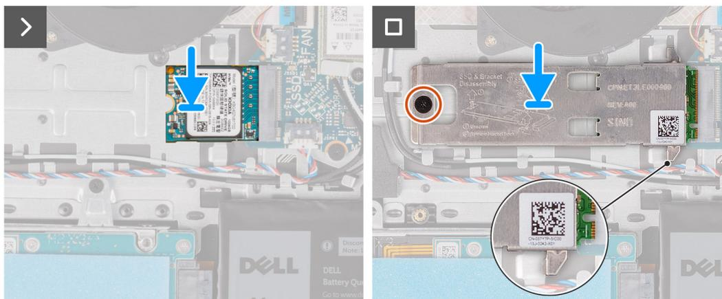
**Ilustración 3. Instalación de la unidad de estado sólido**
