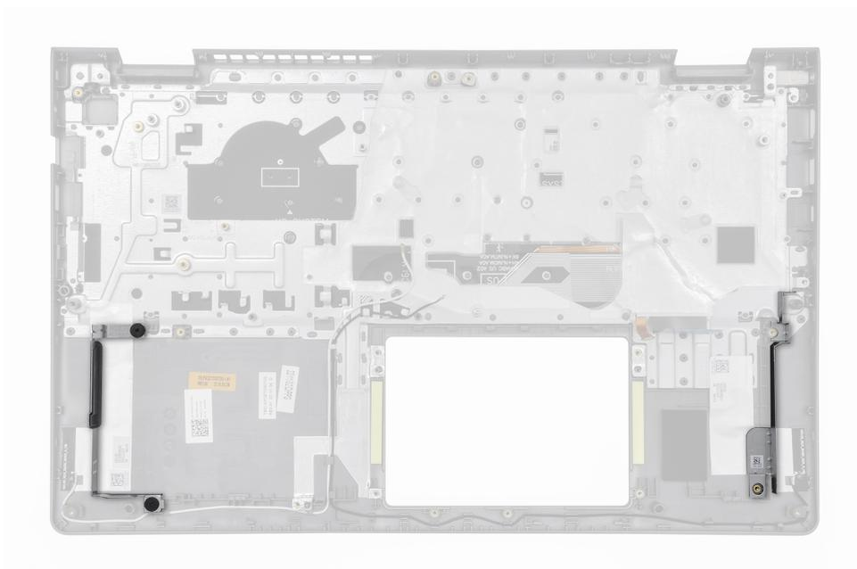
2. Para computadoras enviadas con chasis de aluminio, quite los soportes de pared metálicos de RF izquierdo y derecho del ensamblaje del teclado y el reposamanos.
