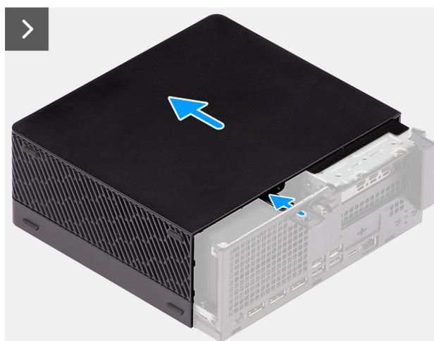
Figura 3. Rimozione del coperchio laterale
