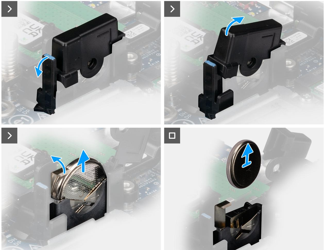
**Figura 7. Rimozione della batteria a bottone**
