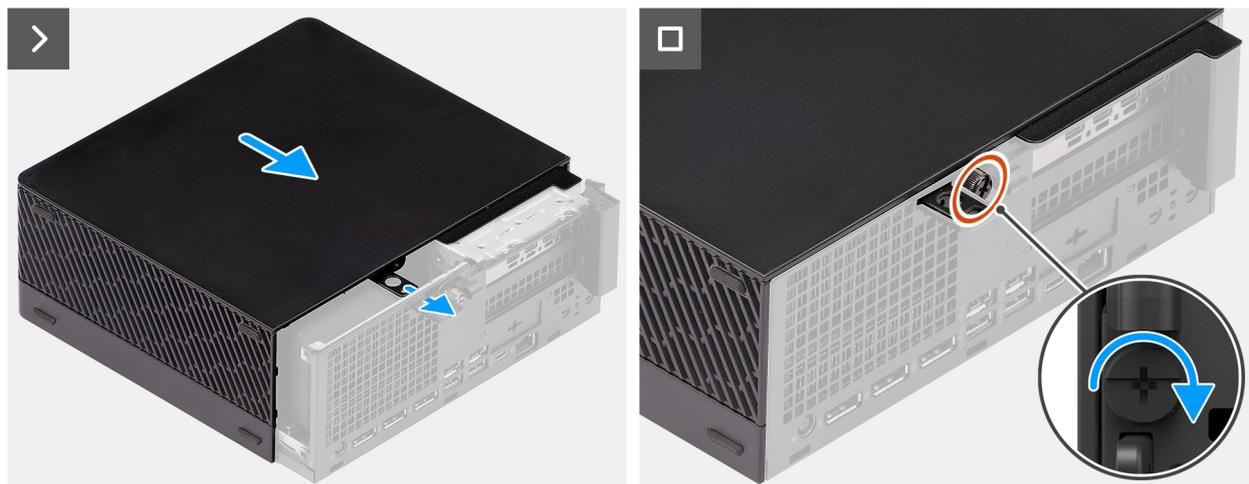
**Figura 6. Installazione del coperchio laterale**
