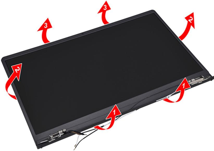
5. Levante y extraiga el bisel de la pantalla del ensamblaje de la pantalla.
