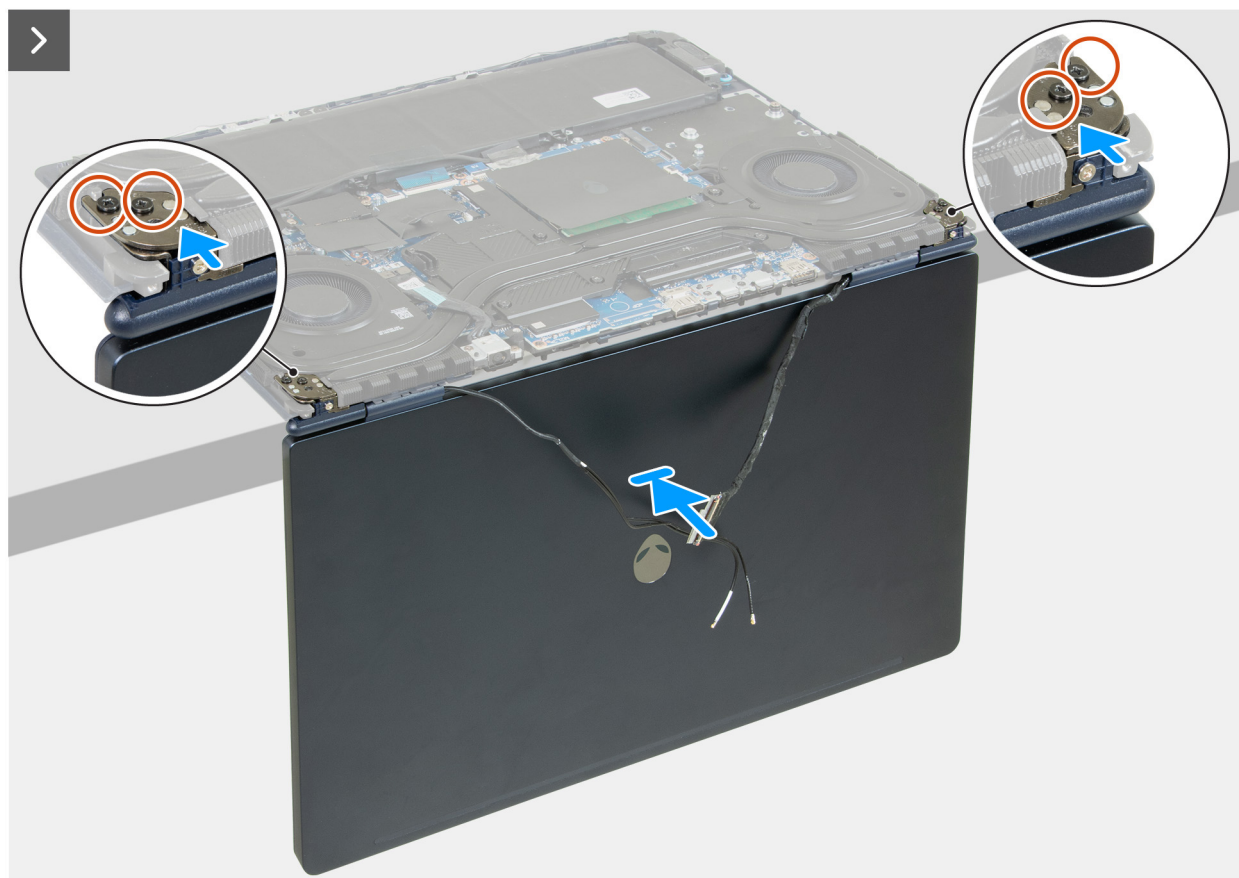
Rysunek 68. Instalowanie zestawu wyświetlacza
