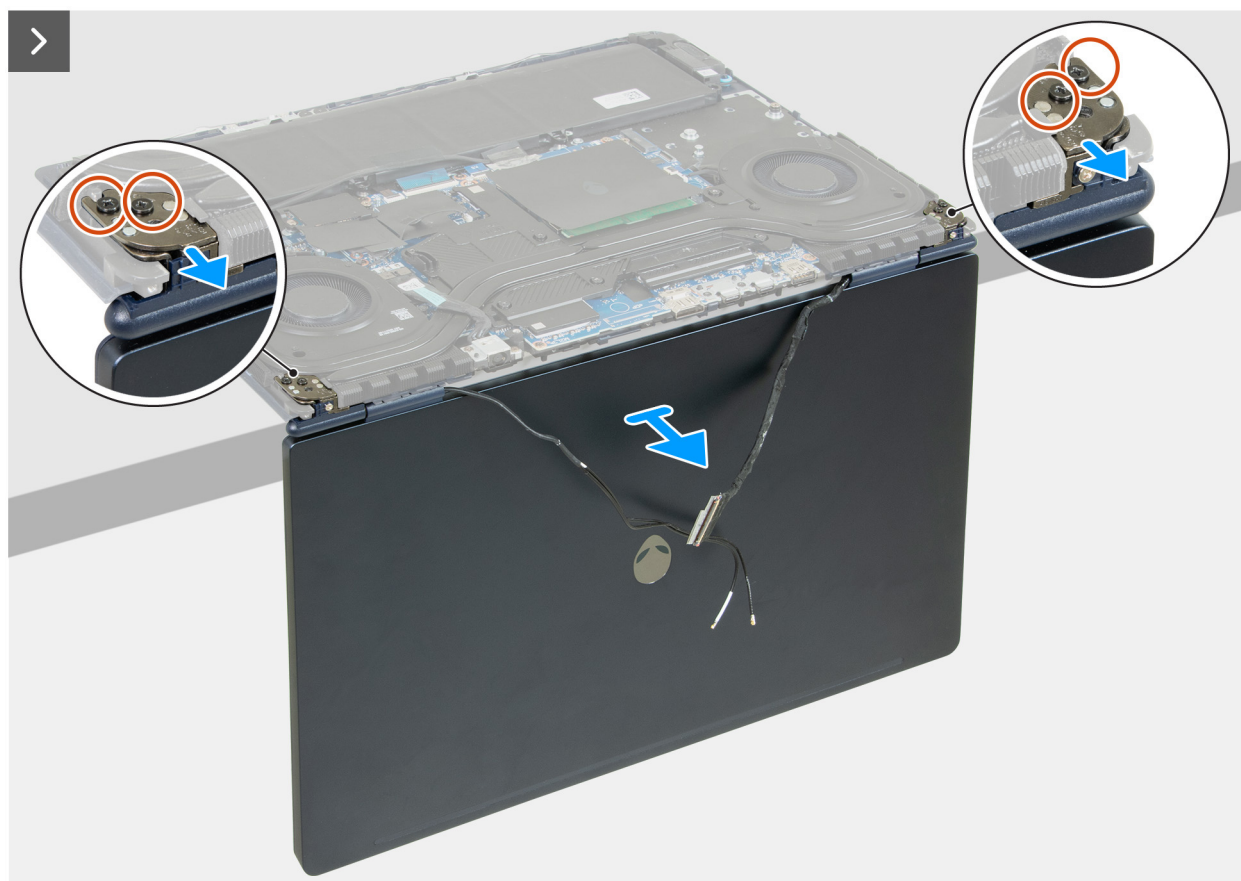
Rysunek 66. Wymontowywanie zestawu wyświetlacza
