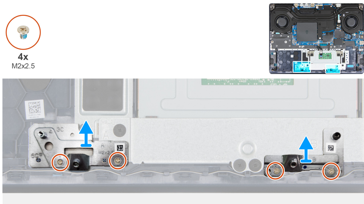
Rysunek 42. Wymontowywanie klamer baterii 3-ogniowej
