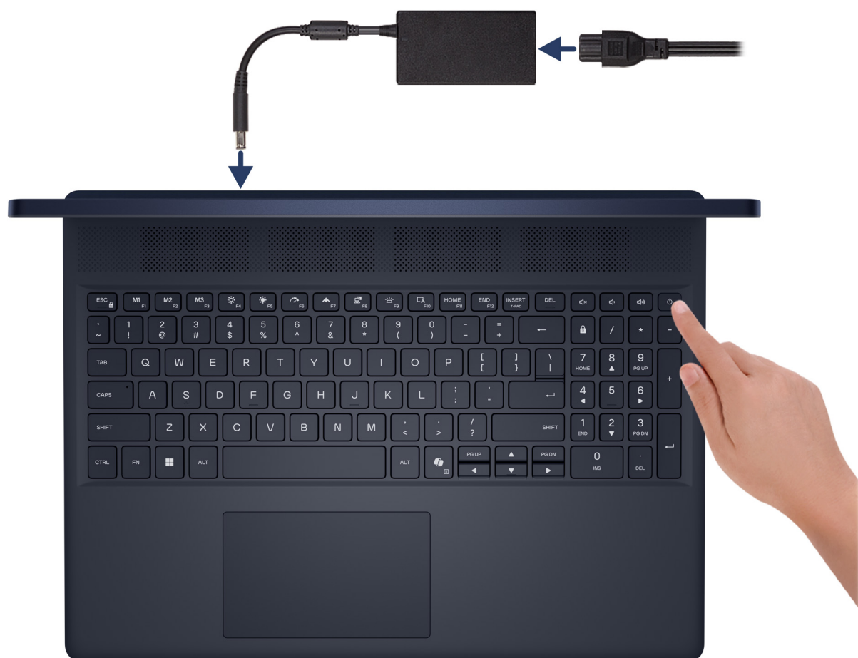
Rysunek 8. Podłącz zasilacz i naciśnij przycisk zasilania
