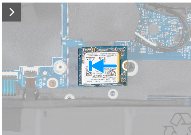
Rysunek 29. Instalacja dysku SSD M.2 2230 w gnieździe SSD1
