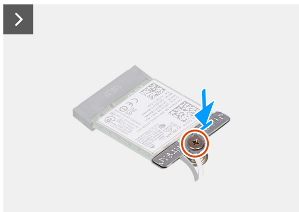
Rysunek 33. Instalowanie karty sieci bezprzewodowej
