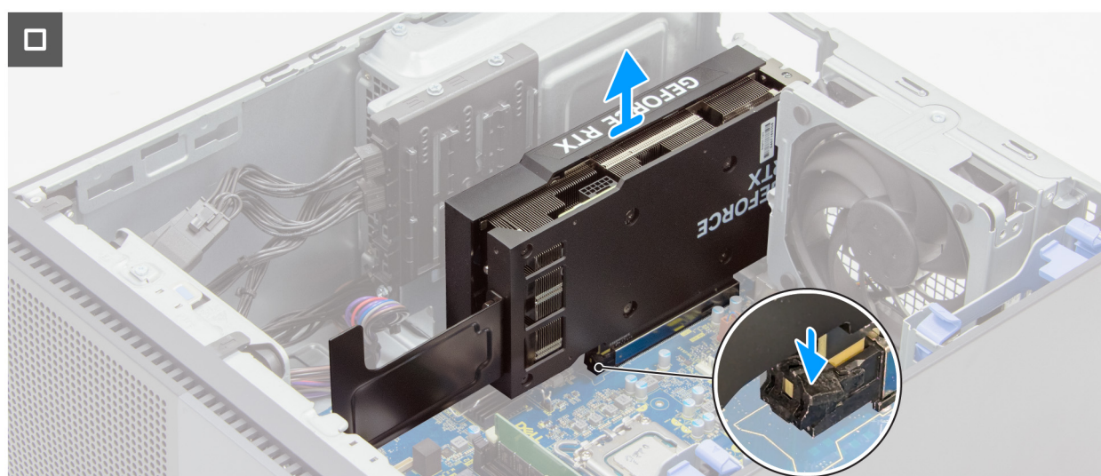
Rysunek 27. Wymontowywanie karty graficznej
