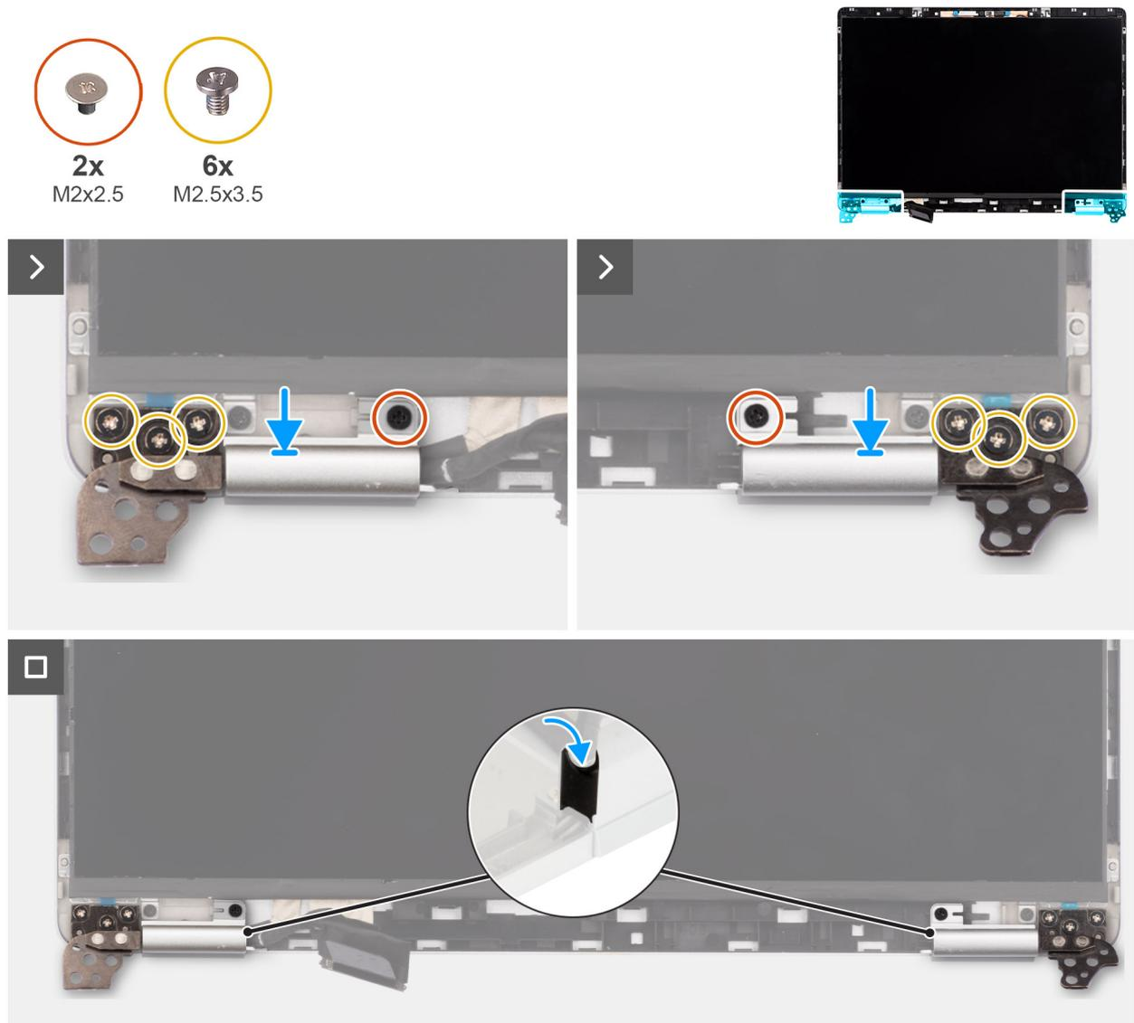
Abbildung 50. Einbauen der Bildschirmscharniere
