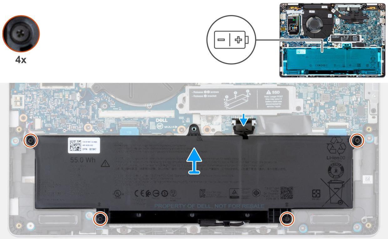
Abbildung 10. Einsetzen des Akkus
