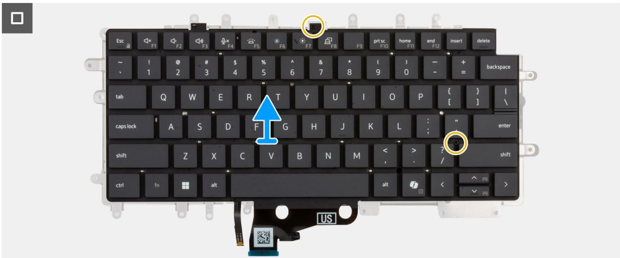
Abbildung 41. Entfernen der Tastatur
