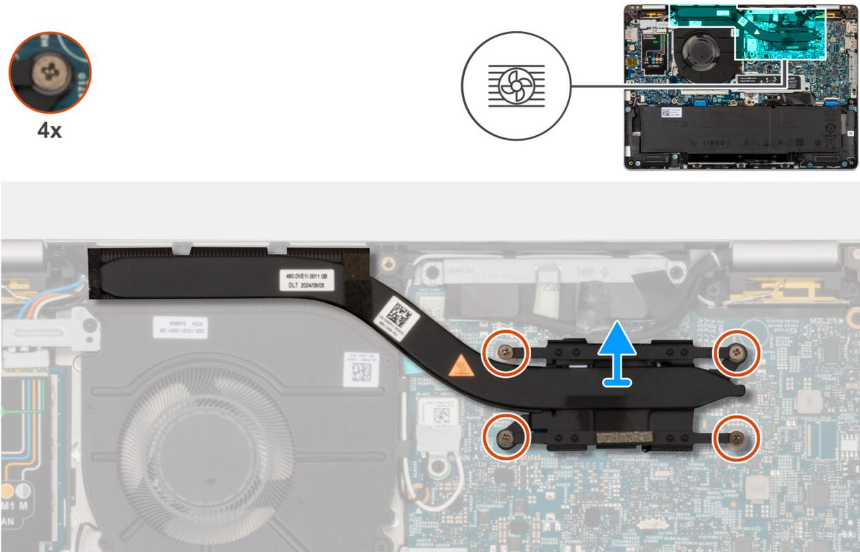
Abbildung 30. Kühlkörper entfernen
