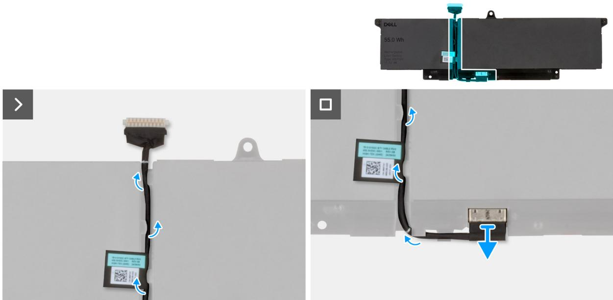
5. Trennen Sie das Akkukabel vom Anschluss am Akku.
