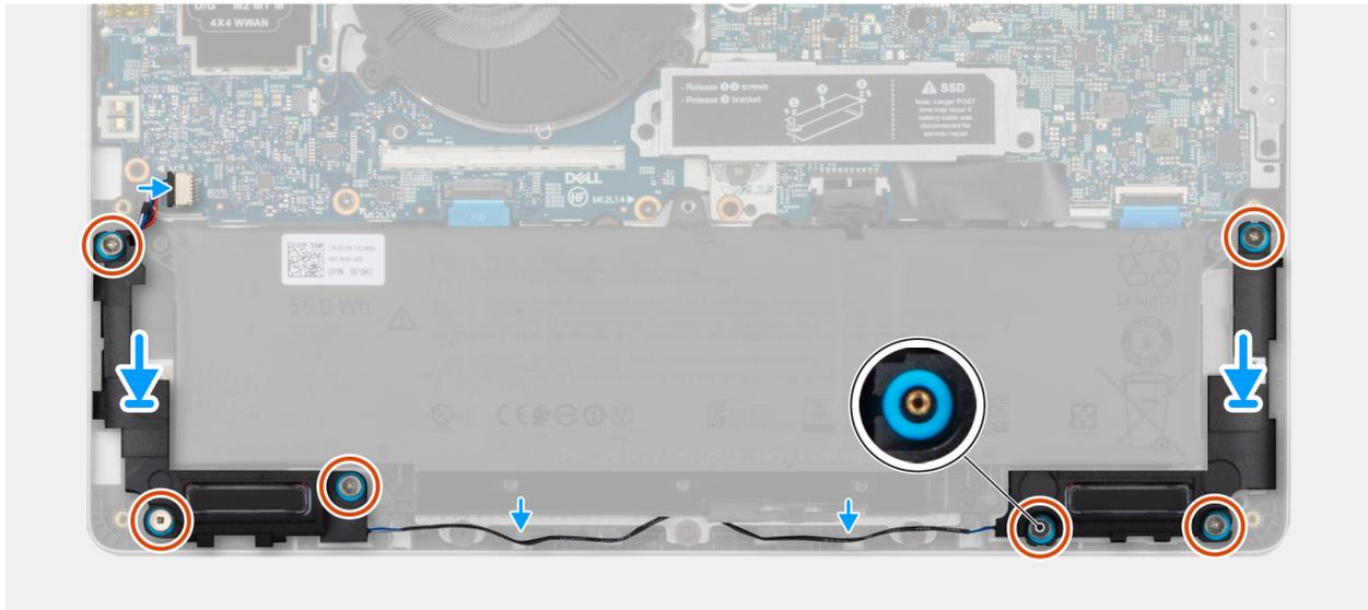
**Abbildung 18. Installieren der Lautsprecher**
