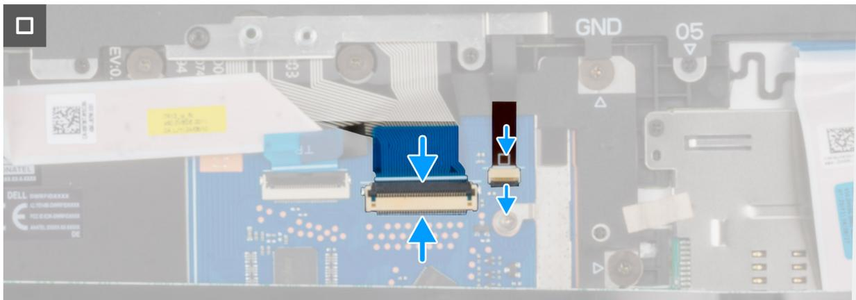
Abbildung 42. Einbauen der Tastatur
