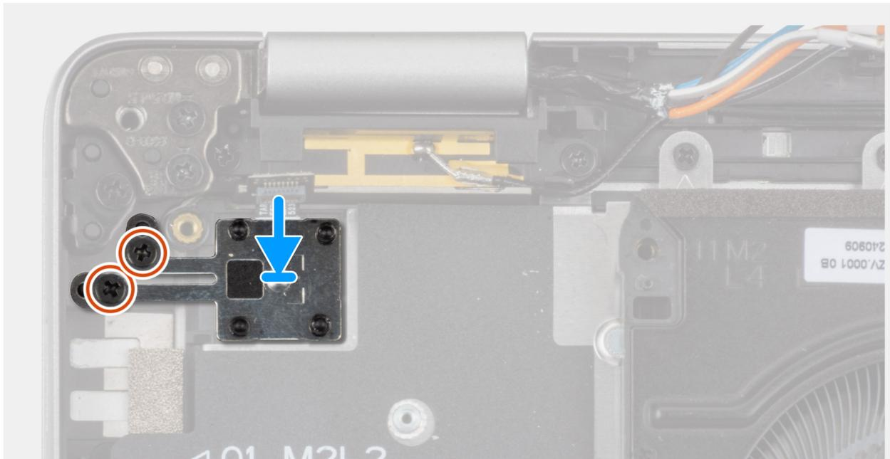
Abbildung 39. Installieren des Netzschalters mit optionalem Fingerabdruck-Lesegerät
