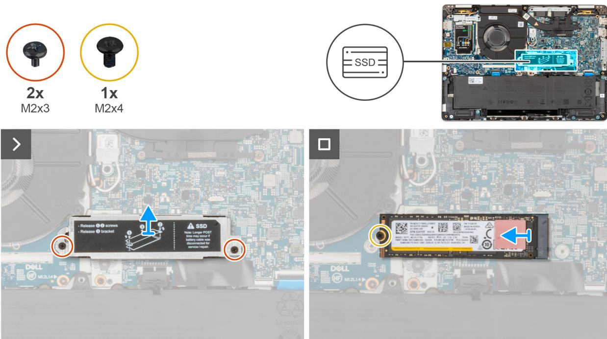
Abbildung 15. Entfernen der M.2-2280-SSD
