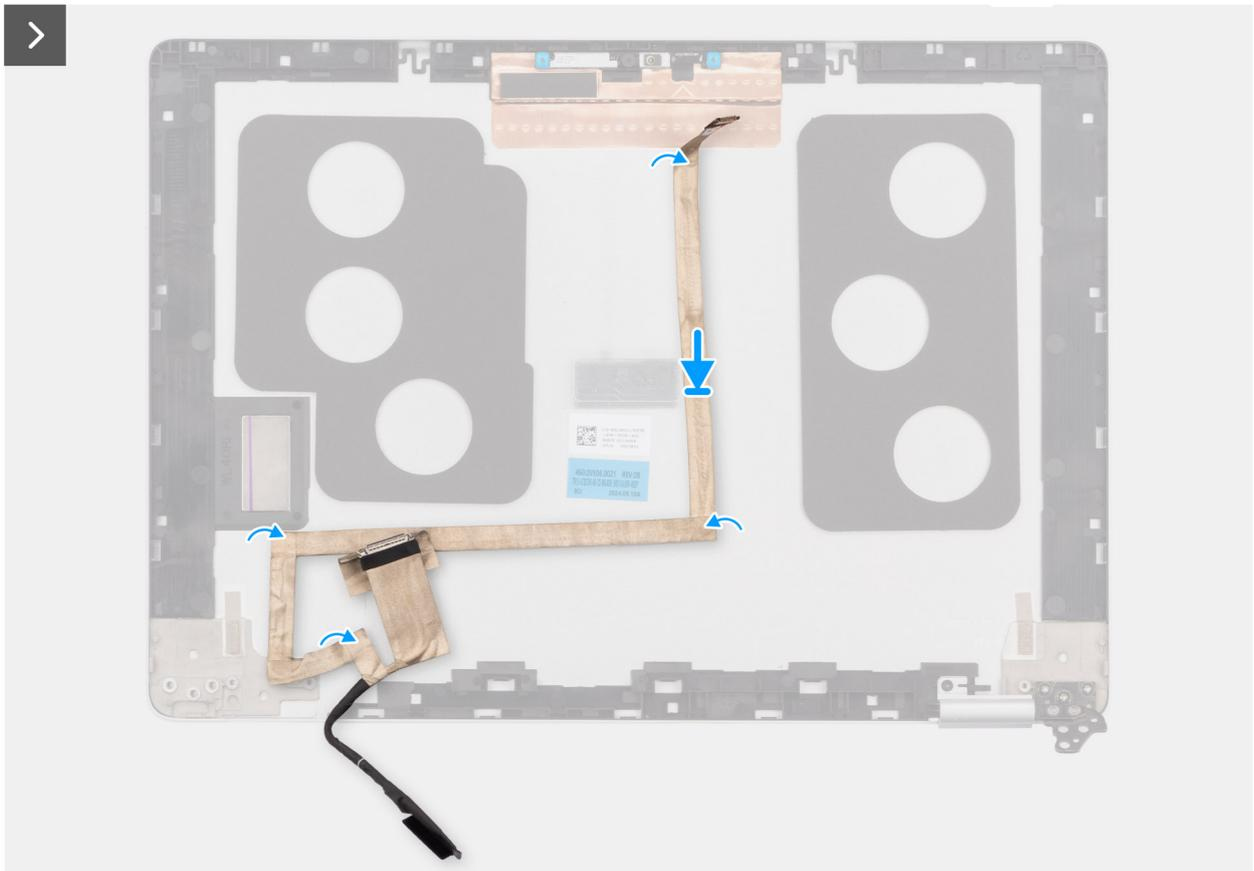
Abbildung 57. Entfernen des Bildschirmkabels
