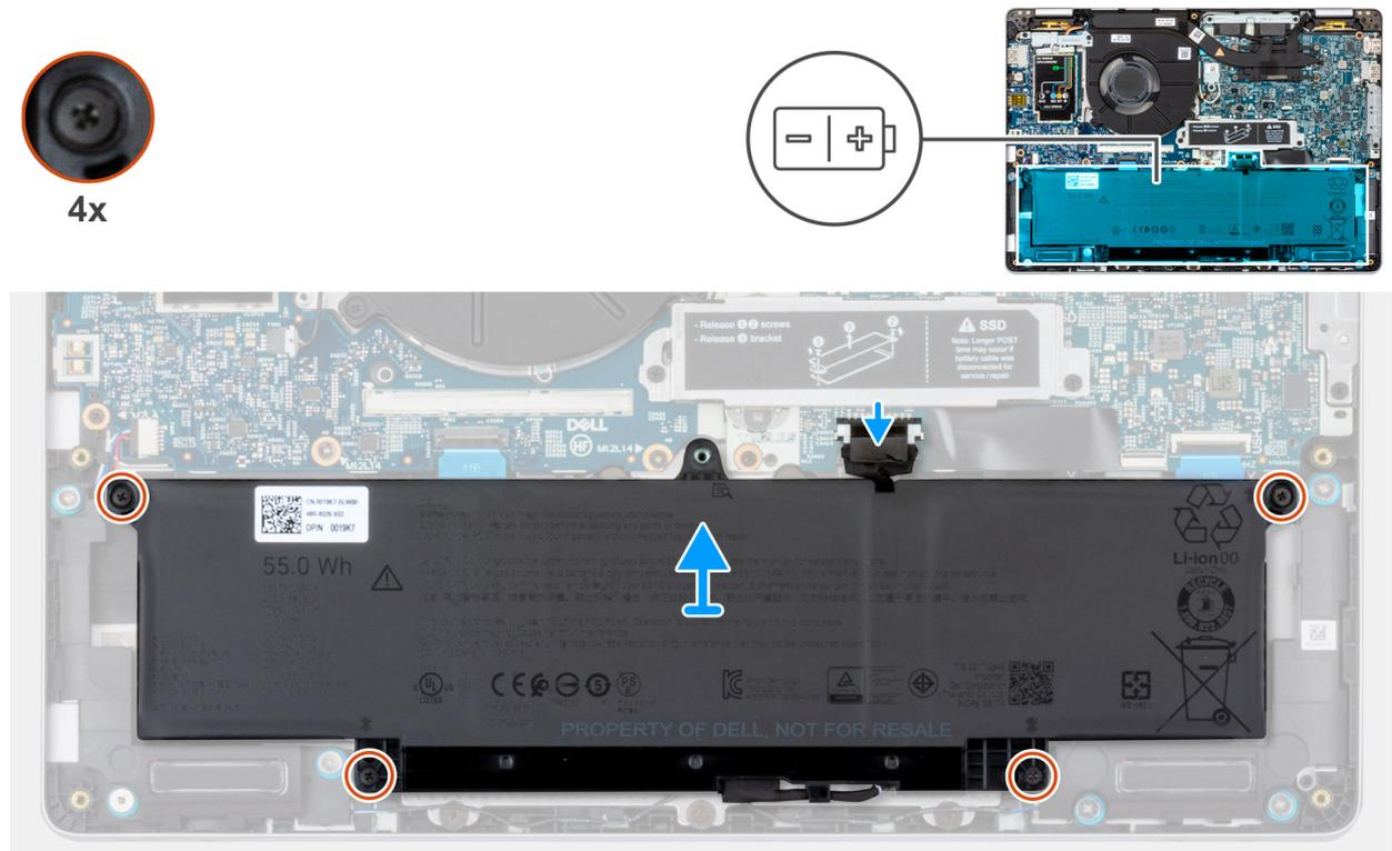
**Abbildung 8. Entfernen des Akkus**
