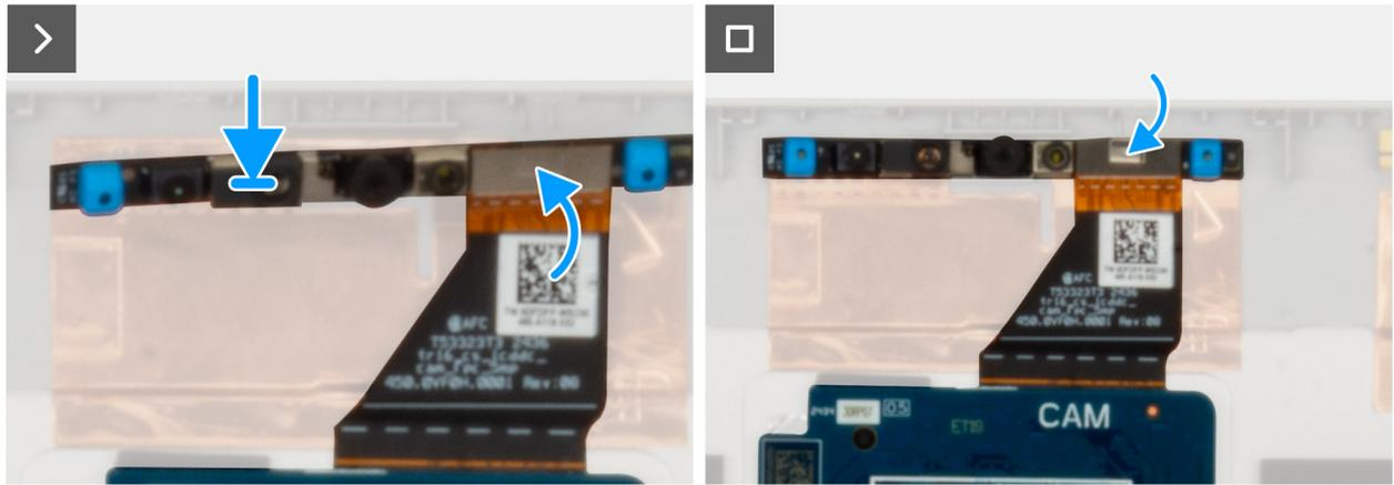
Abbildung 56. Installieren des Kameramoduls
