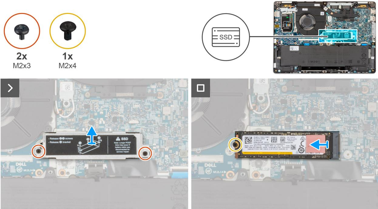
Abbildung 28. Entfernen der M.2-2280-SSD
