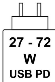
Abbildung 2. Piktogramm für die Anforderungen an die Stromversorgung
