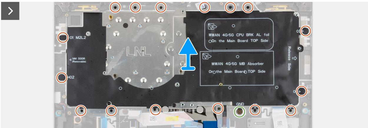
Abbildung 40. Entfernen der Tastatur
