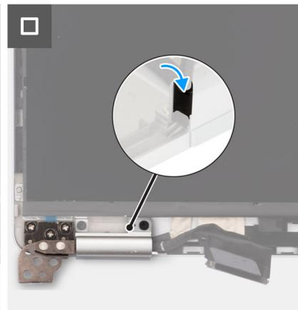
Abbildung 58. Einbauen des Bildschirmkabels
