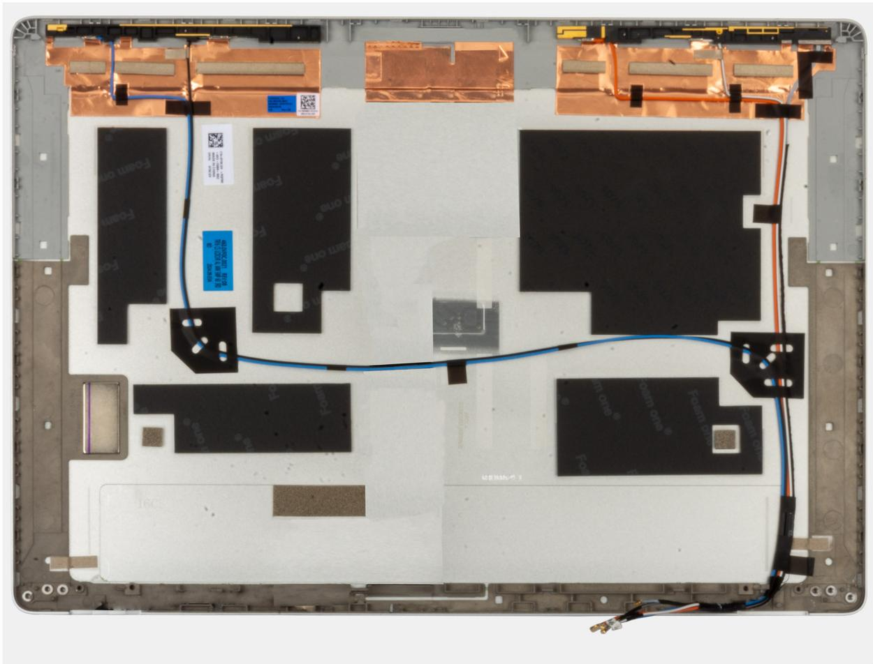
**Abbildung 60. Einbauen der hinteren Bildschirmabdeckung**
