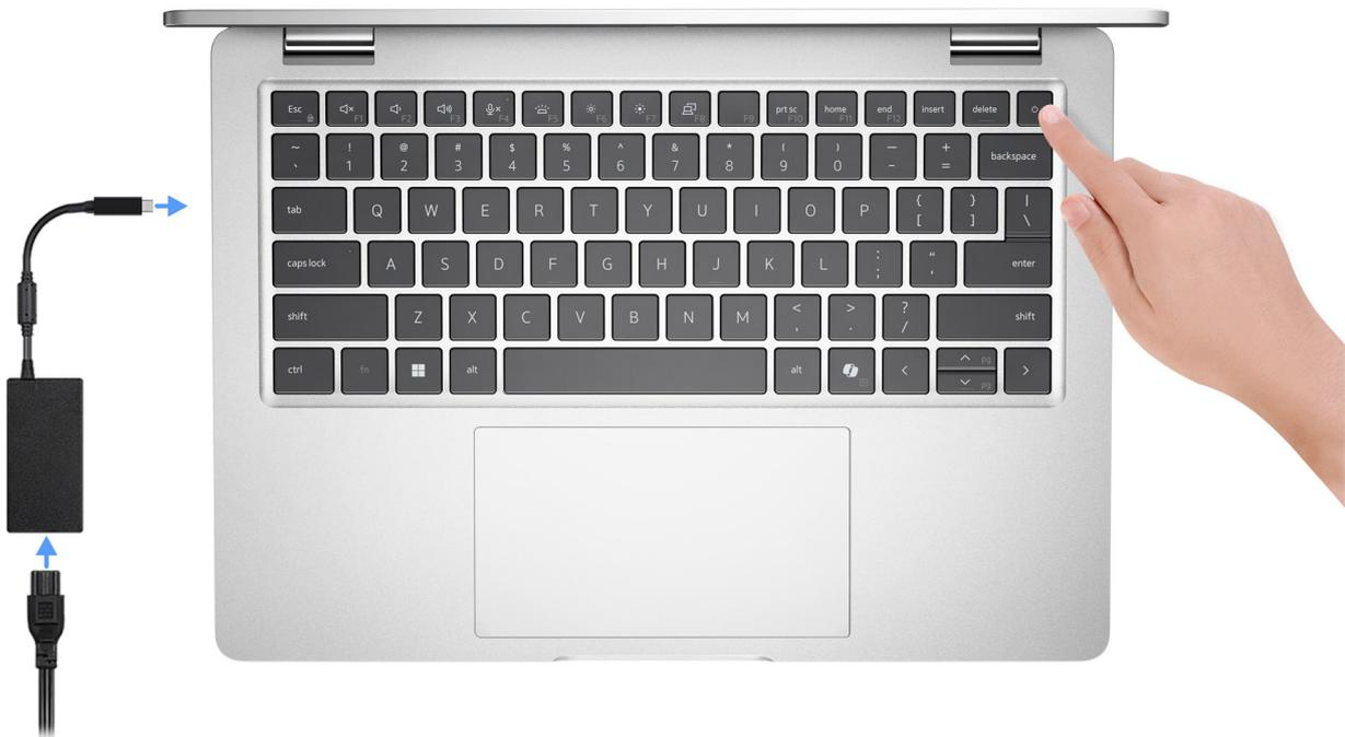
**ANMERKUNG:** Der Akku kann während des Versands in den Energiesparmodus wechseln, um den Akku nicht zu entladen. Stellen Sie sicher, dass der Netzadapter an den Computer angeschlossen ist, wenn er zum ersten Mal eingeschaltet wird.
