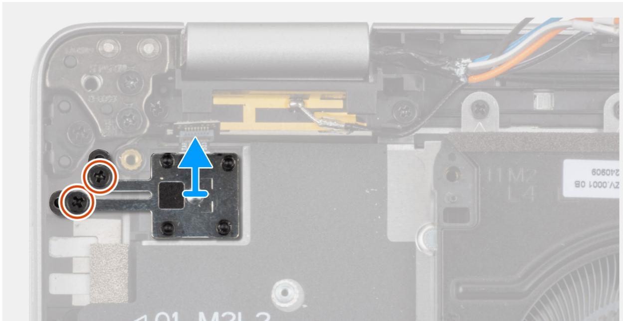
Abbildung 38. Entfernen des Netzschalters mit optionalem Fingerabdruck-Lesegerät
