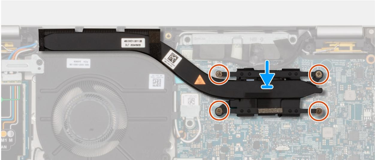
Abbildung 31. Installieren des Kühlkörpers (integrierte GPU)
