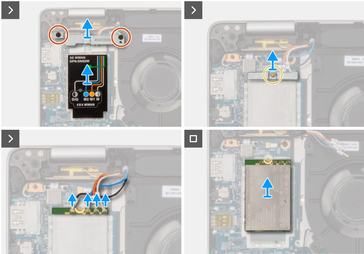
Abbildung 11. Entfernen der 5G-WWAN-Karte
