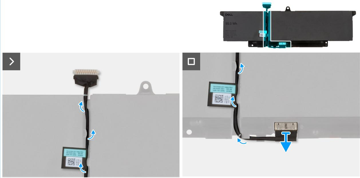
4. Trennen Sie das Akkukabel vom Akkukabel-Anschluss (BATT1) auf der Hauptplatine.
