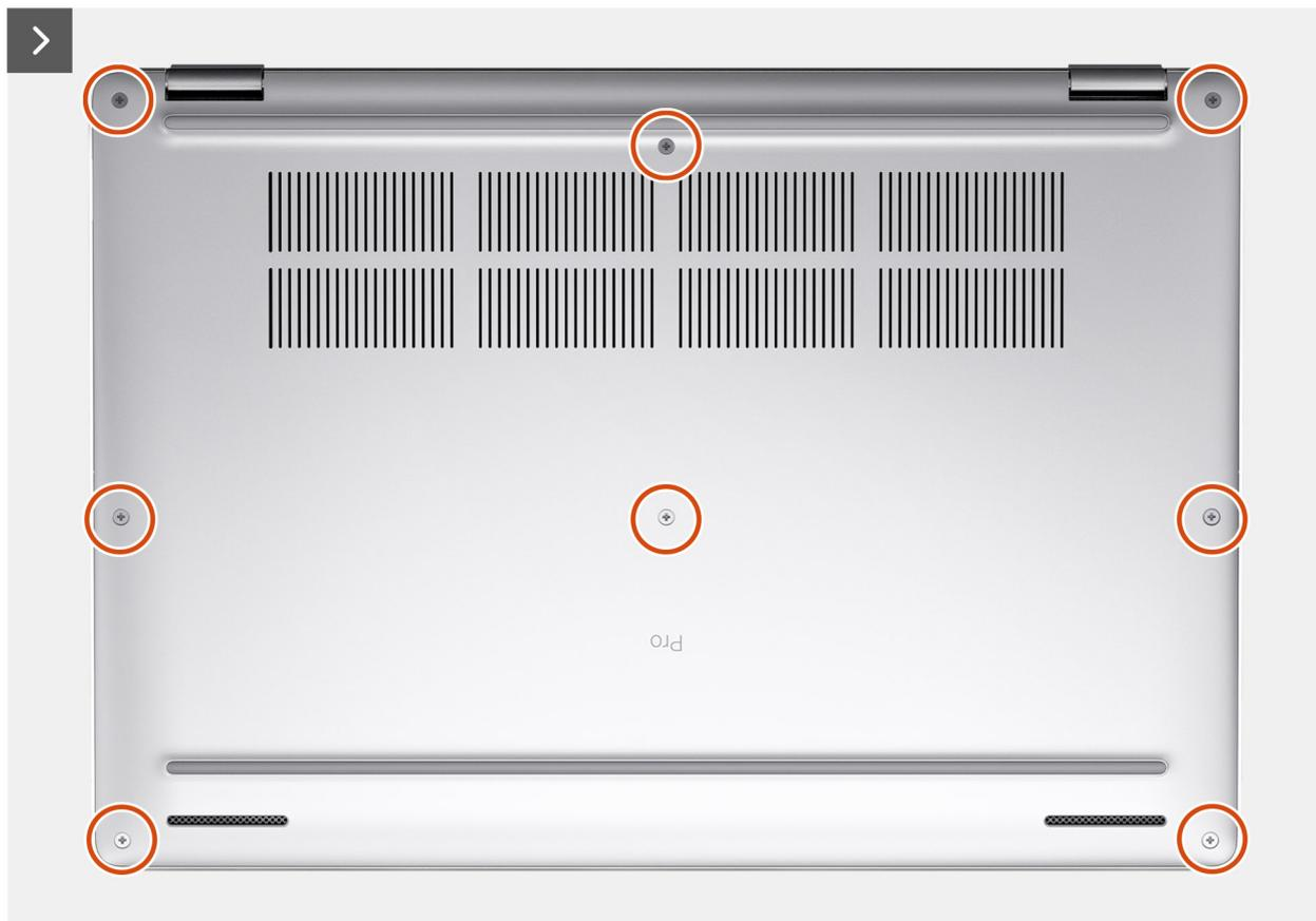
**Abbildung 6. Entfernen der Bodenabdeckung**
